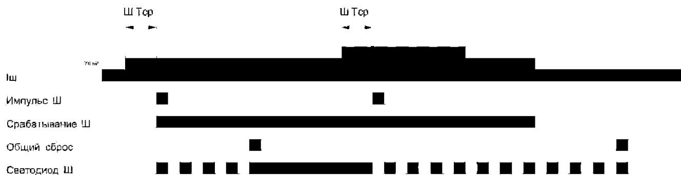
Рисунок 1.6 – Временная диаграмма работы входа импульсной сигнализации
