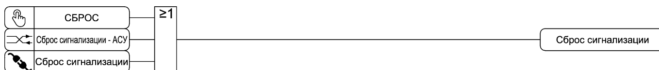
Рисунок 3.9 – Функциональная схема алгоритма сброса сигнализации
