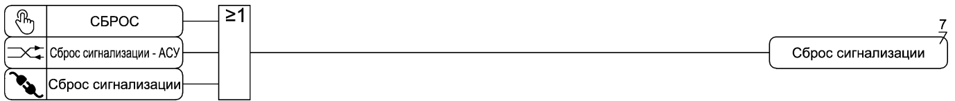
Рисунок А.8 – Функциональная схема алгоритма сброса сигнализации
