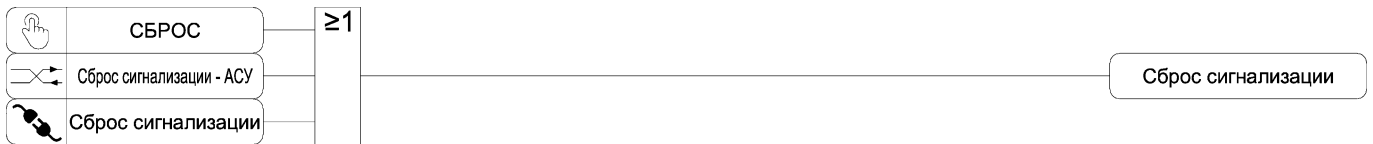
Рисунок 3.42 – Функциональная схема алгоритма сброса сигнализации
