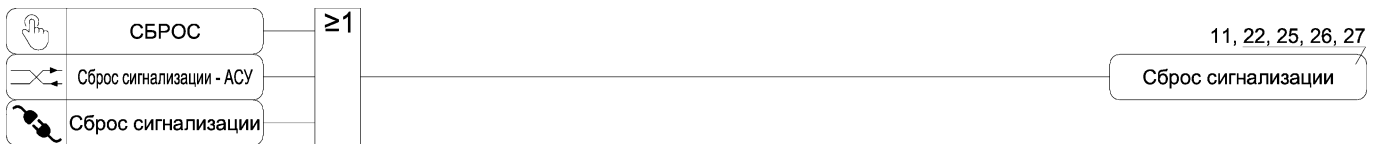
Рисунок А.28 – Функциональная схема алгоритма сброса сигнализации
