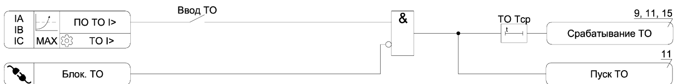
Рисунок А.1 – Функциональная схема алгоритма ТО
