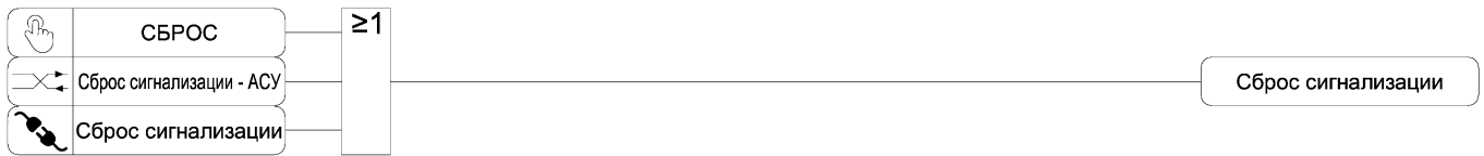
Рисунок 3.16 – Функциональная схема алгоритма сброса сигнализации
