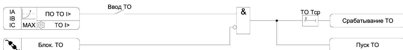
Рисунок 3.1 – Функциональная схема алгоритма ТО
