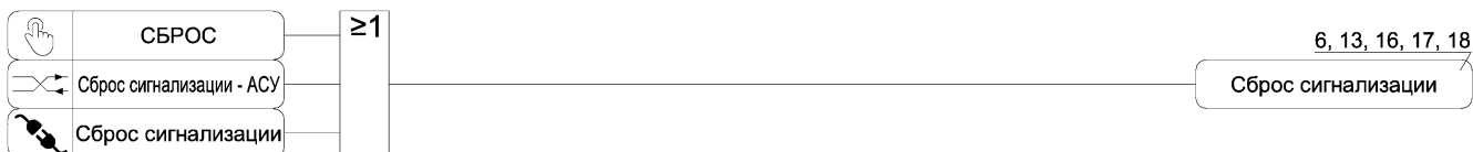
Рисунок А.19 – Функциональная схема алгоритма сброса сигнализации
