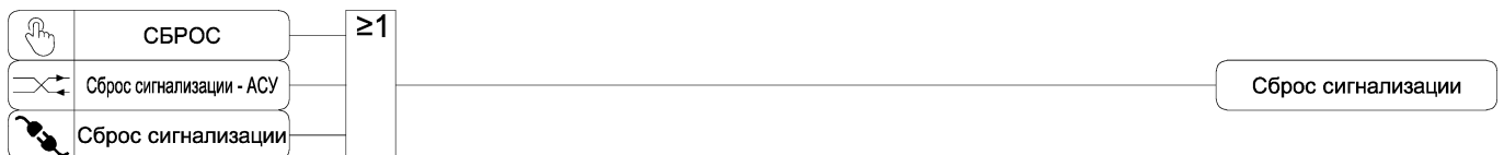
Рисунок 3.46 – Функциональная схема алгоритма сброса сигнализации
