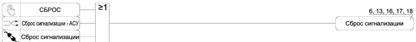
Рисунок А.19 – Функциональная схема алгоритма сброса сигнализации
