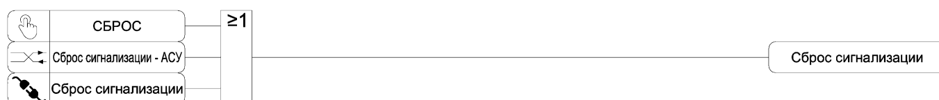
Рисунок 3.20 – Функциональная схема алгоритма сброса сигнализации
