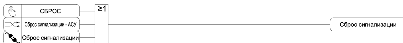
Рисунок 3.47 – Функциональная схема алгоритма сброса сигнализации
