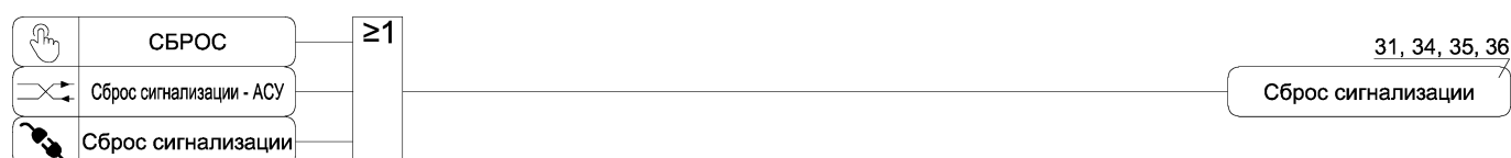
Рисунок А.37 – Функциональная схема алгоритма сброса сигнализации
