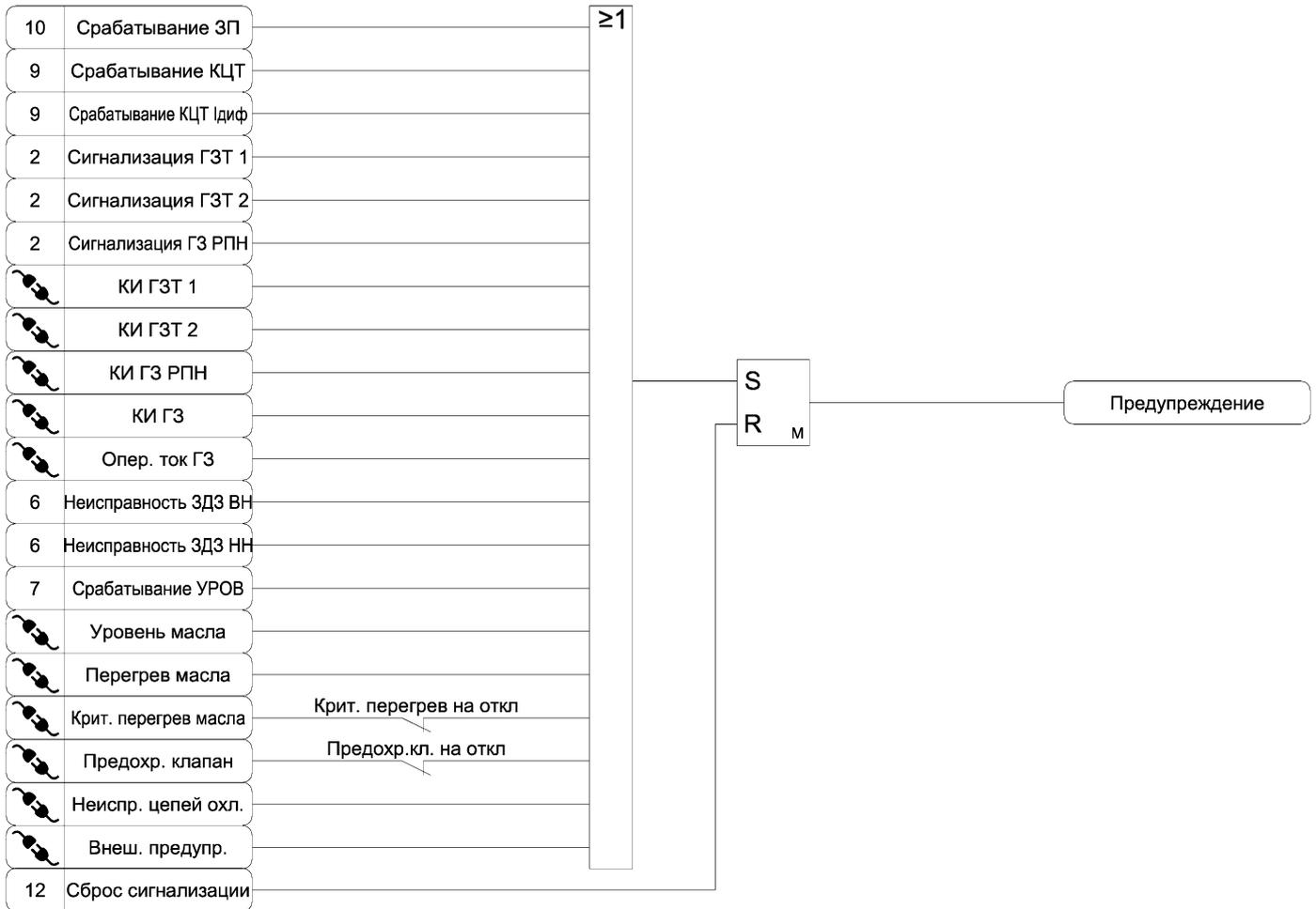
Рисунок А.11 б) – Функциональная схема алгоритма сигнализации
