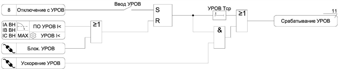
Рисунок А.7 – Функциональная схема алгоритма УРОВ
