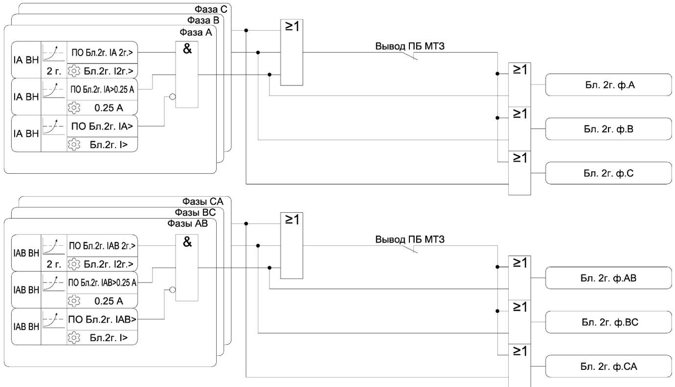
Рисунок 3.6 – Функциональная схема алгоритма МТЗ/У
