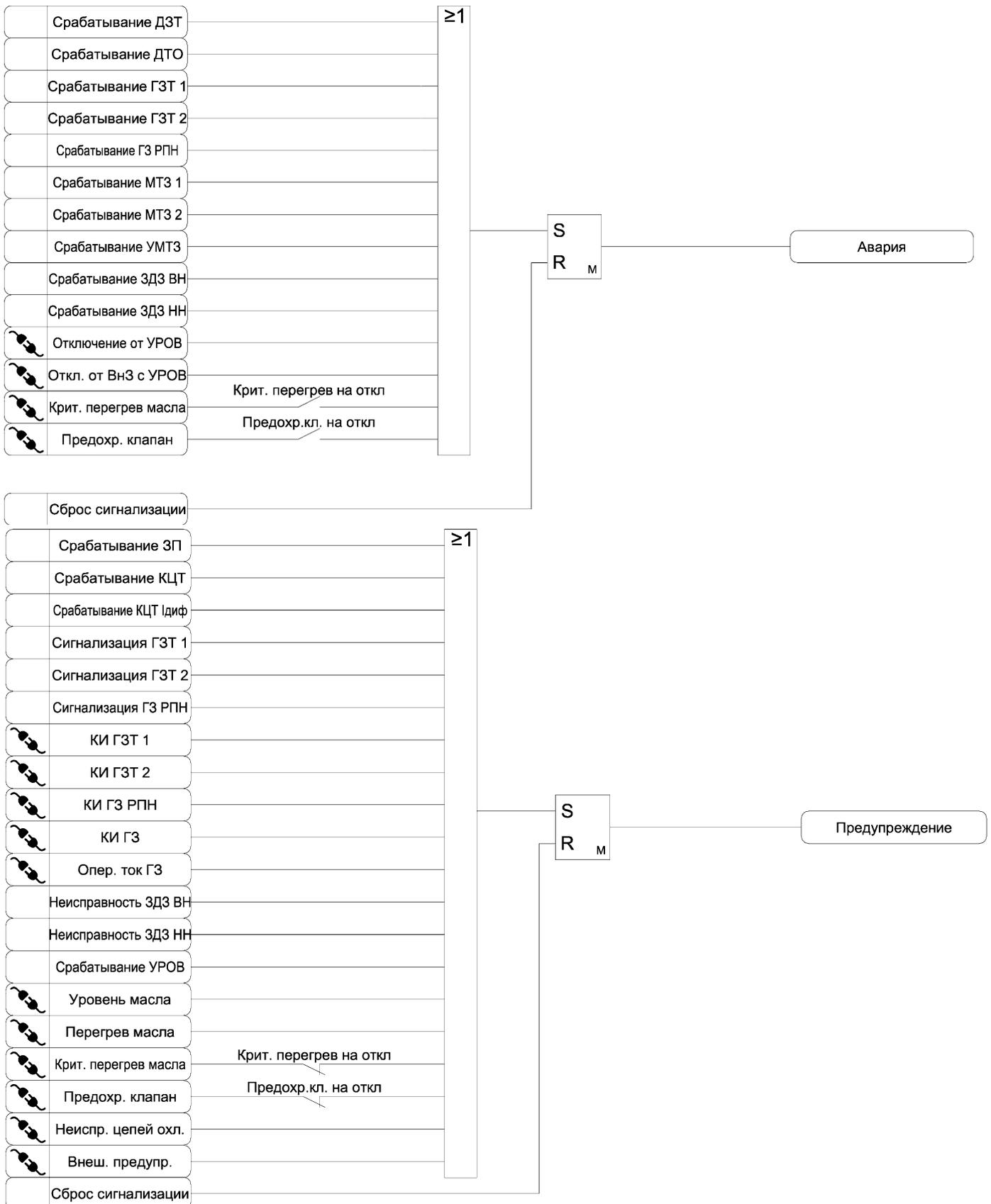
Рисунок 3.12 – Функциональная схема алгоритма сигнализации
