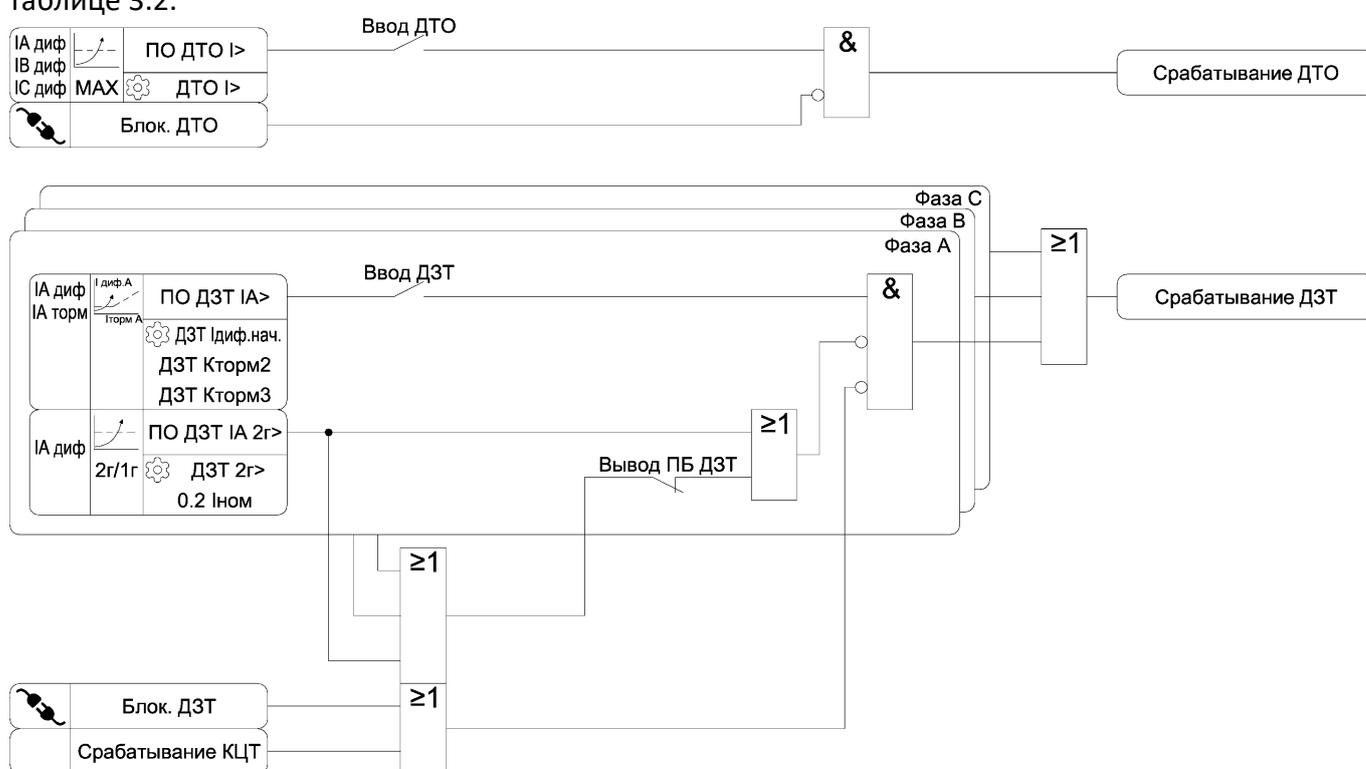
Рисунок 3.1 – Функциональная схема алгоритма ДЗТ и ДТО
