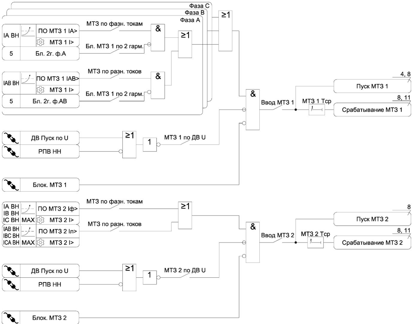
Рисунок А.3 – Функциональная схема алгоритма МТЗ
