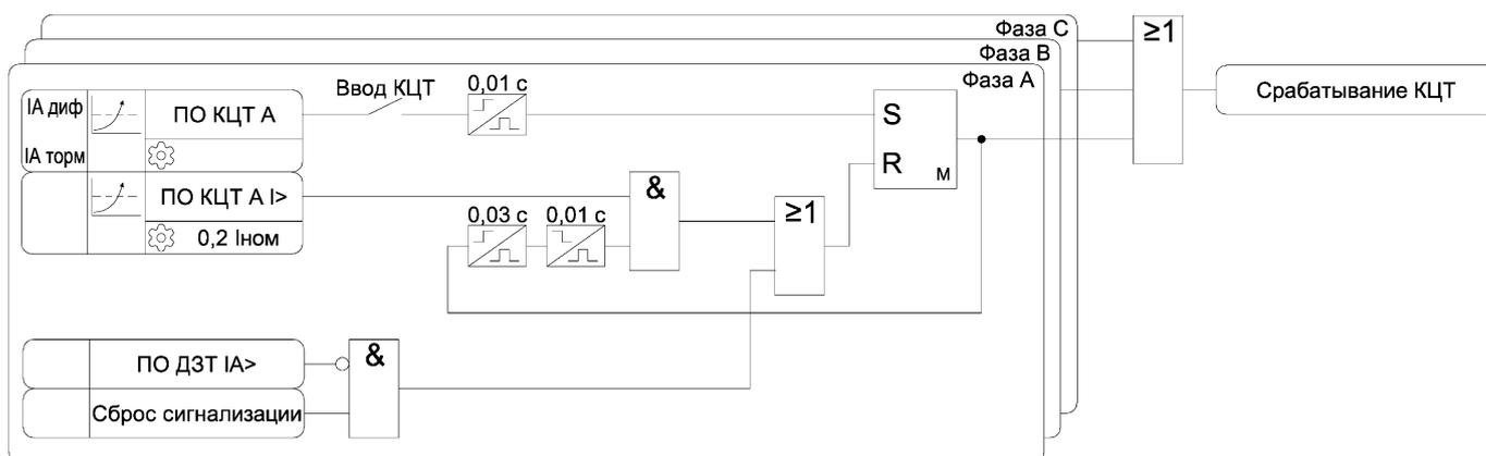
Рисунок 3.10 а) – Функциональная схема алгоритма КЦТ
