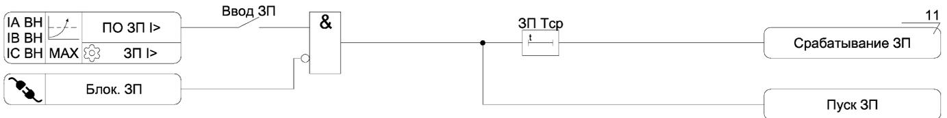
Рисунок А.10 – Функциональная схема алгоритма защиты от перегрузки
