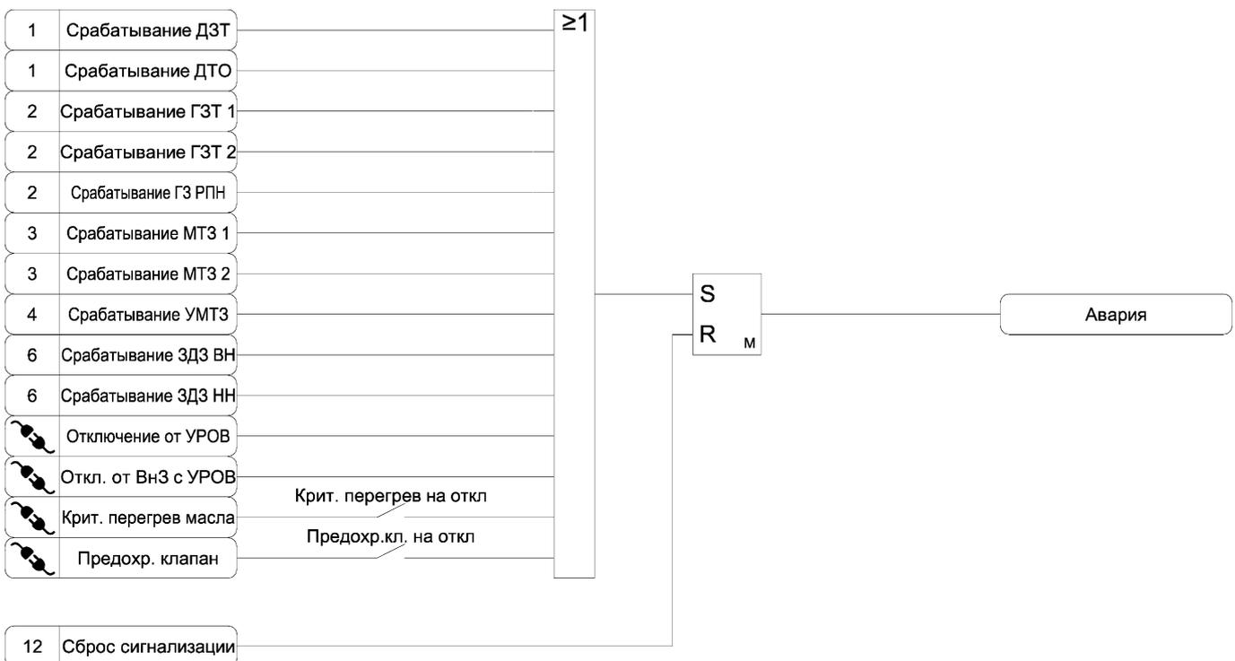
Рисунок А.11 а) – Функциональная схема алгоритма сигнализации
