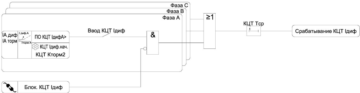
Рисунок 3.10 б) – Функциональная схема алгоритма КЦТ
