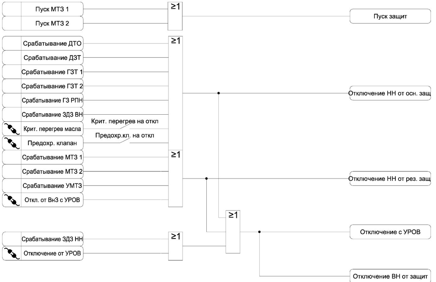
Рисунок 3.9 – Функциональная схема алгоритма формирования сигналов состояния защит
