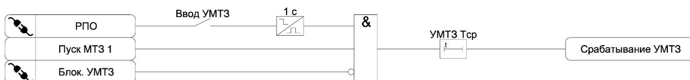
Рисунок 3.5 – Функциональная схема алгоритма УМТЗ
