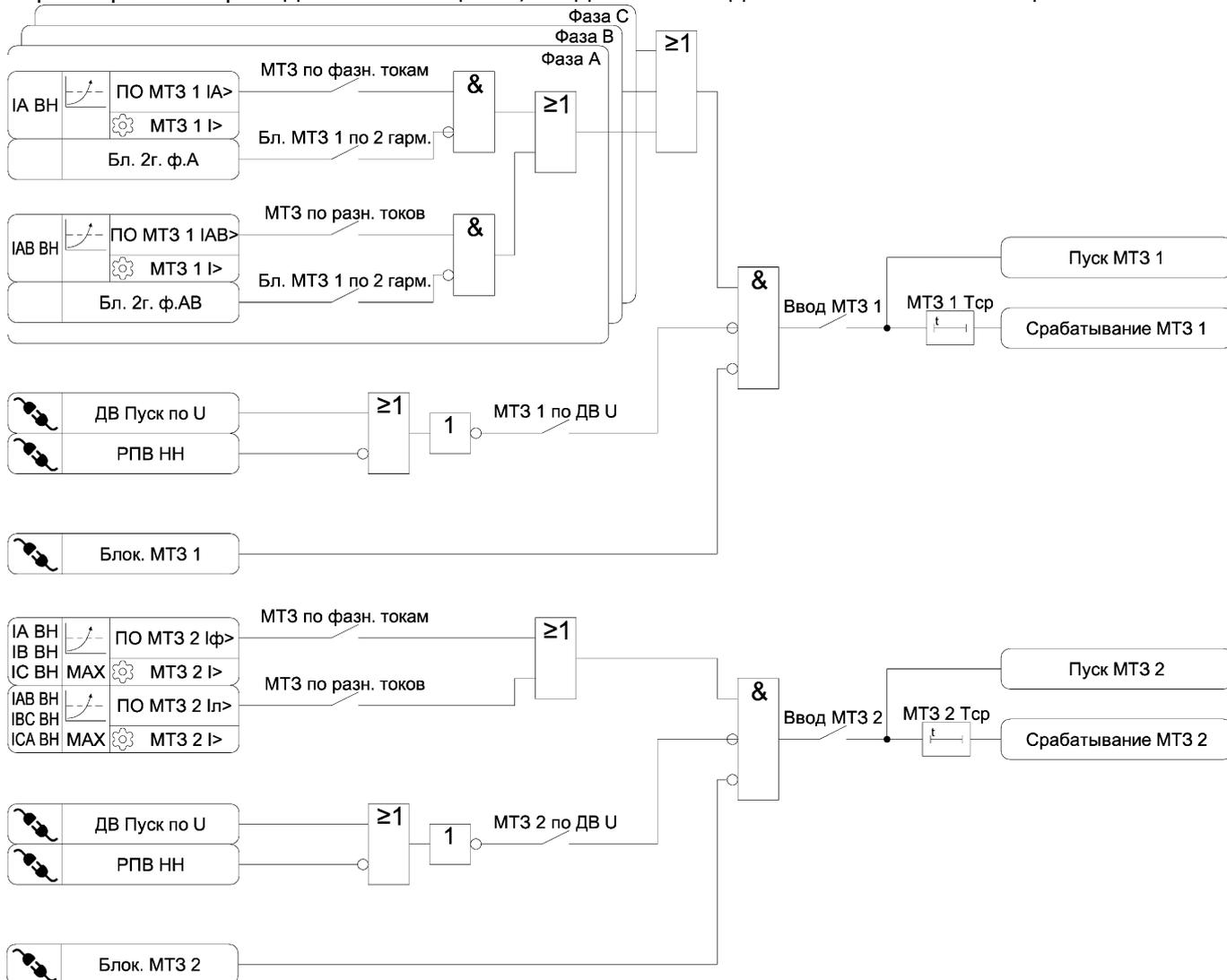
Рисунок 3.4 – Функциональная схема алгоритма МТЗ
