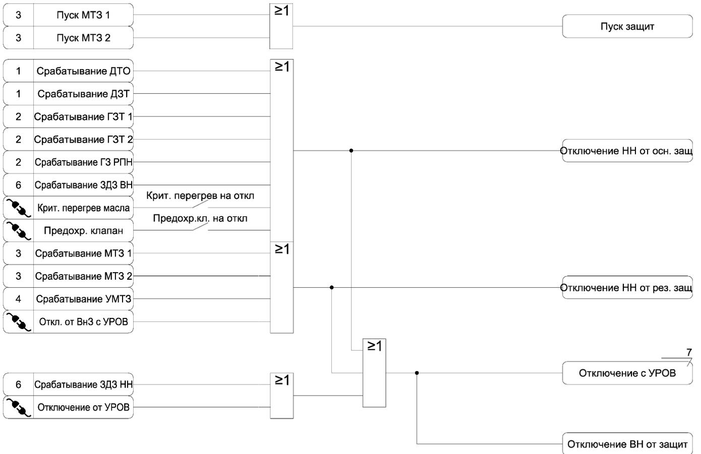
Рисунок А.8 – Функциональная схема алгоритма состояния защит
