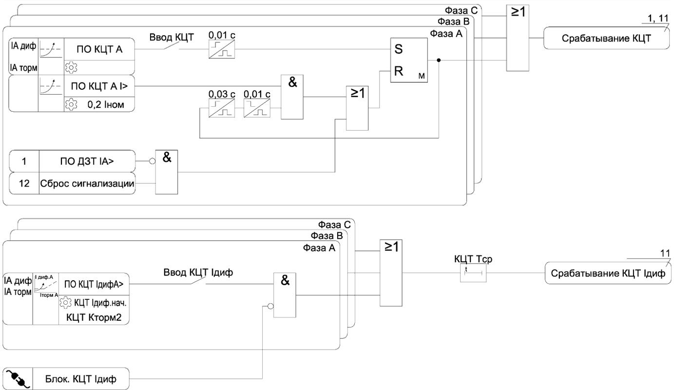
Рисунок А.9 – Функциональная схема алгоритма КЦТ
