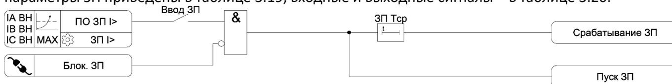
Рисунок 3.11 – Функциональная схема алгоритма ЗП
