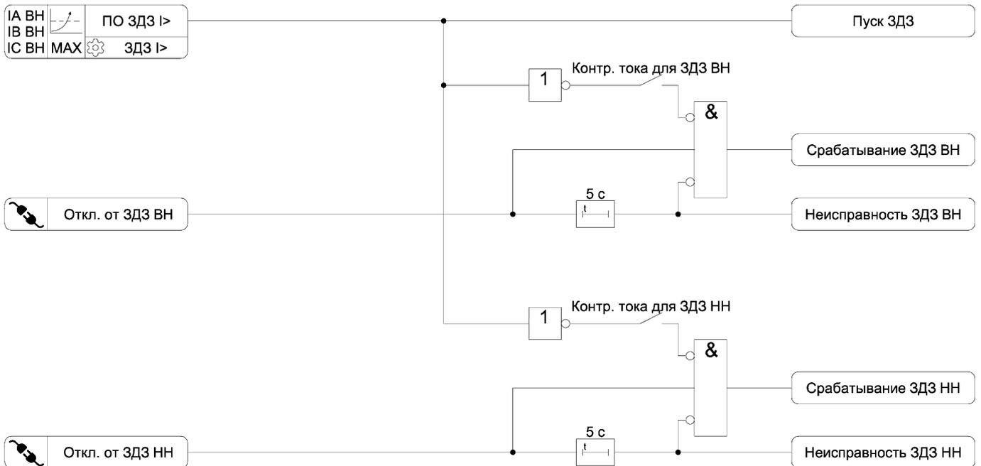
Рисунок 3.7 – Функциональная схема алгоритма ЗДЗ
