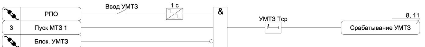
Рисунок А.4 – Функциональная схема алгоритма УМТЗ
