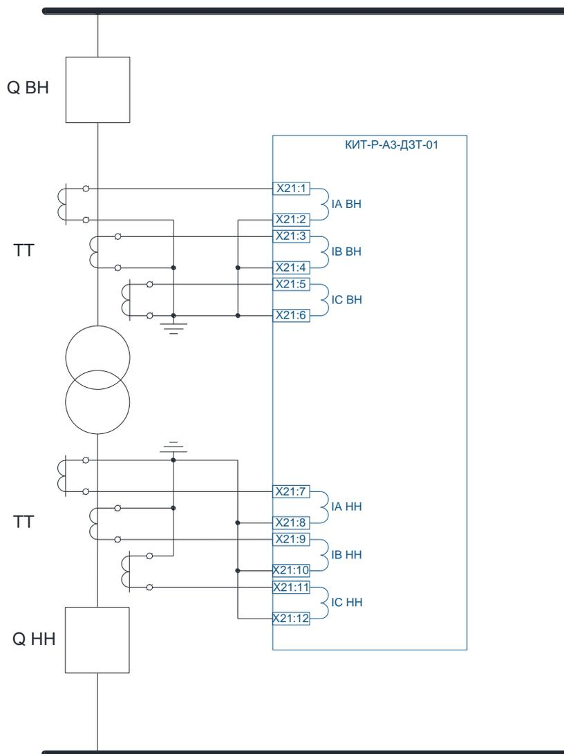
Рисунок 1.1 – Упрощенная схема подключения устройства
