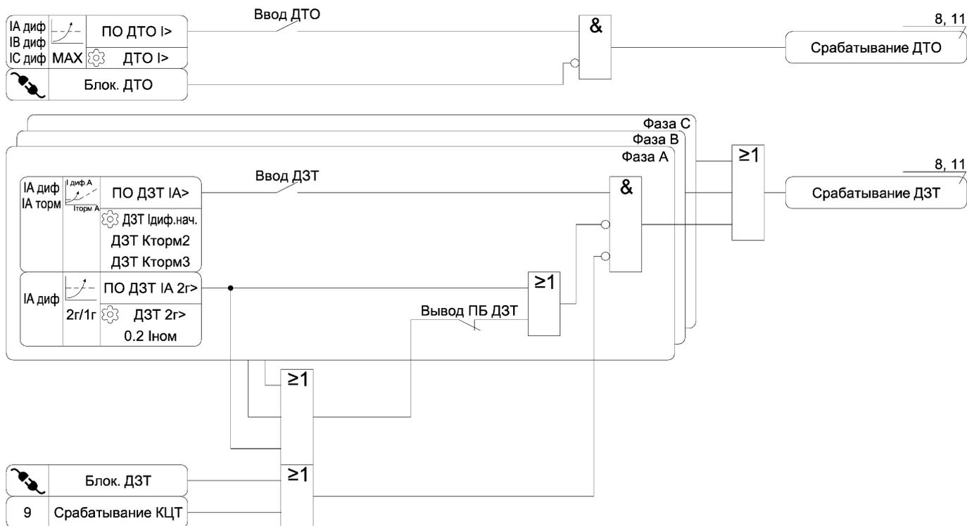
Рисунок А.1 – Функциональная схема алгоритмов ДЗТ и ДТО
