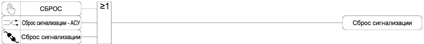
Рисунок 3.13 – Функциональная схема алгоритма сброса сигнализации
