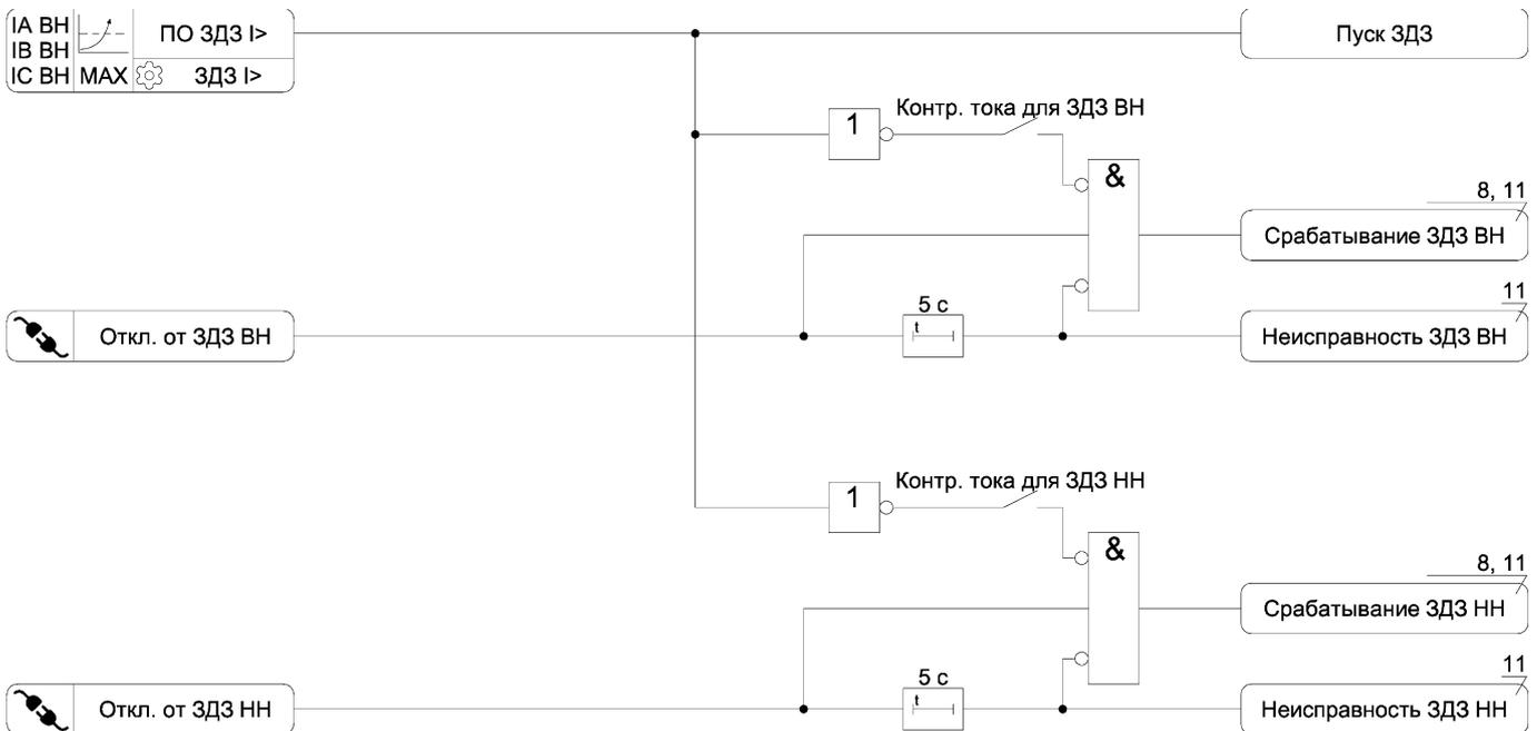
Рисунок А.6 – Функциональная схема алгоритма ЗДЗ
