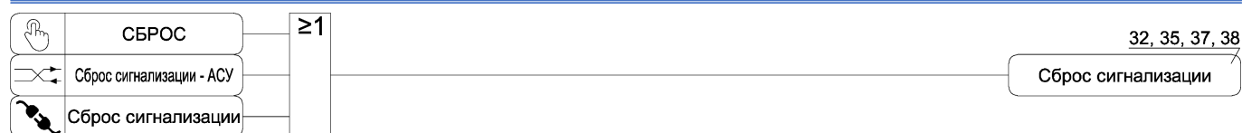
Рисунок А.39 – Функциональная схема алгоритма сброса сигнализации
