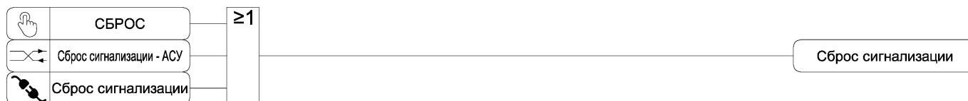
Рисунок 3.48 – Функциональная схема алгоритма сброса сигнализации
