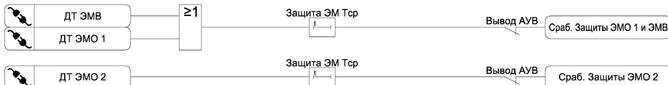
Рисунок 3.45 – Функциональная схема алгоритма защиты электромагнитов управления
