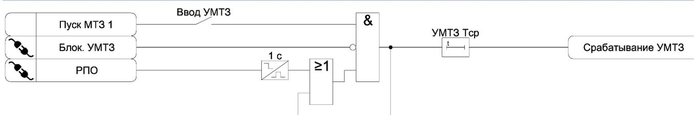
Рисунок 3.3 – Функциональная схема алгоритма УМТЗ
