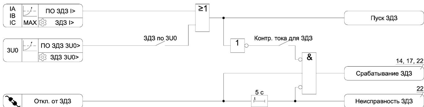
Рисунок А.8 – Функциональная схема алгоритма ЗДЗ
