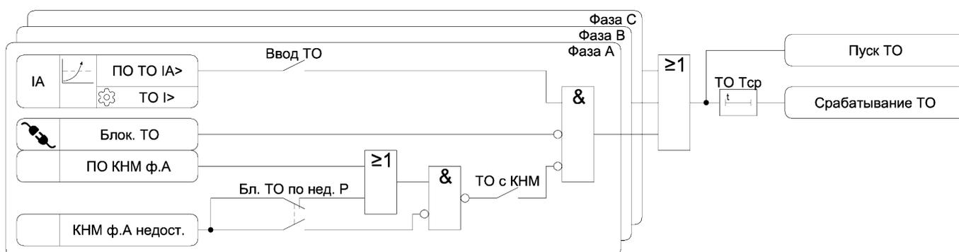
Рисунок 3.1 – Функциональная схема алгоритма ТО
