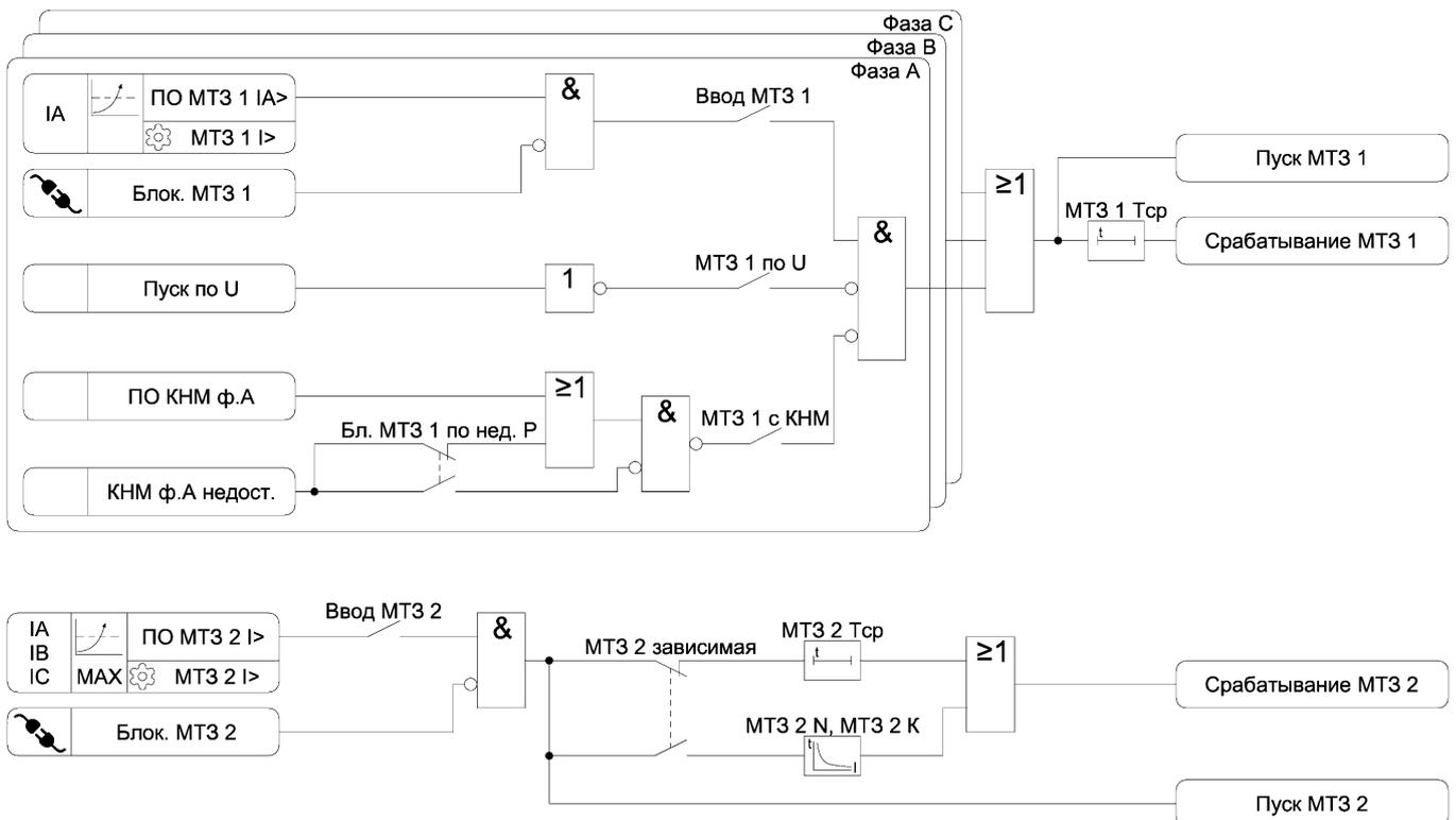
Рисунок 3.2 – Функциональная схема алгоритма МТЗ
