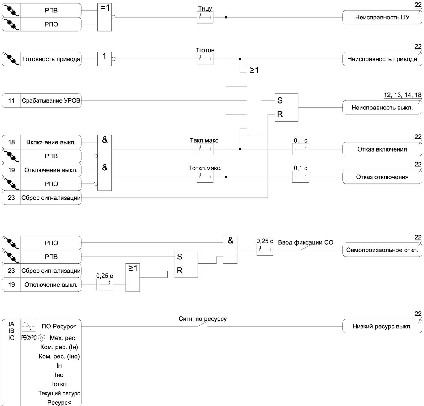
Рисунок А.20 – Функциональная схема алгоритма диагностики выключателя
