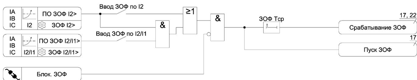
Рисунок А.10 – Функциональная схема алгоритма ZOФ
