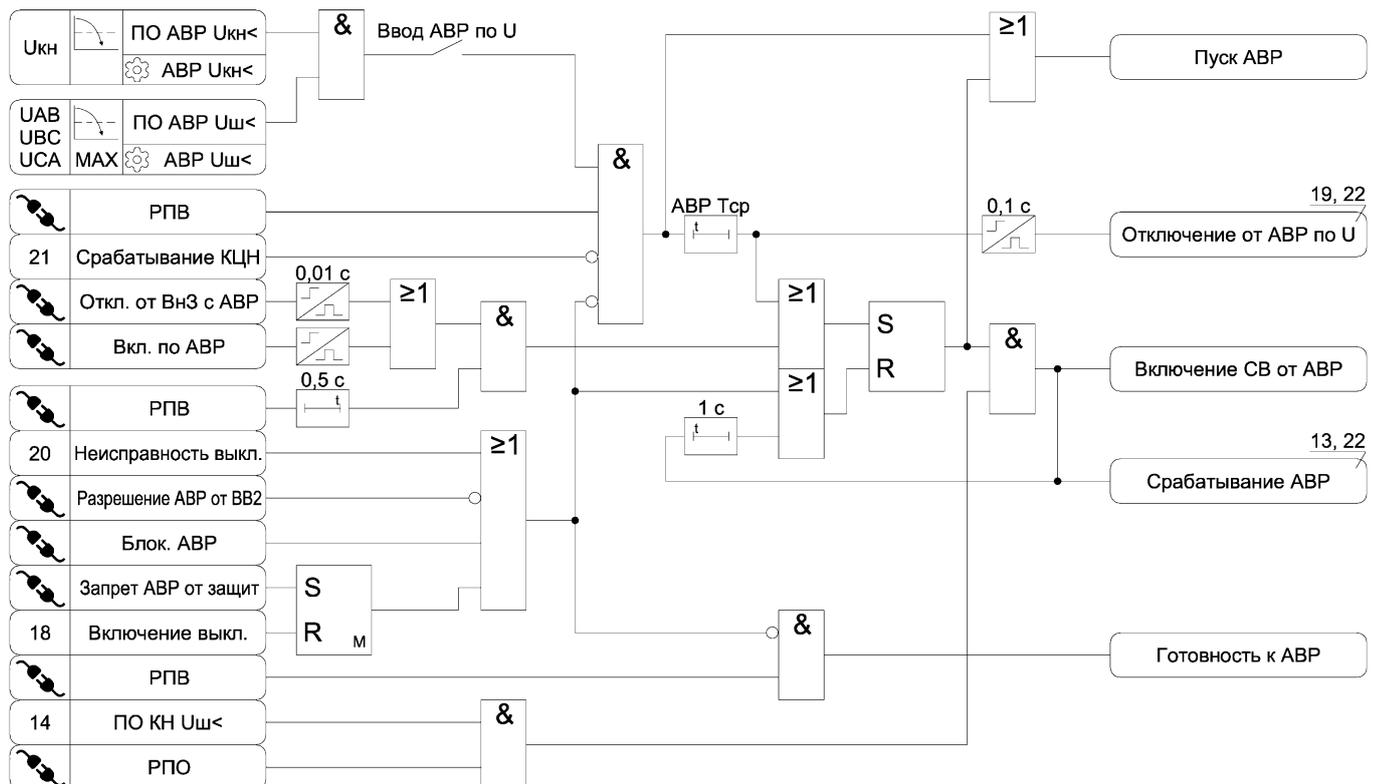
Рисунок 3.13 – Функциональная схема алгоритма АВР
