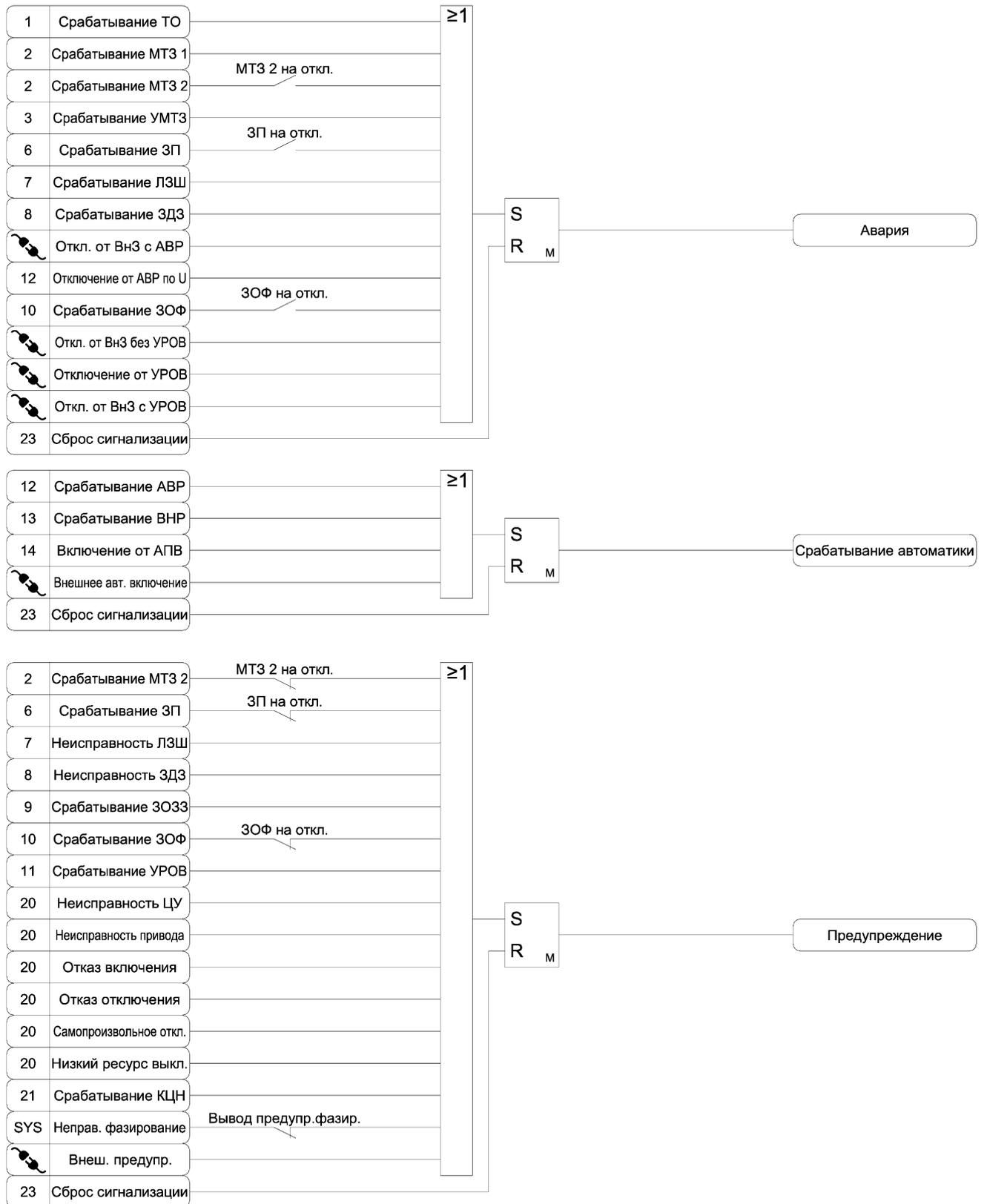
Рисунок А.22 б) – Функциональная схема алгоритма сигнализации
