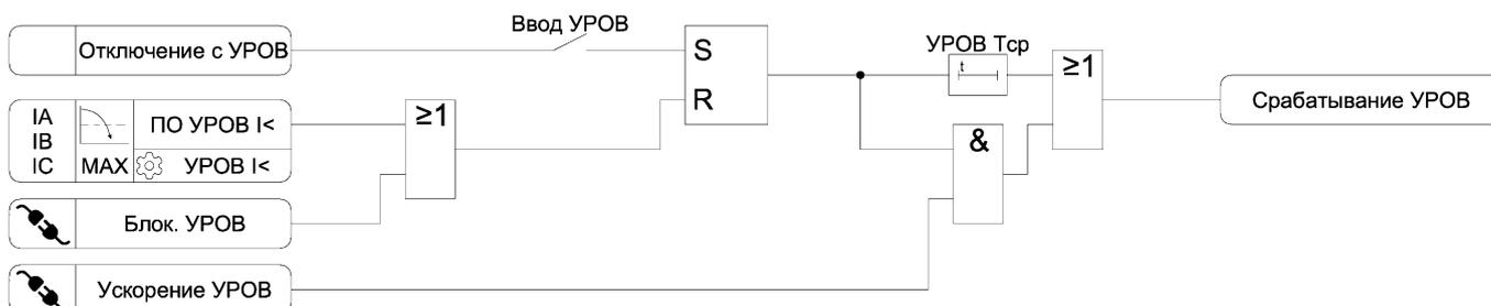
Рисунок 3.12 – Функциональная схема алгоритма УРОВ
