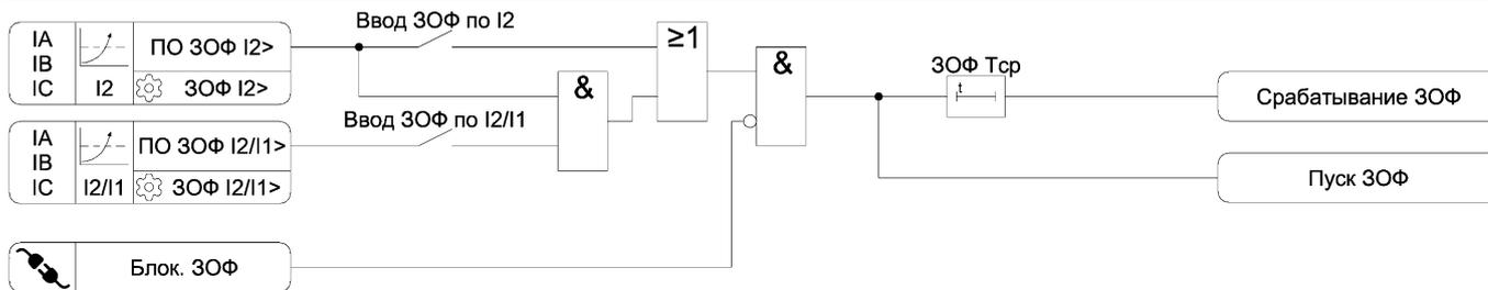
Рисунок 3.11 – Функциональная схема алгоритма 3ОФ
