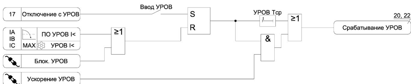
Рисунок А.11 – Функциональная схема алгоритма УРОВ
