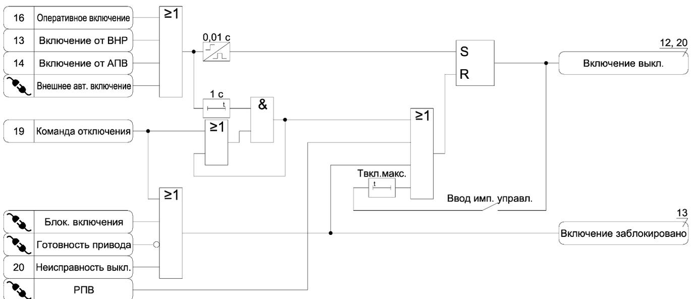
Рисунок А.18 – Функциональная схема алгоритма включения выключателя
