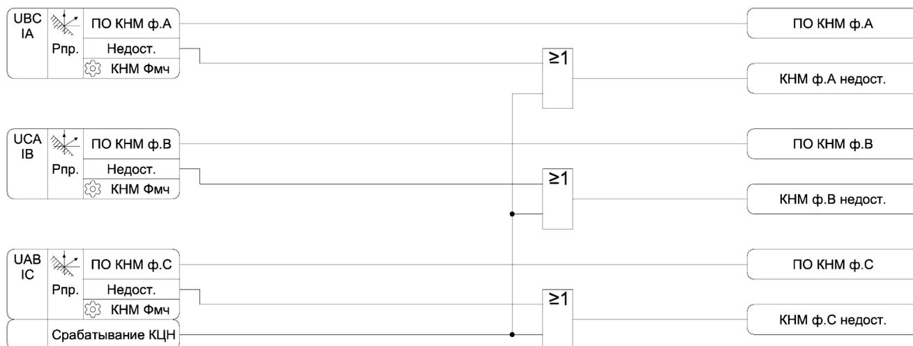
Рисунок 3.4 – Функциональная схема алгоритма КНМ
