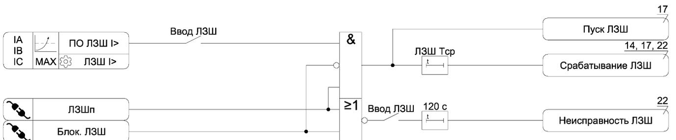
Рисунок А.7 – Функциональная схема алгоритма ЛЗШ
