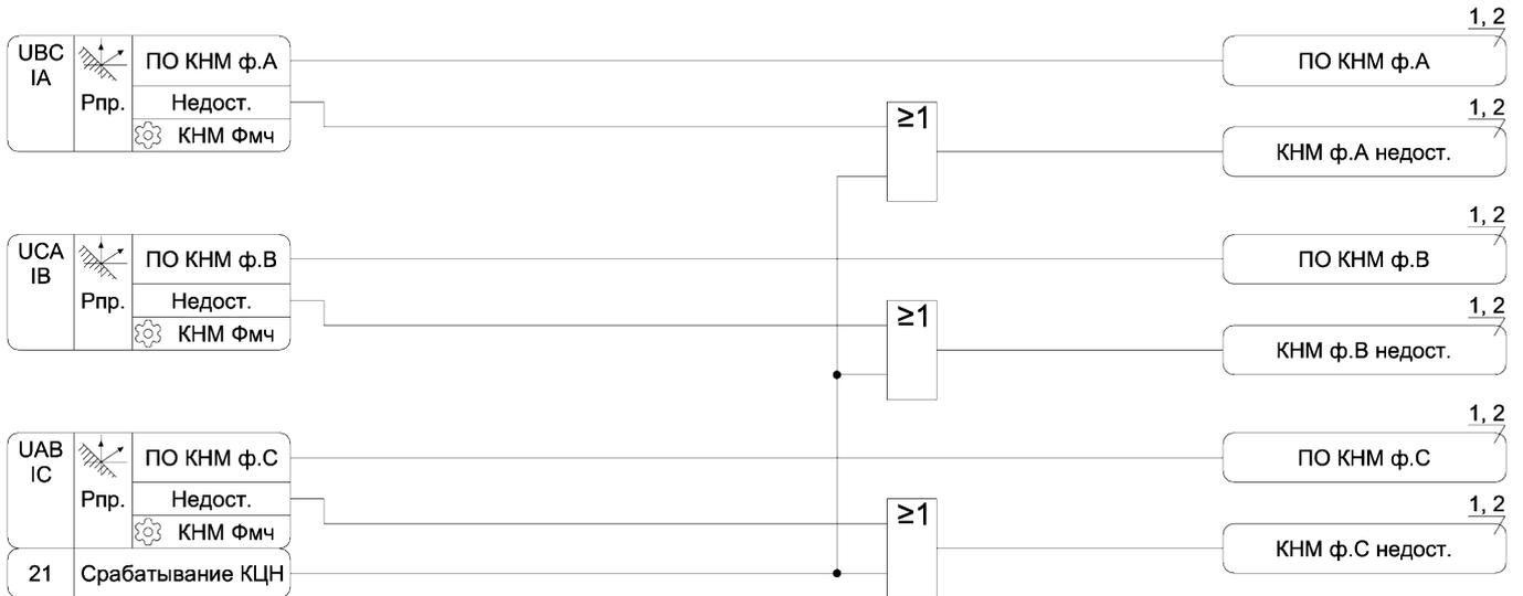
Рисунок А.4 – Функциональная схема алгоритма КНМ
