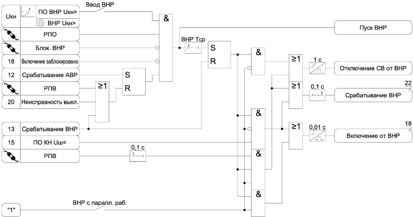
Рисунок А.13 – Функциональная схема алгоритма ВНР
