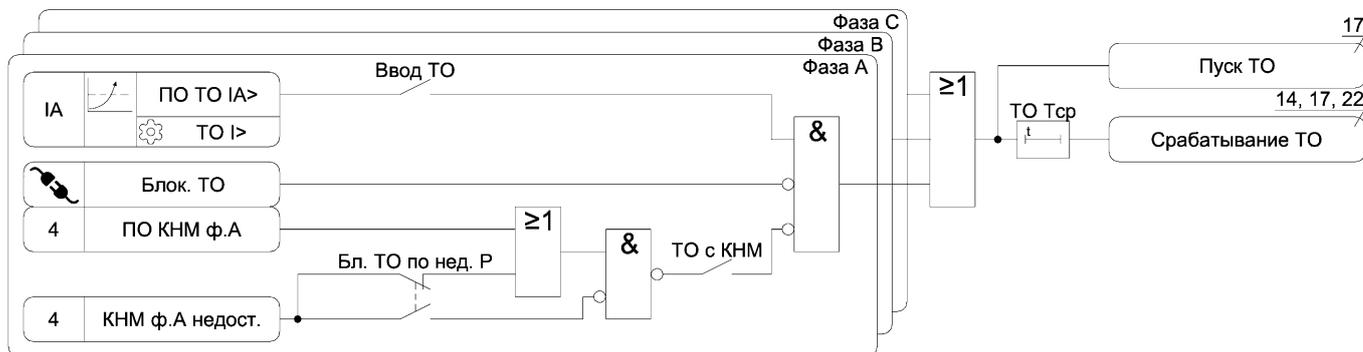
Рисунок А.1 – Функциональная схема алгоритма ТО
