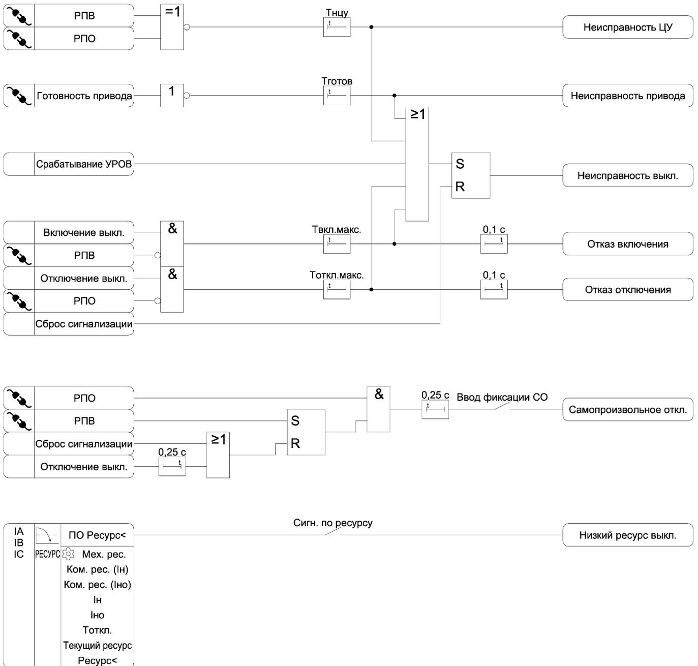
Рисунок 3.23 – Функциональная схема алгоритма диагностики выключателя
