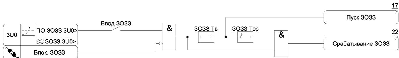
Рисунок А.9 – Функциональная схема алгоритма ZOЗЗ
