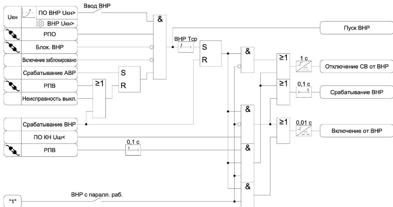
Рисунок 3.16 – Функциональная схема алгоритма ВНР
