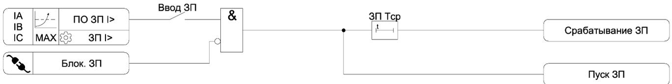
Рисунок 3.7 – Функциональная схема алгоритма ЗП
