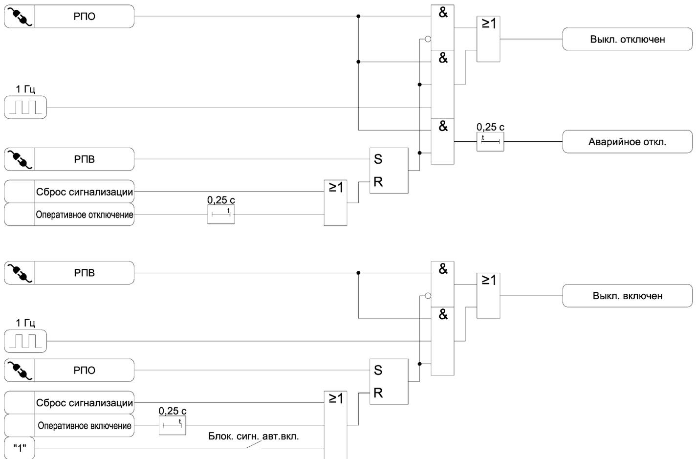
Рисунок 3.25 а) – Функциональная схема алгоритма сигнализации
