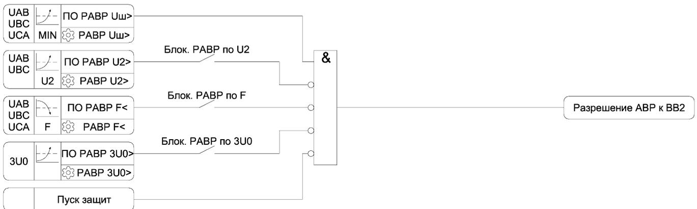
Рисунок 3.15 – Функциональная схема алгоритма РАВР
