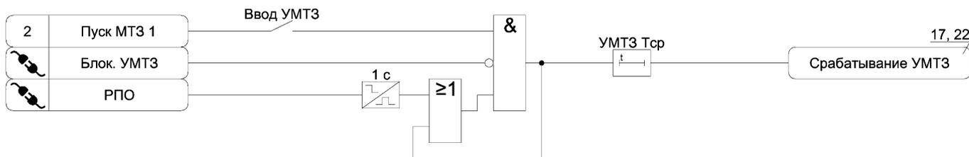
Рисунок А.3 – Функциональная схема алгоритма УМТЗ
