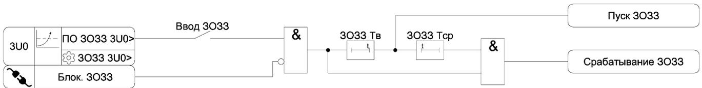
Рисунок 3.10 – Функциональная схема алгоритма ЗОЗЗ
