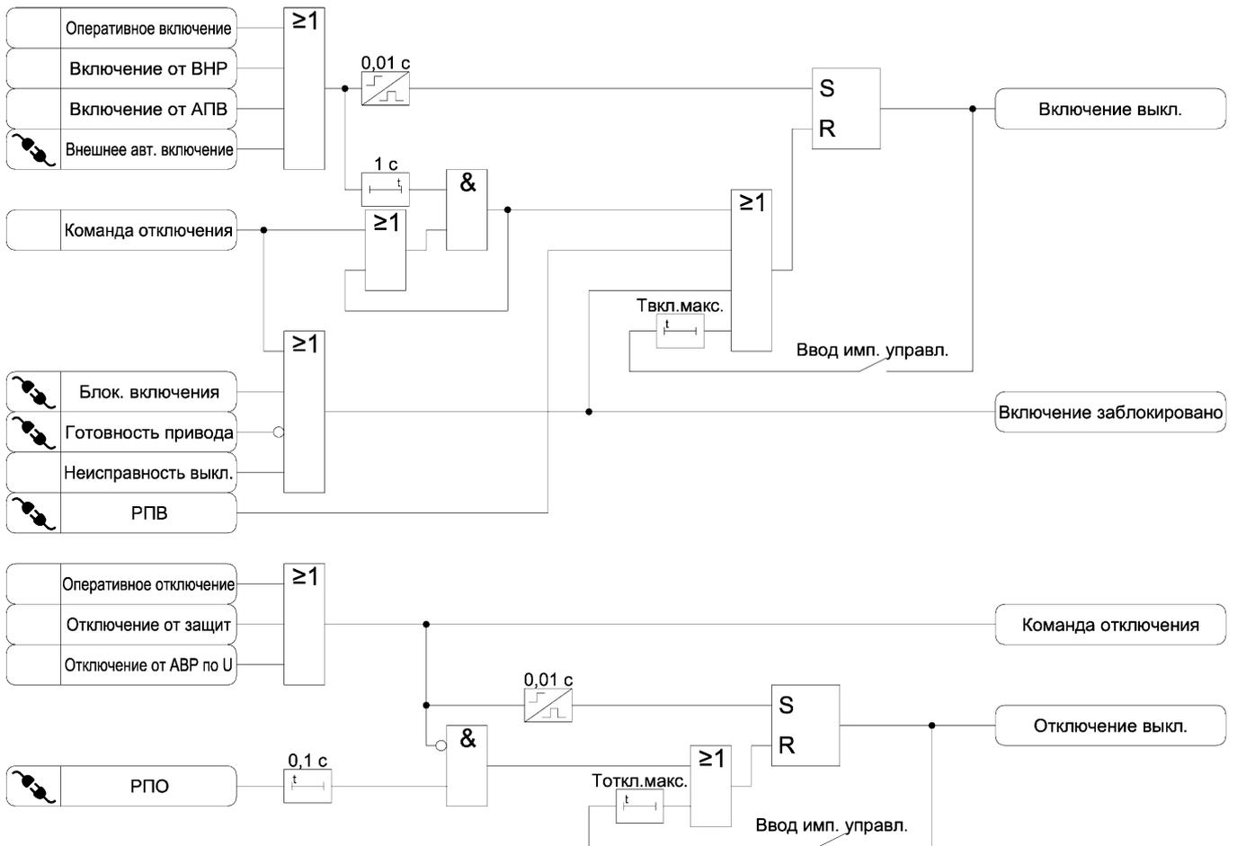
Рисунок 3.22 – Функциональная схема алгоритма управления выключателем
