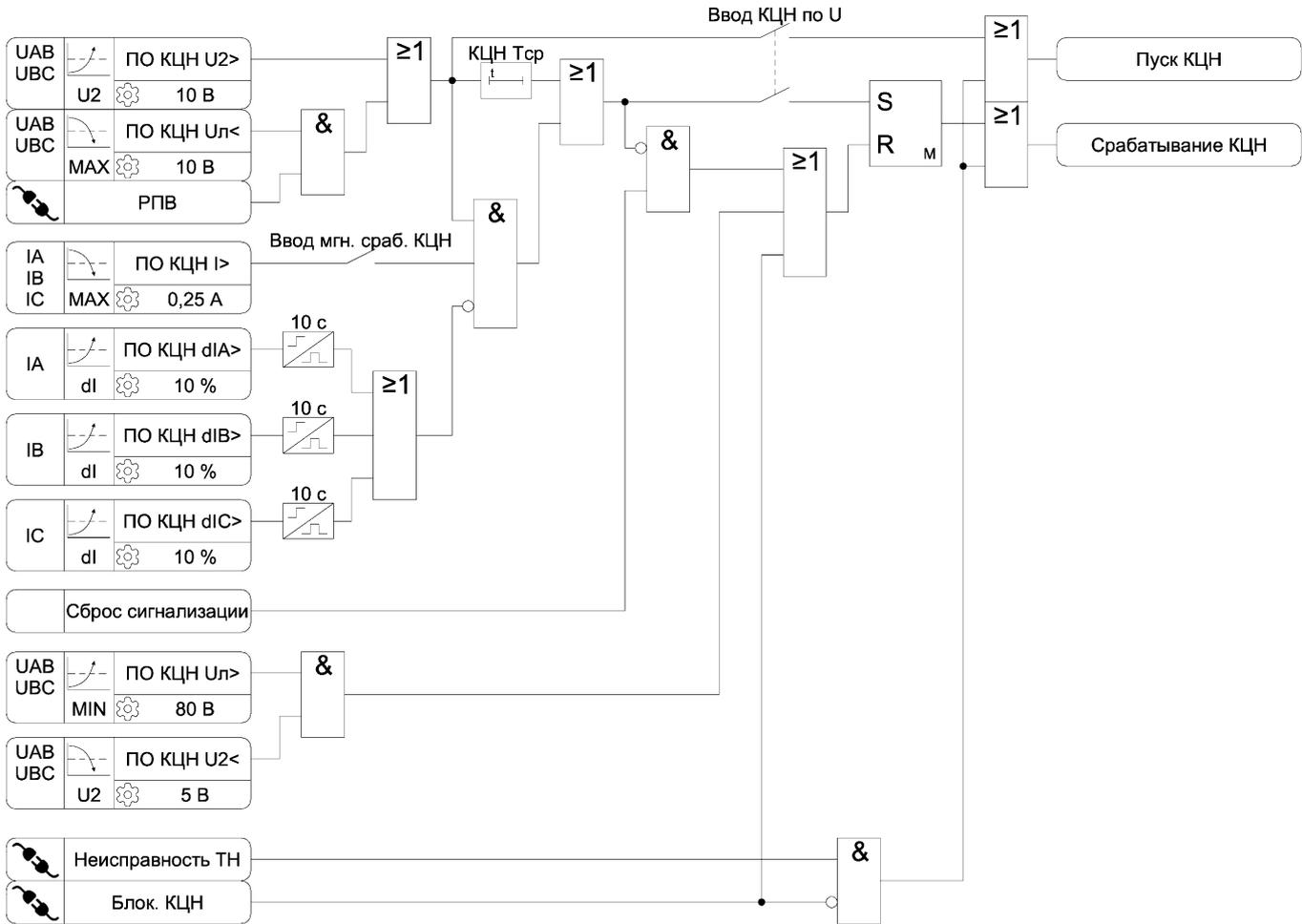
Рисунок 3.24 – Функциональная схема алгоритма КЦН
