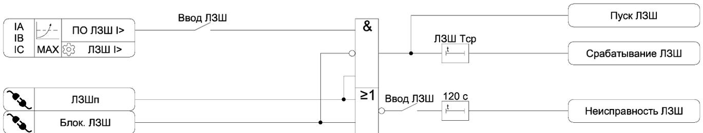
Рисунок 3.8 – Функциональная схема алгоритма ЛЗШ
