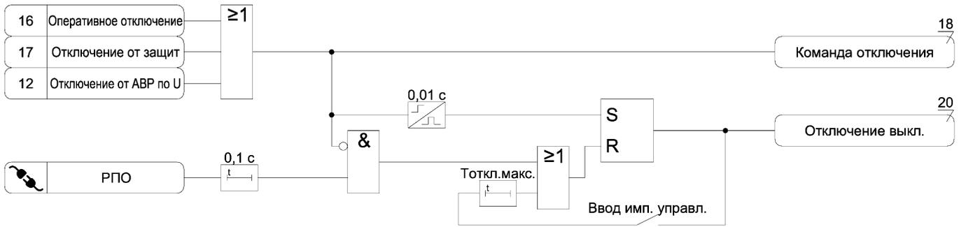
Рисунок А.19 – Функциональная схема алгоритма отключения выключателя
