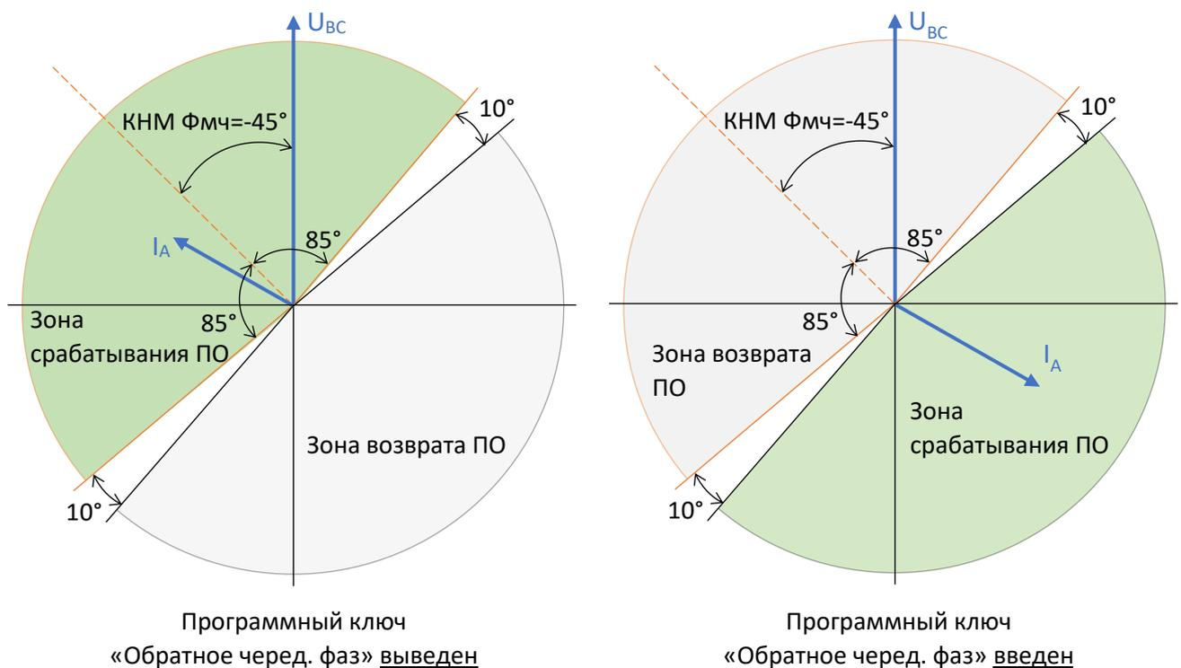
Рисунок 3.5 – Диаграмма срабатывания пускового органа функции КНМ
