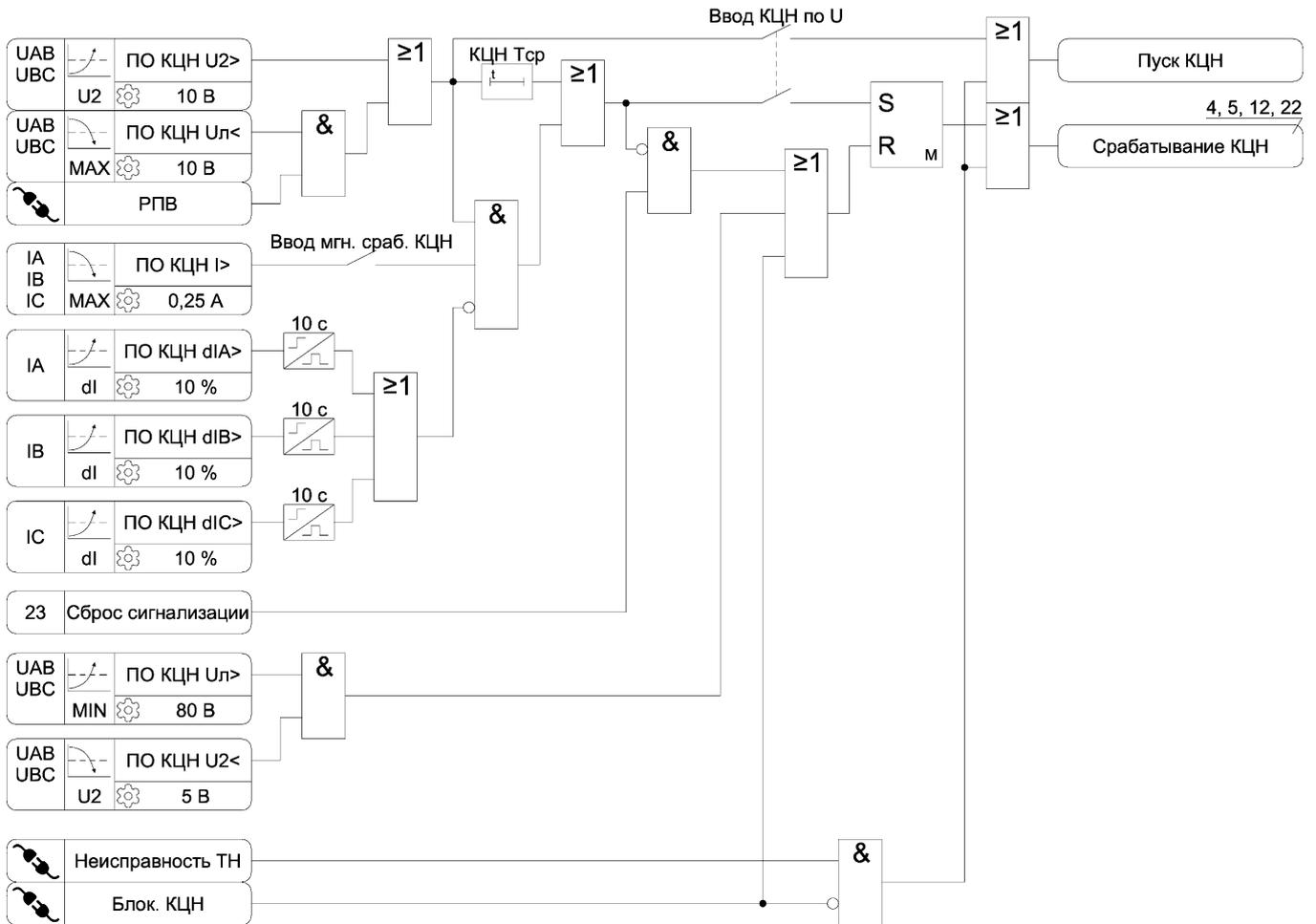
Рисунок А.21 – Функциональная схема алгоритма КЦН
