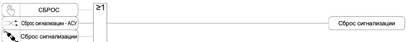
Рисунок 3.26 – Функциональная схема алгоритма сброса сигнализации
