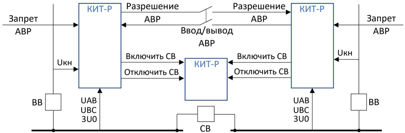
Рисунок 3.14 – Структурная схема АВР
