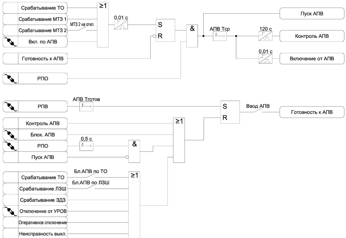
Рисунок 3.17 – Функциональная схема алгоритма АПВ
