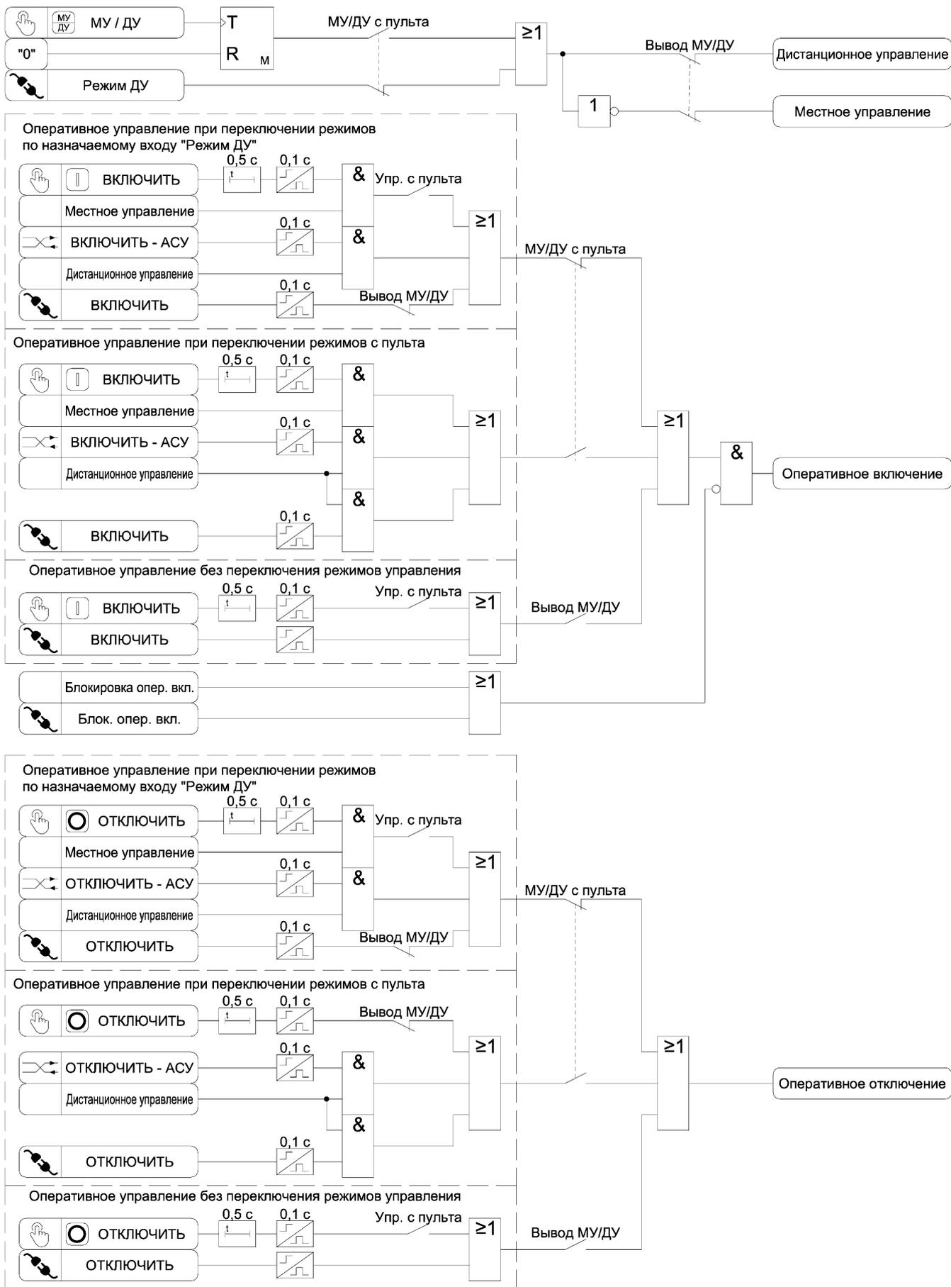
Рисунок 3.19 – Функциональная схема алгоритма оперативного управления выключателем
