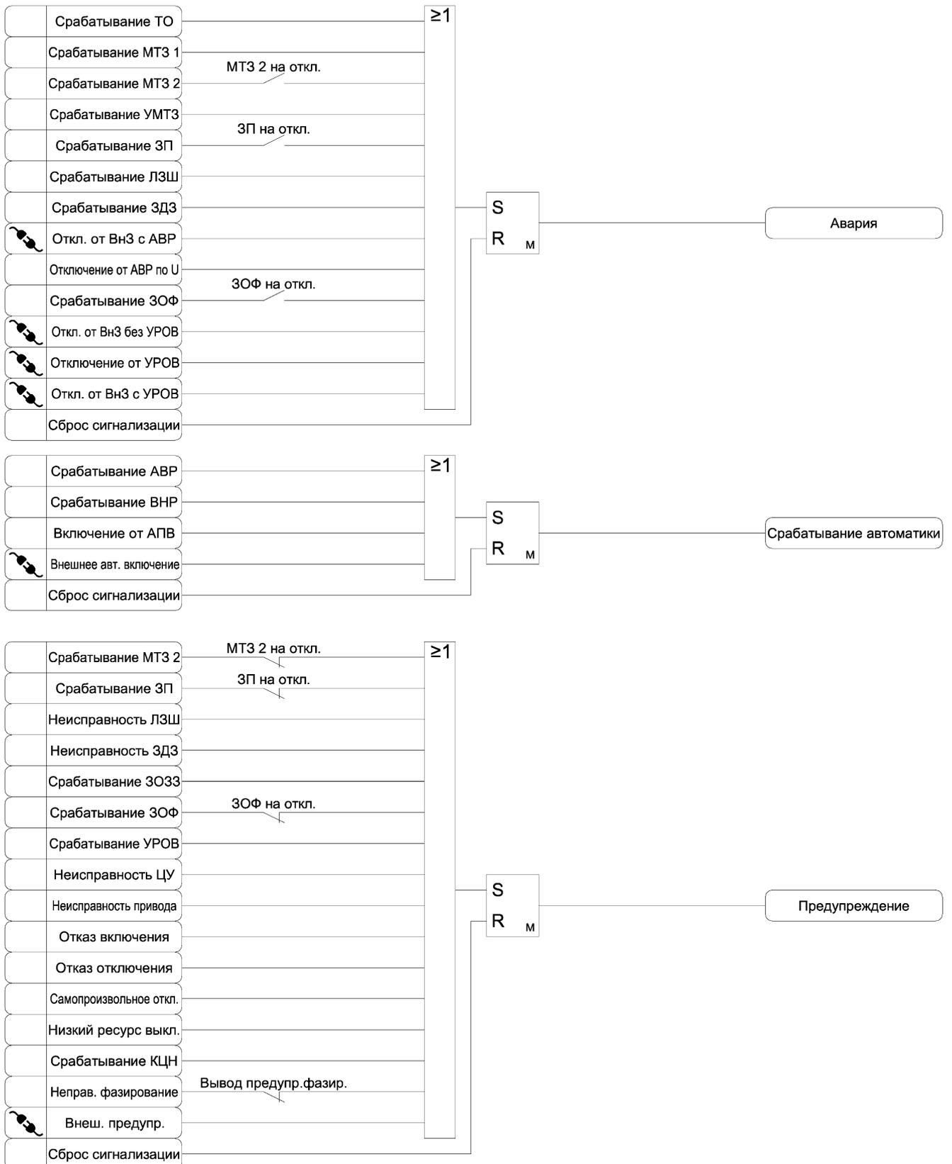
Рисунок 3.25 б) – Функциональная схема алгоритма сигнализации
