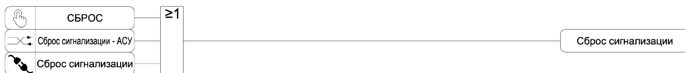
Рисунок 3.23 – Функциональная схема алгоритма сброса сигнализации
