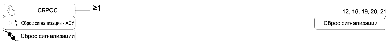
Рисунок А.22 – Функциональная схема алгоритма сброса сигнализации
