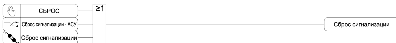
Рисунок 3.11 – Функциональная схема алгоритма сброса сигнализации
