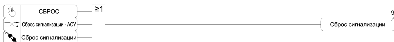
Рисунок А.10 – Функциональная схема алгоритма сброса сигнализации
