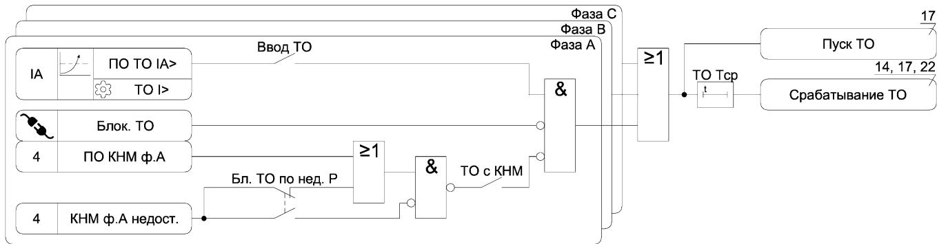
Рисунок А.1 – Функциональная схема алгоритма ТО
