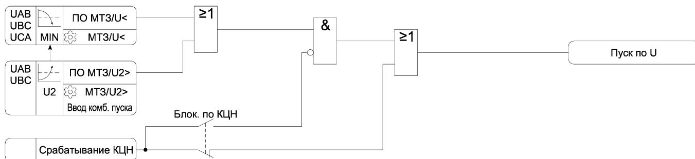
Рисунок 3.6 – Функциональная схема алгоритма MT3/U
