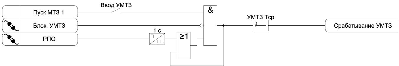
Рисунок 3.3 – Функциональная схема алгоритма УМТЗ
