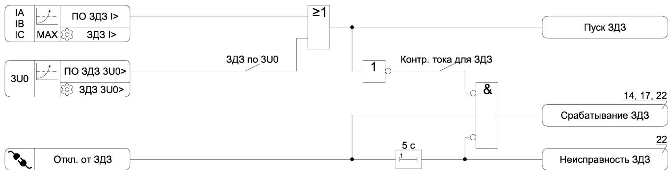
Рисунок А.8 – Функциональная схема алгоритма ЗДЗ
