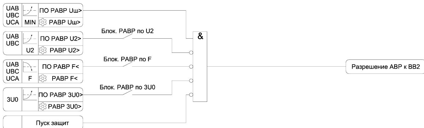
Рисунок 3.15 – Функциональная схема алгоритма PABP
