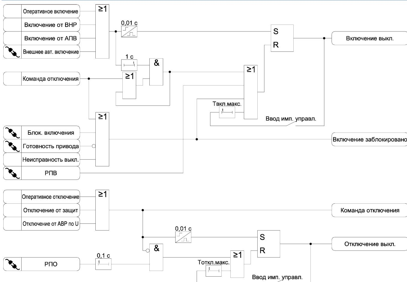
Рисунок 3.22 – Функциональная схема алгоритма управления выключателем
