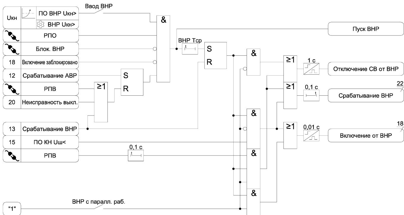
Рисунок А.13 – Функциональная схема алгоритма ВНР
