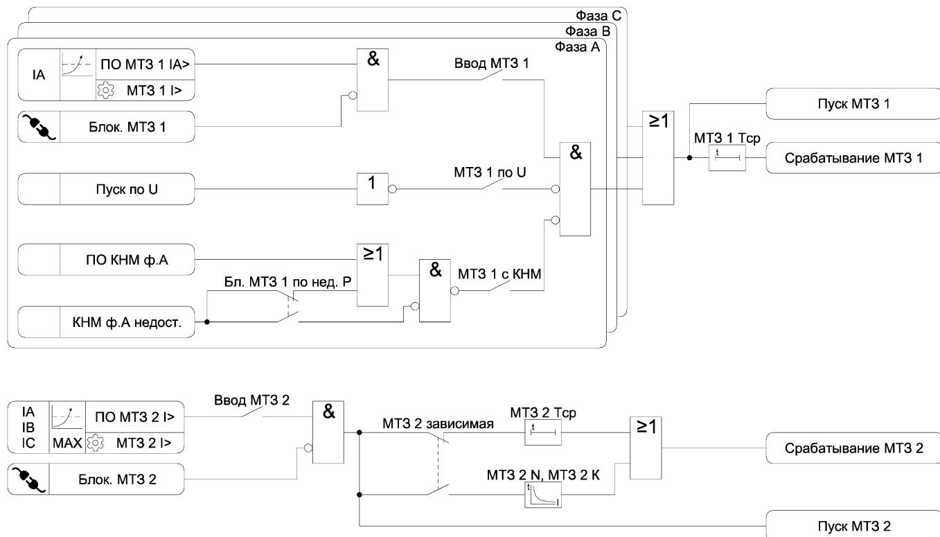
Рисунок 3.2 – Функциональная схема алгоритма МТЗ
