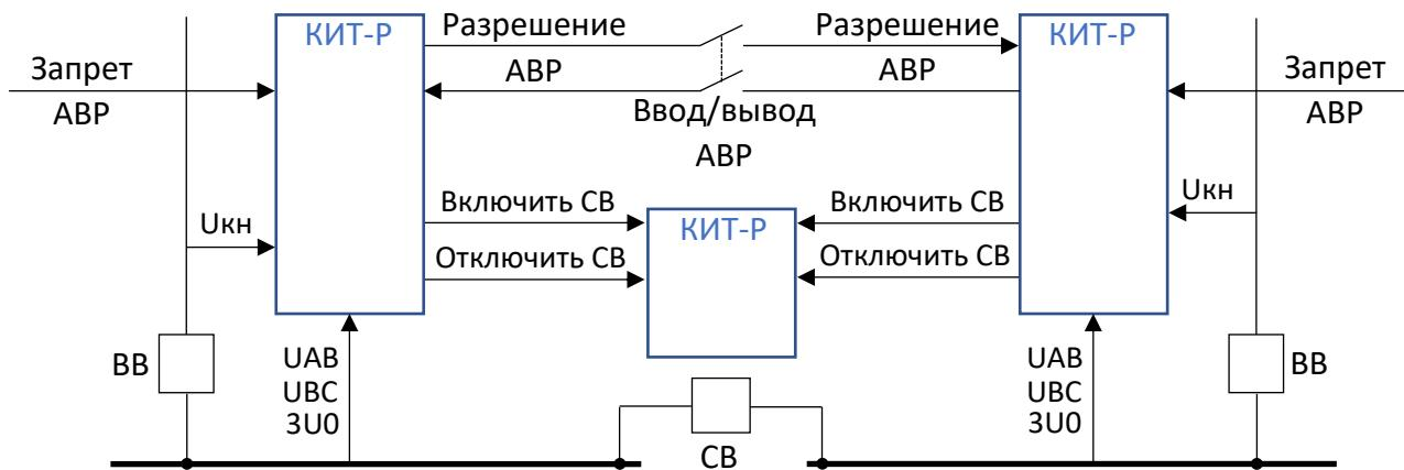
Рисунок 3.14 – Структурная схема АВР
