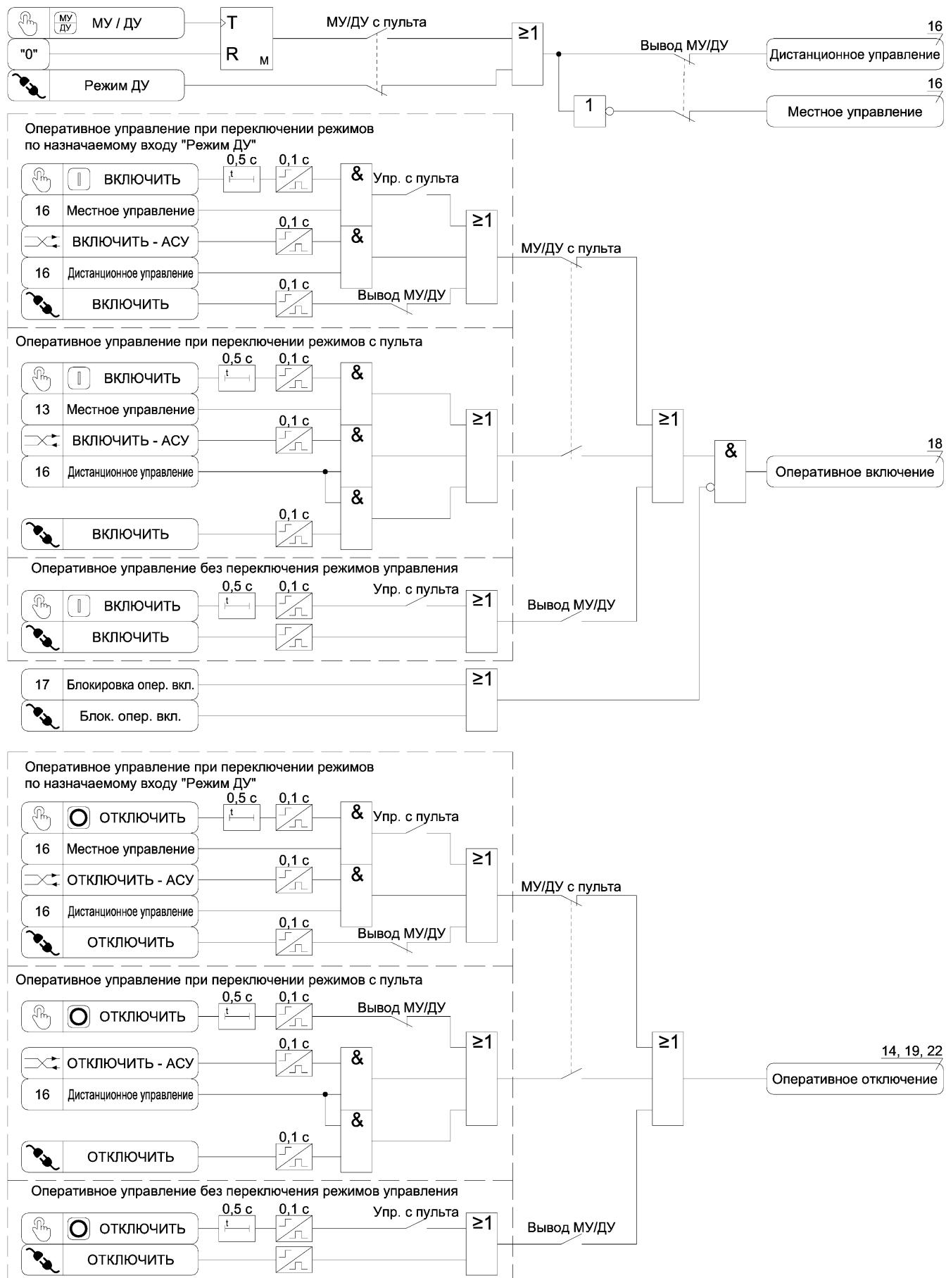
Рисунок А.16 – Функциональная схема алгоритма оперативного управления выключателем
