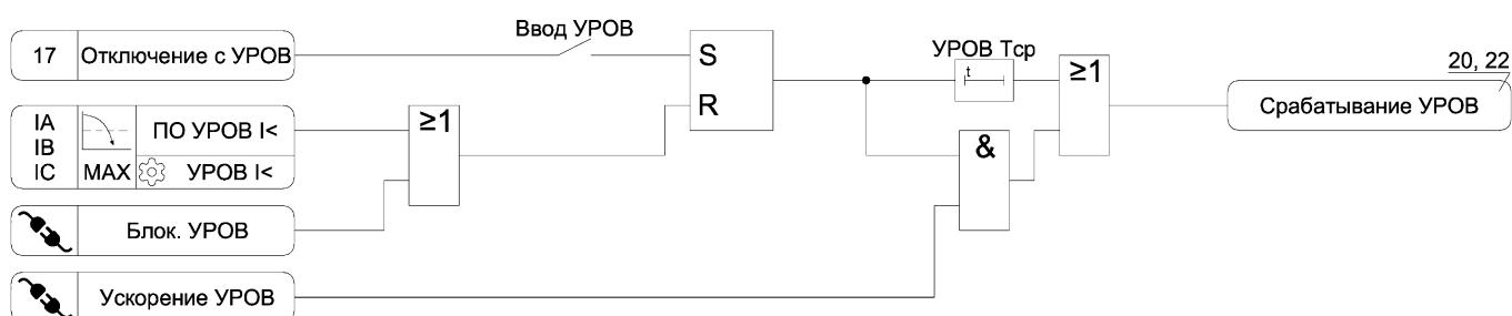
Рисунок А.11 – Функциональная схема алгоритма УРОВ
