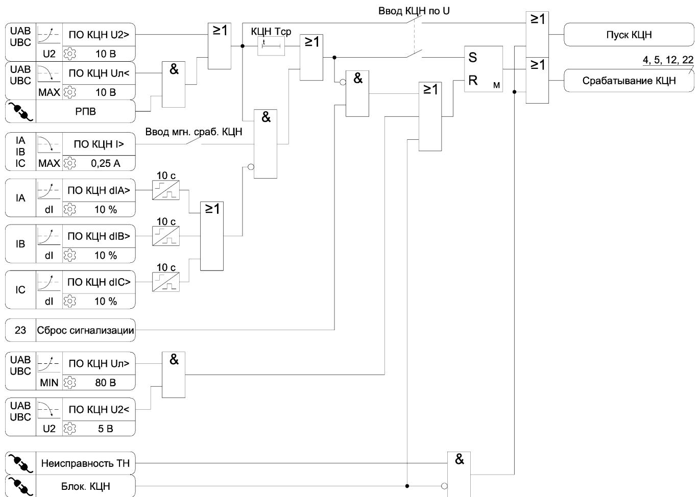
Рисунок А.21 – Функциональная схема алгоритма КЧН
