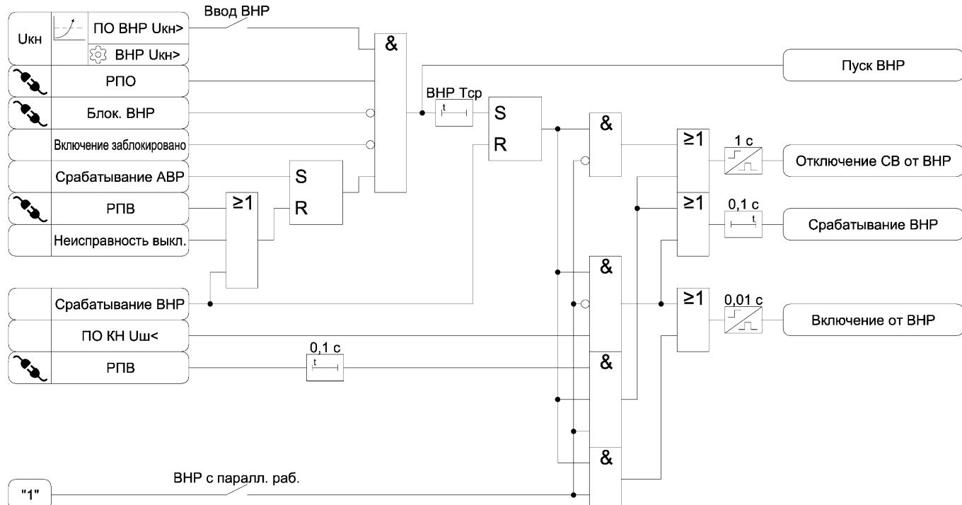
Рисунок 3.16 – Функциональная схема алгоритма ВНР
