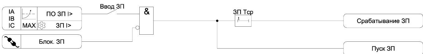
Рисунок 3.7 – Функциональная схема алгоритма ЗП
