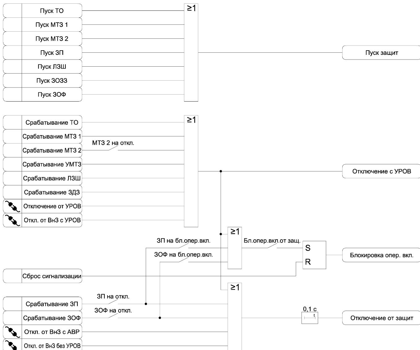
Рисунок 3.21 – Функциональная схема алгоритма формирования сигналов состояния защит
