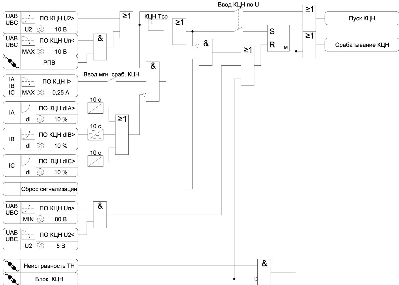
Рисунок 3.24 – Функциональная схема алгоритма КЦН
