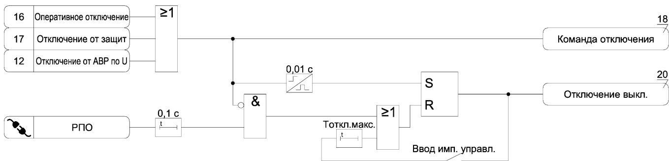
Рисунок А.19 – Функциональная схема алгоритма отключения выключателя
