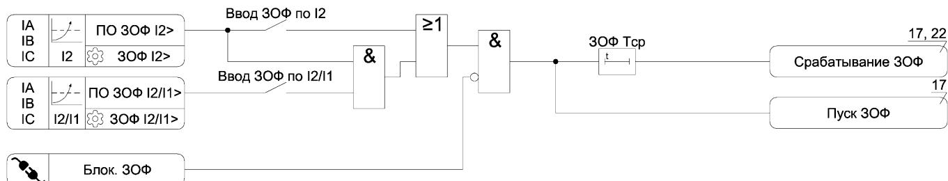
Рисунок А.10 – Функциональная схема алгоритма ZOФ
