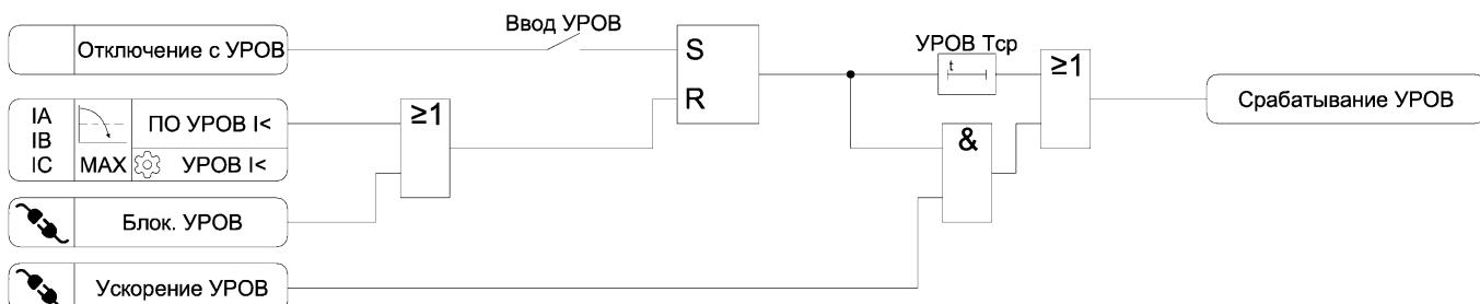
Рисунок 3.12 – Функциональная схема алгоритма УРОВ
