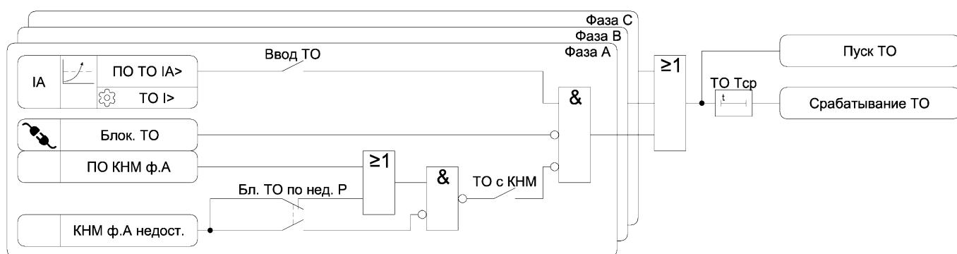
Рисунок 3.1 – Функциональная схема алгоритма ТО
