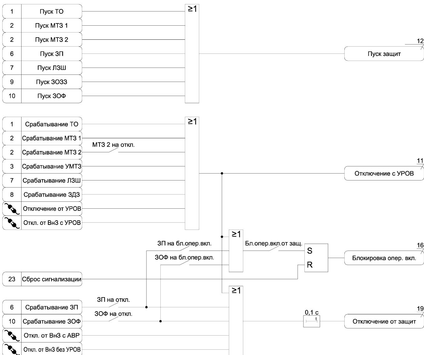
Рисунок А.17 – Функциональная схема алгоритма состояния защит
