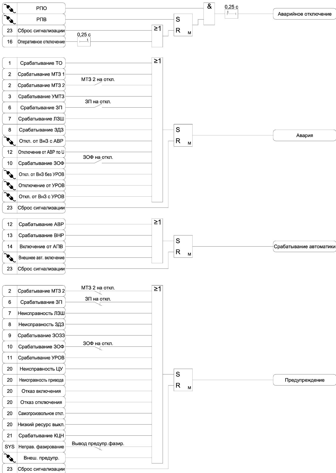
Рисунок А.22 – Функциональная схема алгоритма сигнализации
