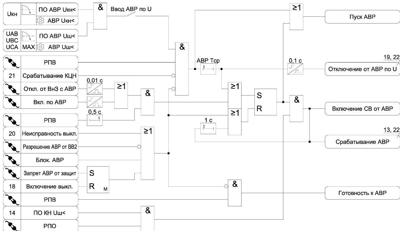
Рисунок 3.13 – Функциональная схема алгоритма АВР
