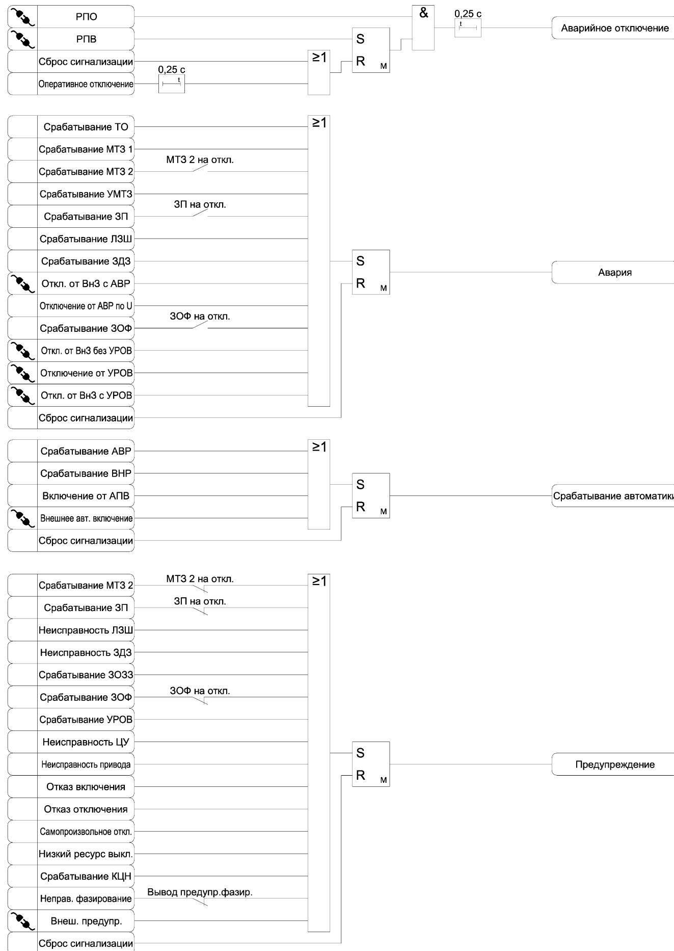
Рисунок 3.25 – Функциональная схема алгоритма сигнализации
