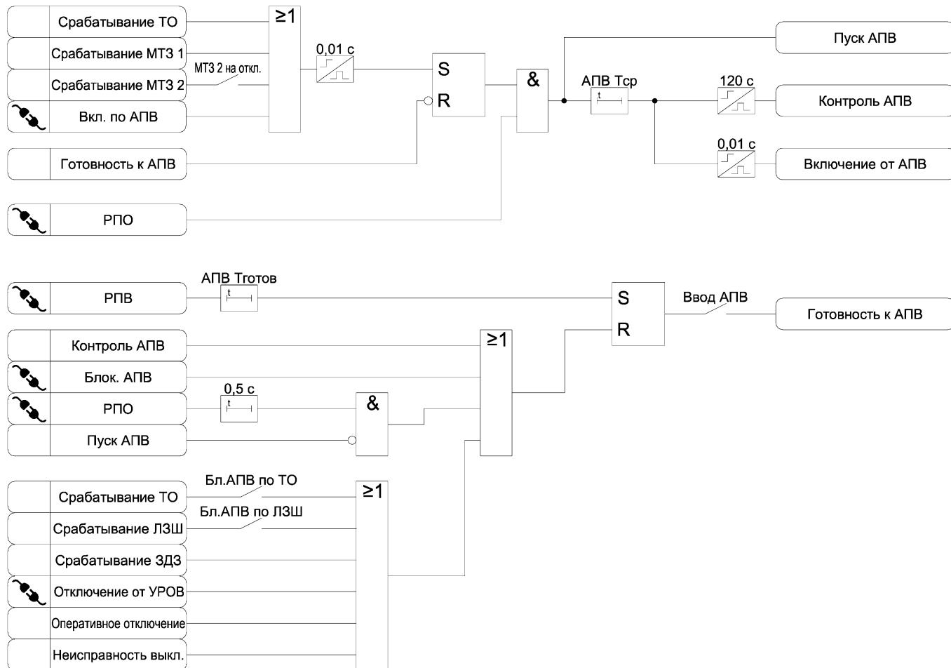
Рисунок 3.17 – Функциональная схема алгоритма АПВ
