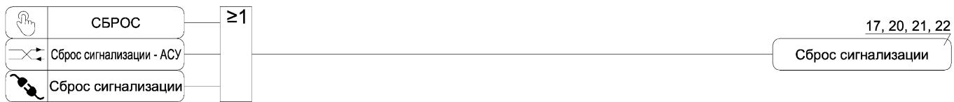
Рисунок А.23 – Функциональная схема алгоритма сброса сигнализации
