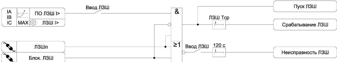
Рисунок 3.8 – Функциональная схема алгоритма ЛЗШ
