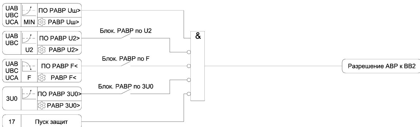
Рисунок А.12 – Функциональная схема алгоритма АВР
