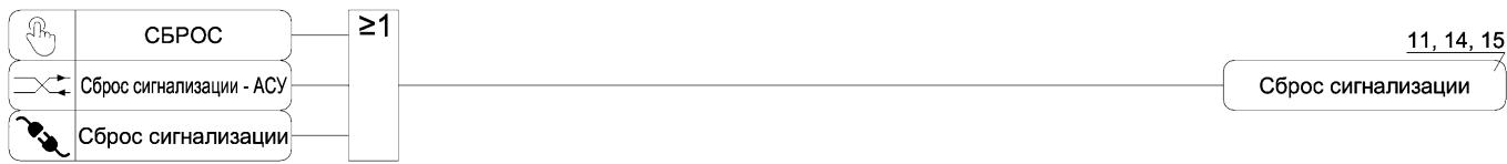
Рисунок А.16 – Функциональная схема алгоритма сброса сигнализации
