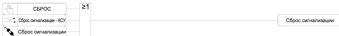
Рисунок 3.12 – Функциональная схема алгоритма сброса сигнализации
