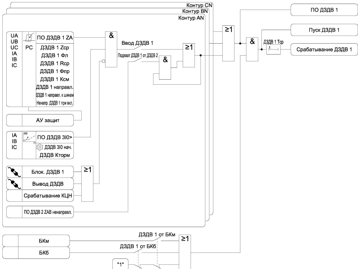
Рисунок 3.3 а) – Функциональная схема алгоритма ДЗДВ
