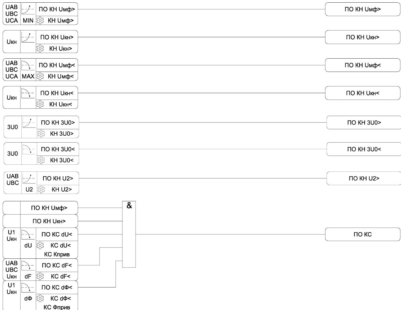
Рисунок 3.29 – Функциональная схема алгоритма КН
