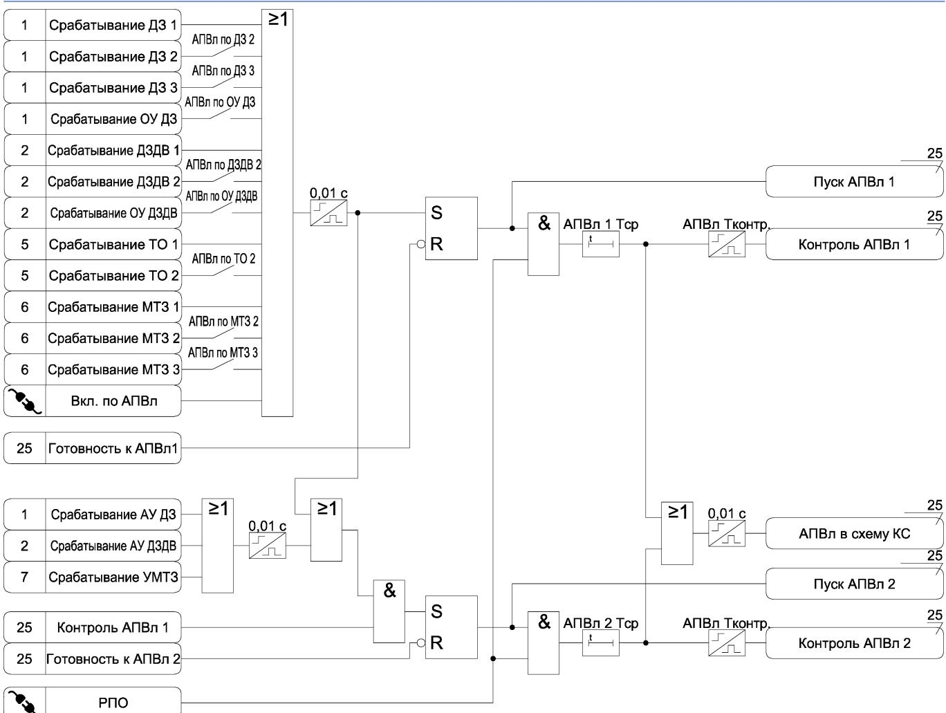
Рисунок А.25 а) – Функциональная схема алгоритма АПВ
