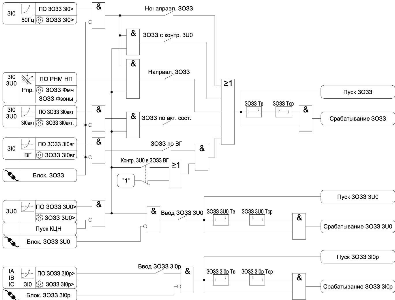
Рисунок 3.17 – Функциональная схема алгоритма ЗО33
