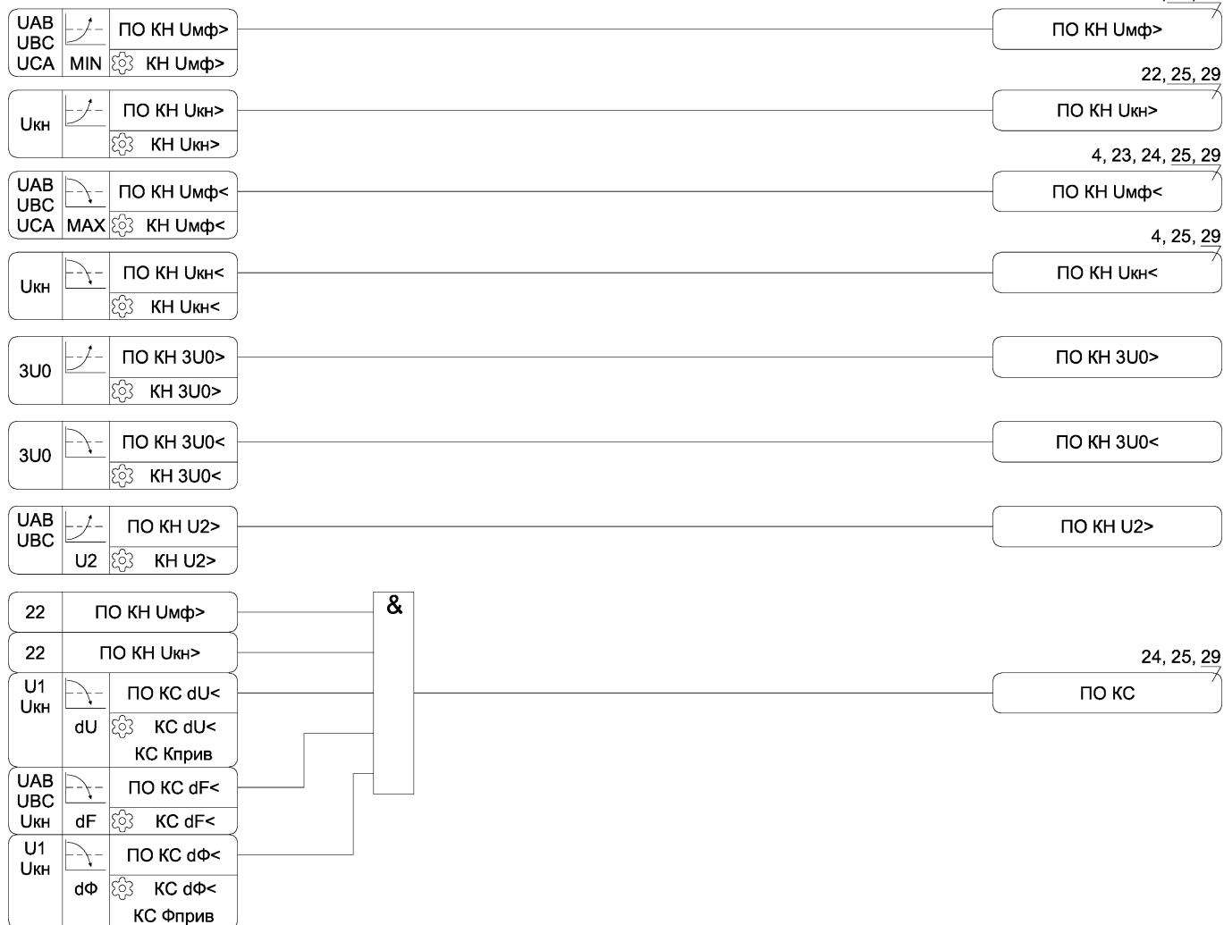
Рисунок А.22 – Функциональная схема алгоритма КН и КС
