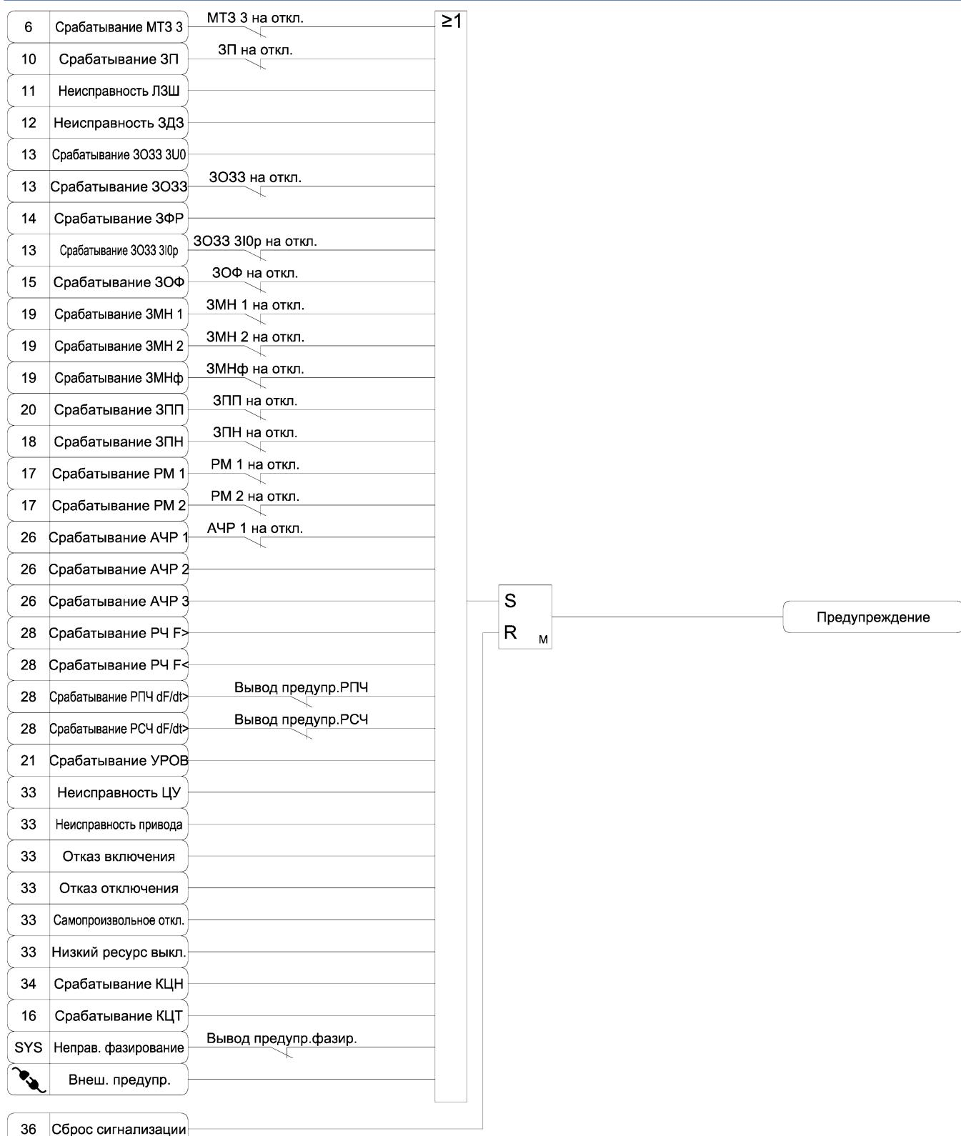
Рисунок А.35 в) – Функциональная схема алгоритма сигнализации
