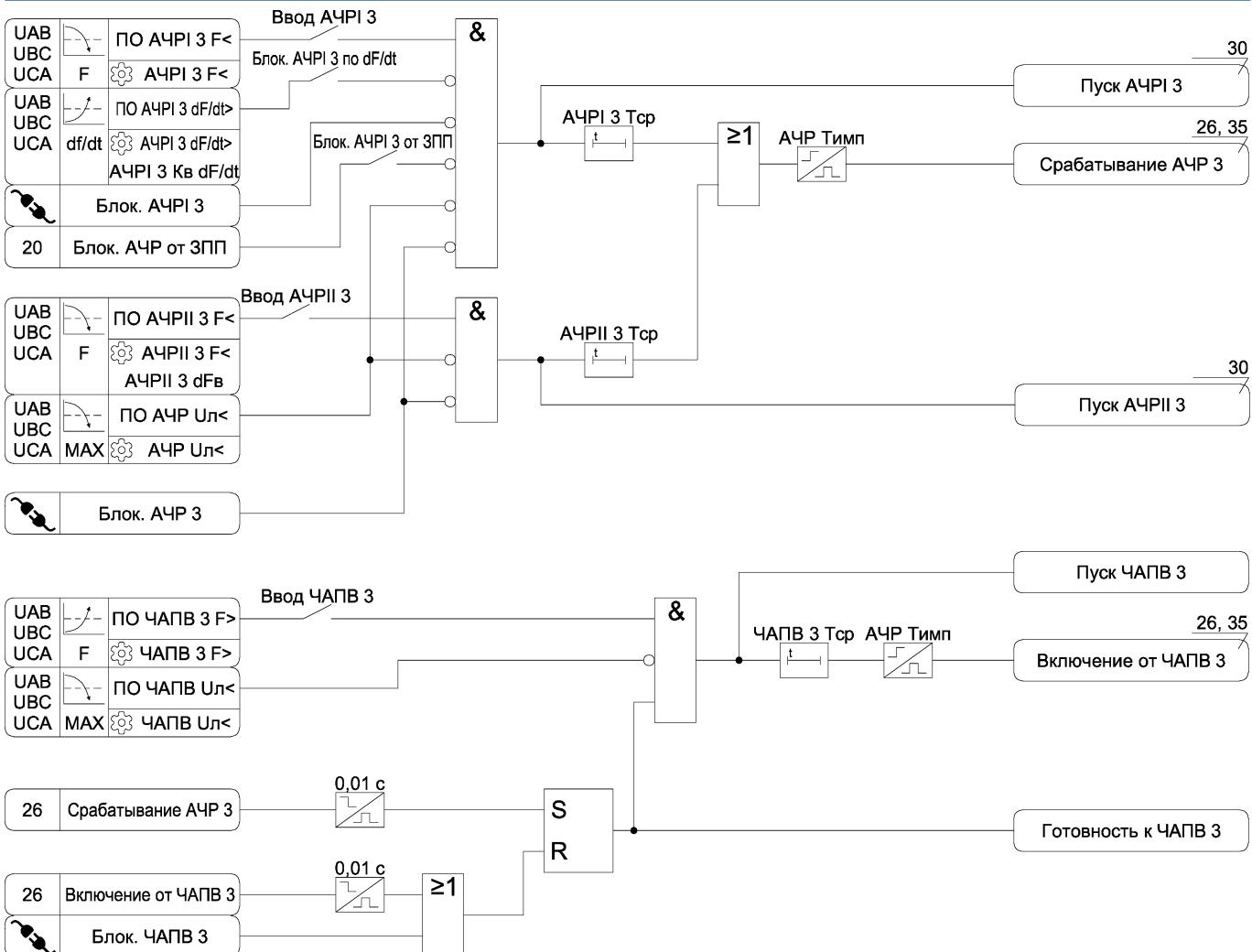
Рисунок А.26 в) – Функциональная схема алгоритма АЧР и ЧАПВ
