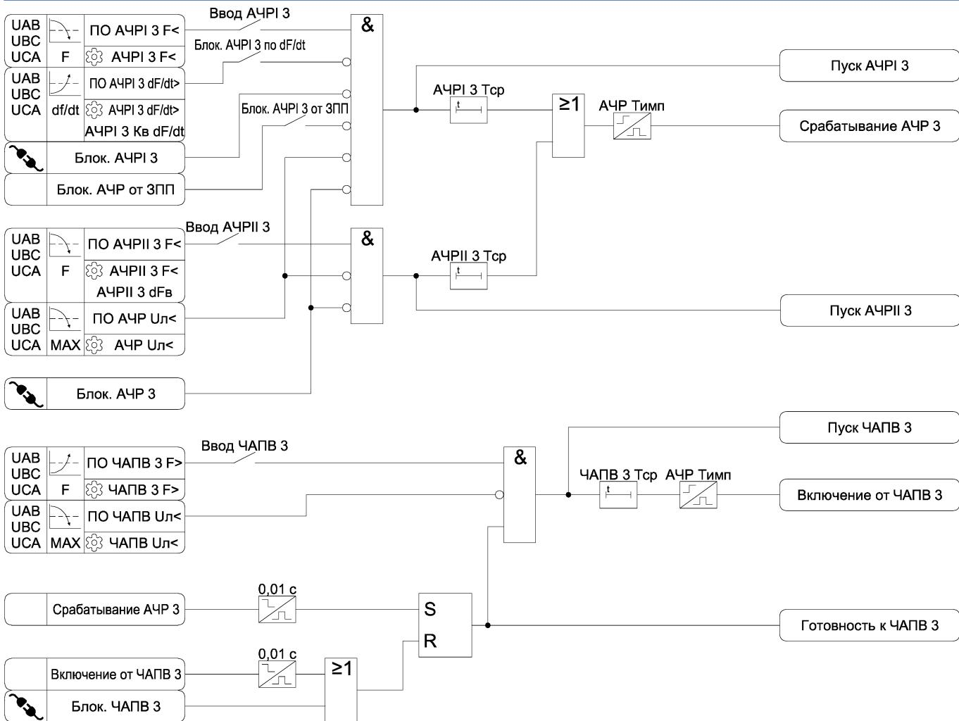
Рисунок 3.35 в) – Функциональные схемы алгоритмов АЧР и ЧАПВ
