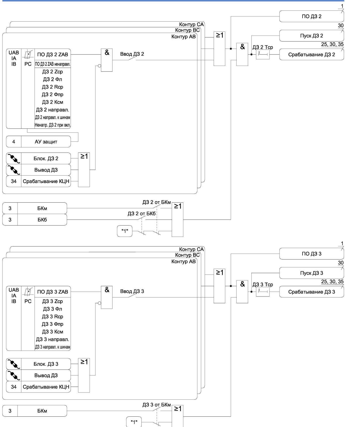
Рисунок А.1 б) – Функциональная схема алгоритма ДЗ
