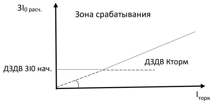
Рисунок 3.5 – Характеристика срабатывания ПО нулевой последовательности
