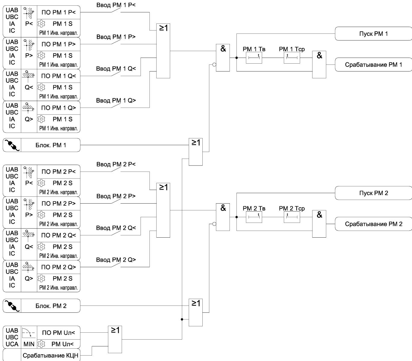
Рисунок 3.23 – Функциональная схема алгоритма защиты по направлению мощности
