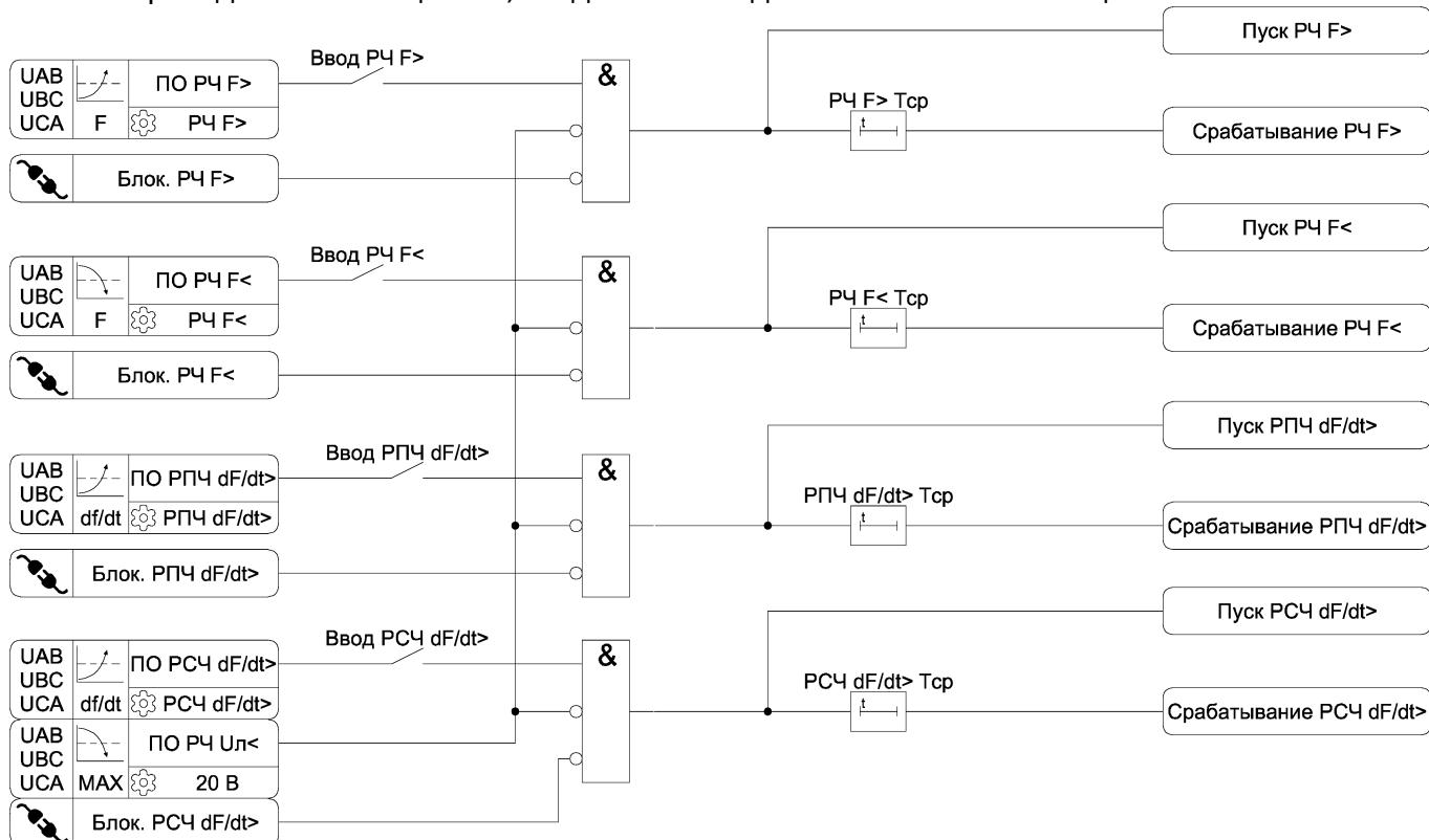
Рисунок 3.37 – Функциональные схемы алгоритмов защиты повышения и снижения частоты
