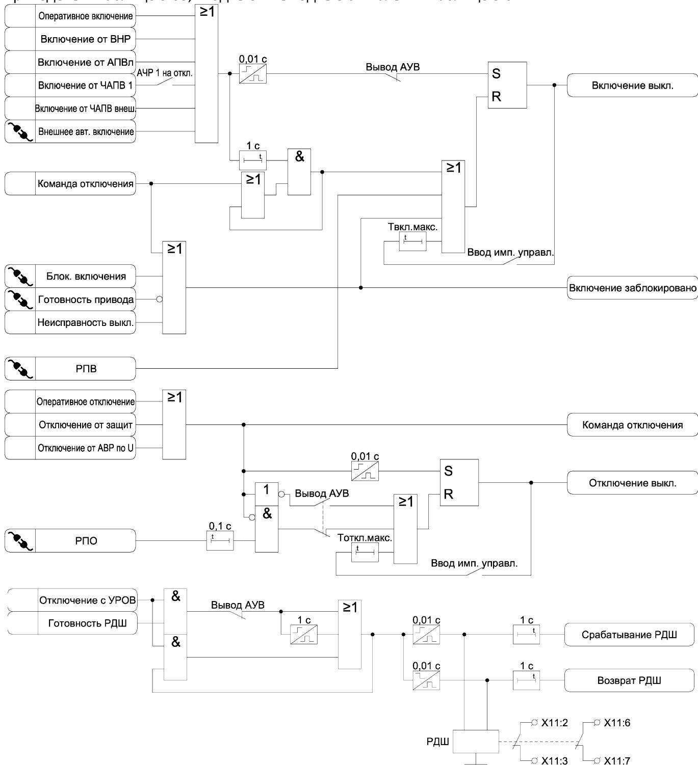
Рисунок 3.41 – Функциональная схема алгоритма управления выключателем
