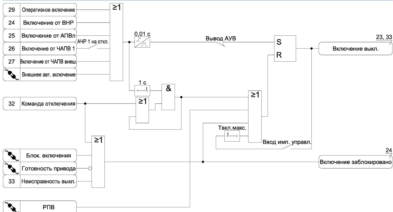
Рисунок А.31 – Функциональная схема алгоритма включения выключателя
