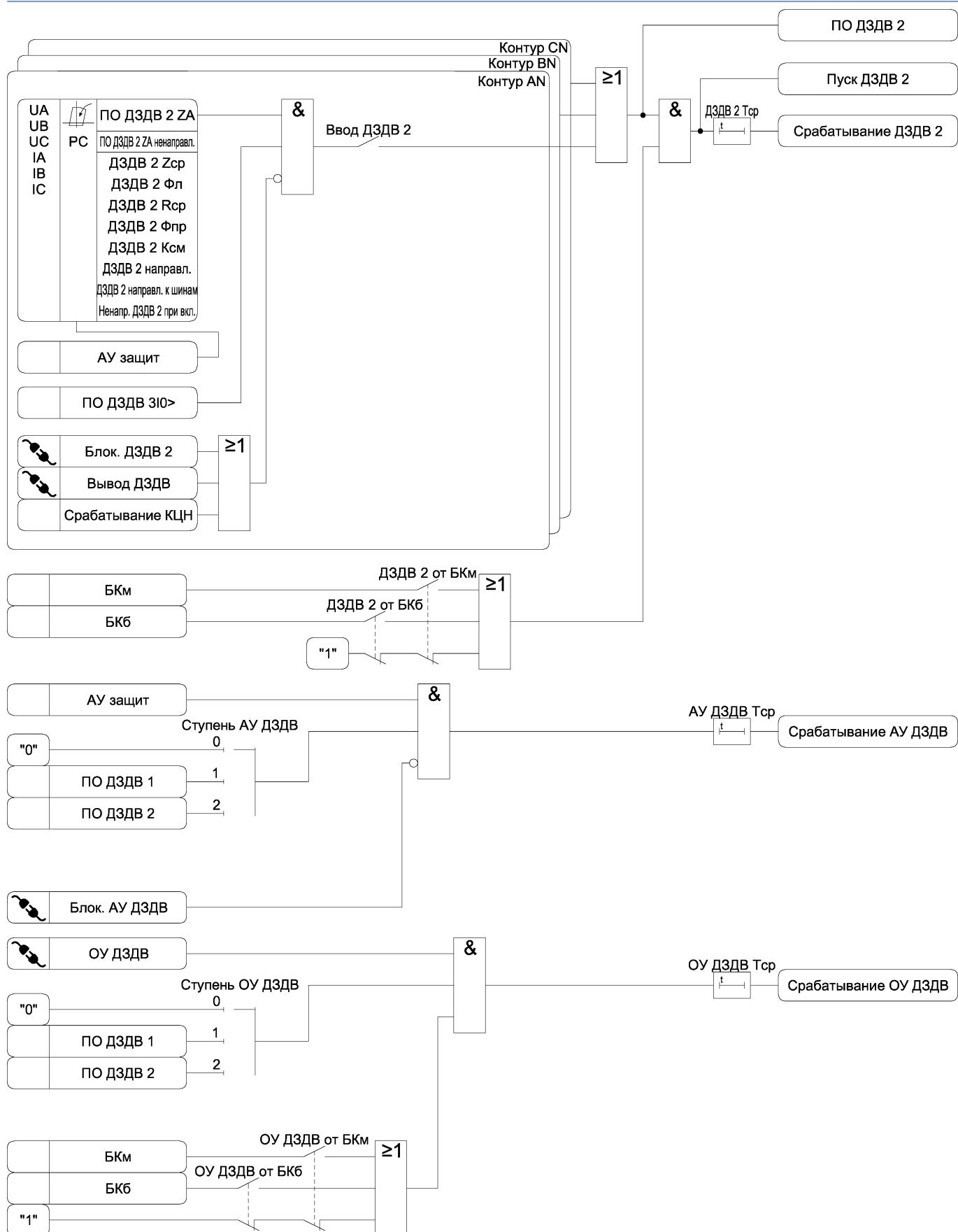
Рисунок 3.3 б) – Функциональная схема алгоритма ДЗДВ
