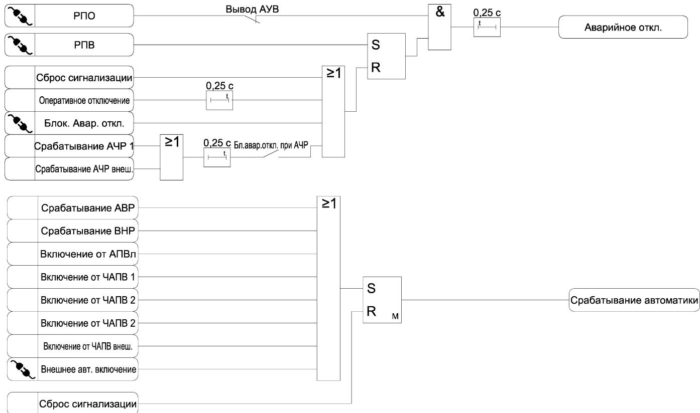
Рисунок 3.44 а) – Функциональная схема алгоритма сигнализации
