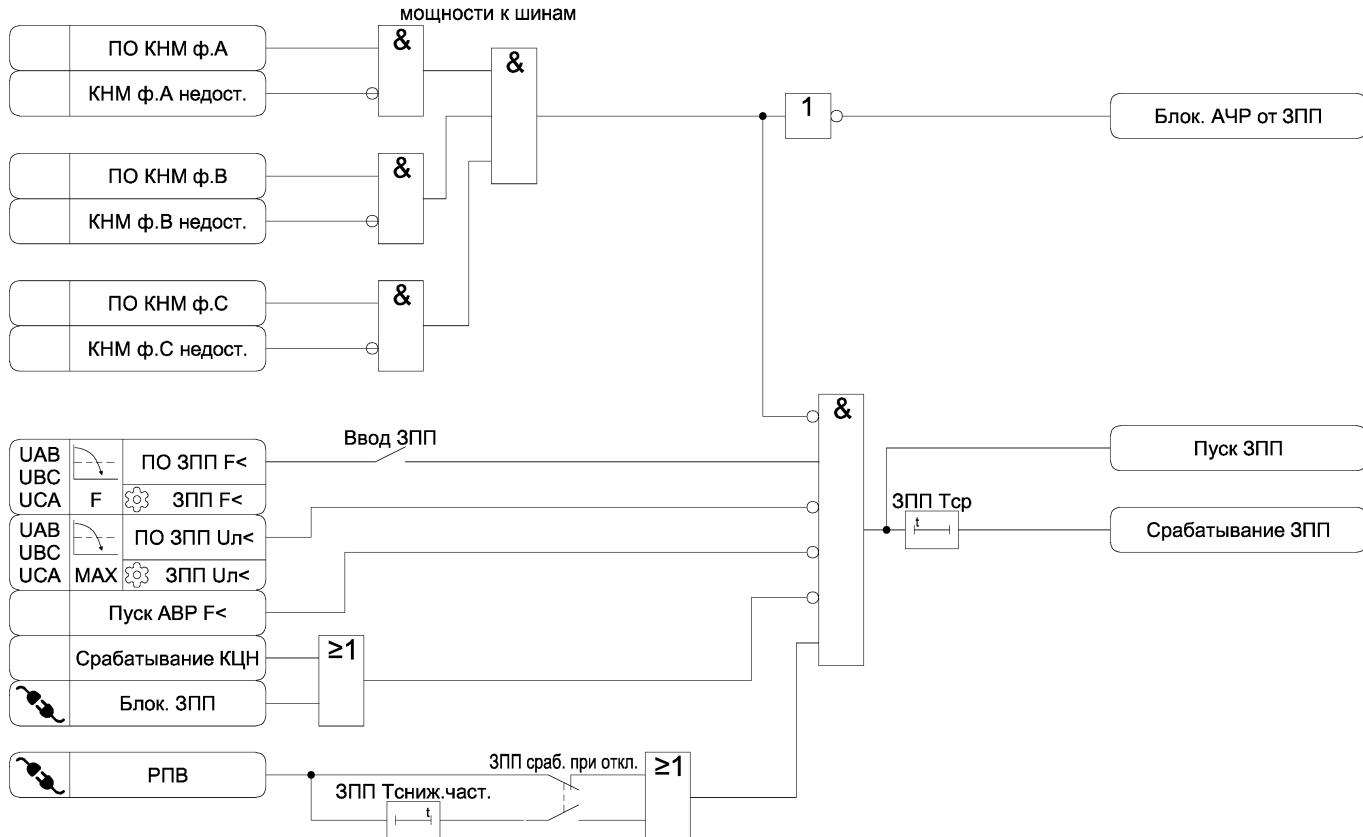
Рисунок 3.27 – Функциональная схема алгоритма ЗПП
