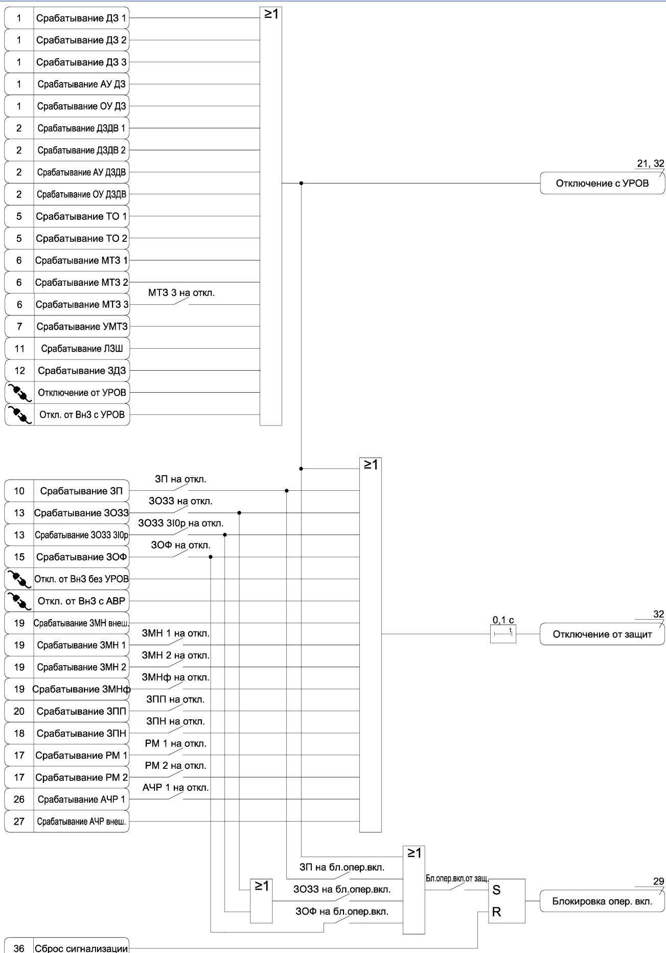
Рисунок А.30 б) – Функциональная схема алгоритма состояния защит
