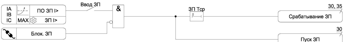
Рисунок А.10 – Функциональная схема алгоритма ЗП
