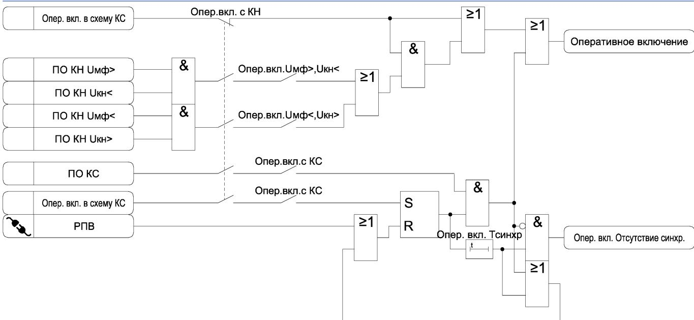
Рисунок 3.38 б) – Функциональная схема алгоритма оперативного управления выключателем
