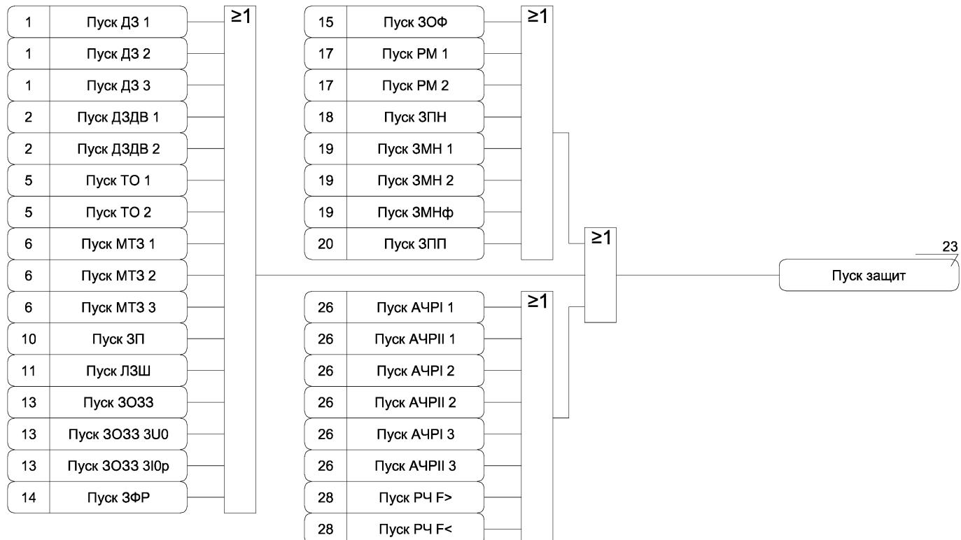
Рисунок А.30 а) – Функциональная схема алгоритма состояния защит
