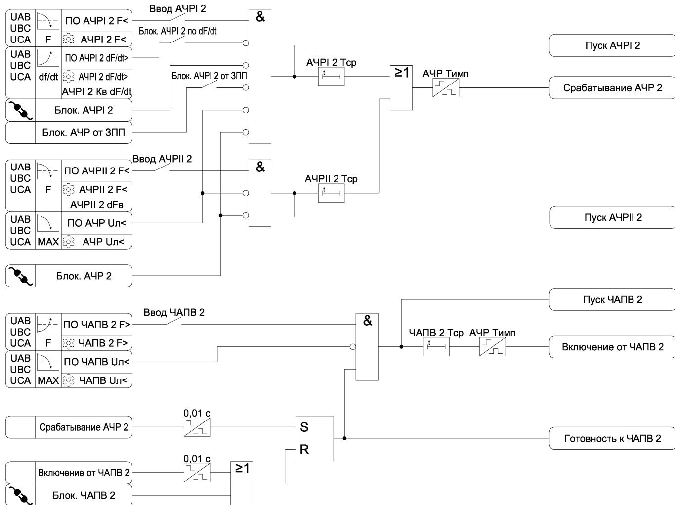
Рисунок 3.35 б) – Функциональные схемы алгоритмов АЧР и ЧАПВ
