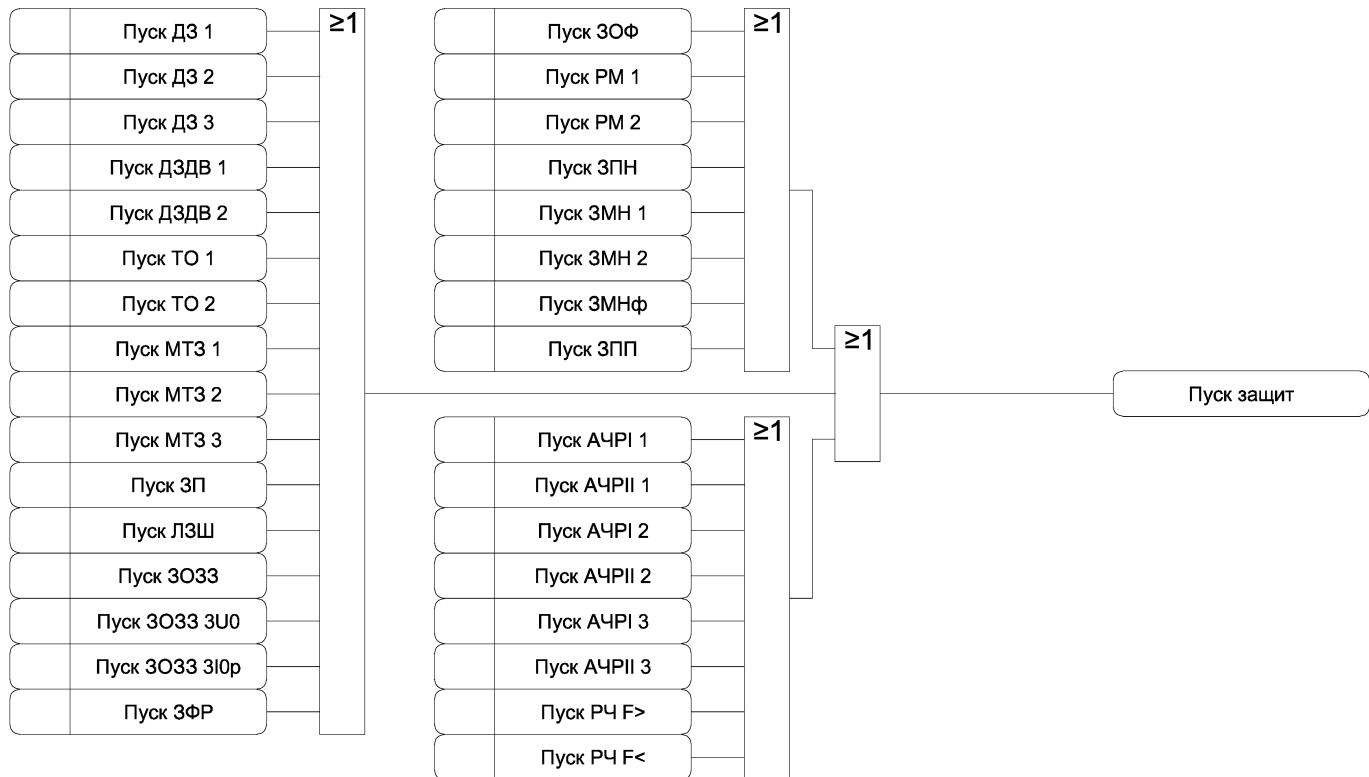
Рисунок 3.40 а) – Функциональная схема алгоритма формирования сигналов состояния защит
