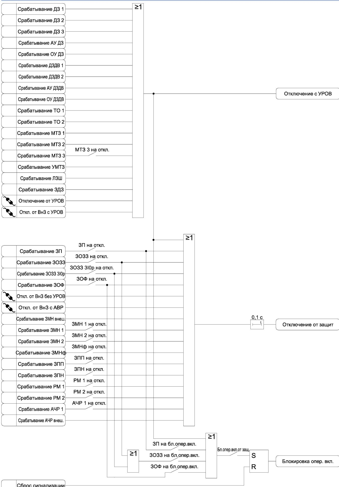
Рисунок 3.40 б) – Функциональная схема алгоритма формирования сигналов состояния защит
