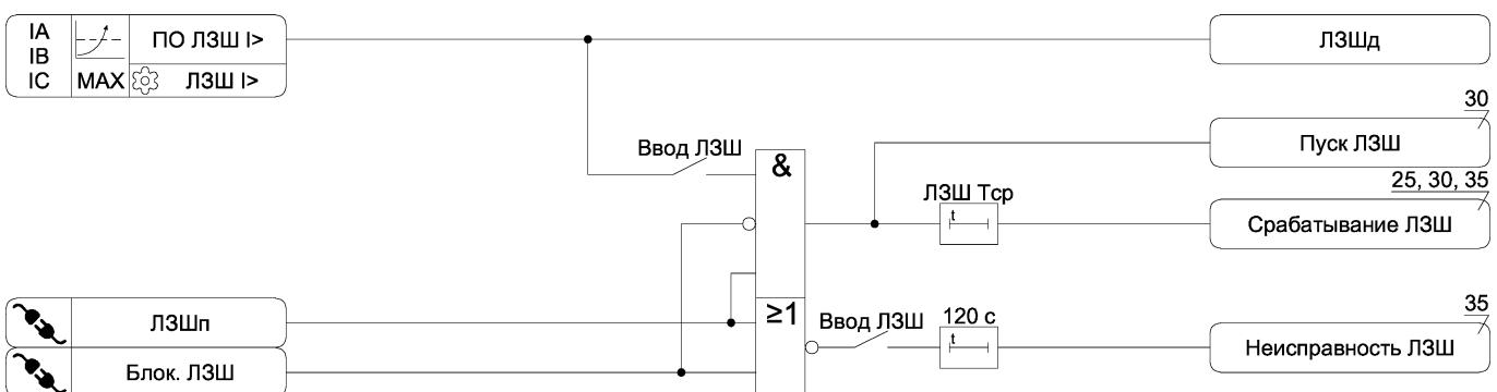
Рисунок А.11 – Функциональная схема алгоритма ЛЗШ
