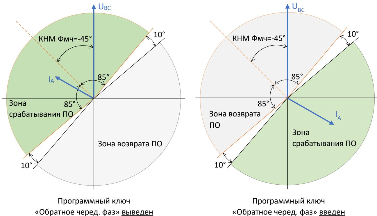
Рисунок 3.12 – Диаграмма срабатывания пускового органа функции КНМ
