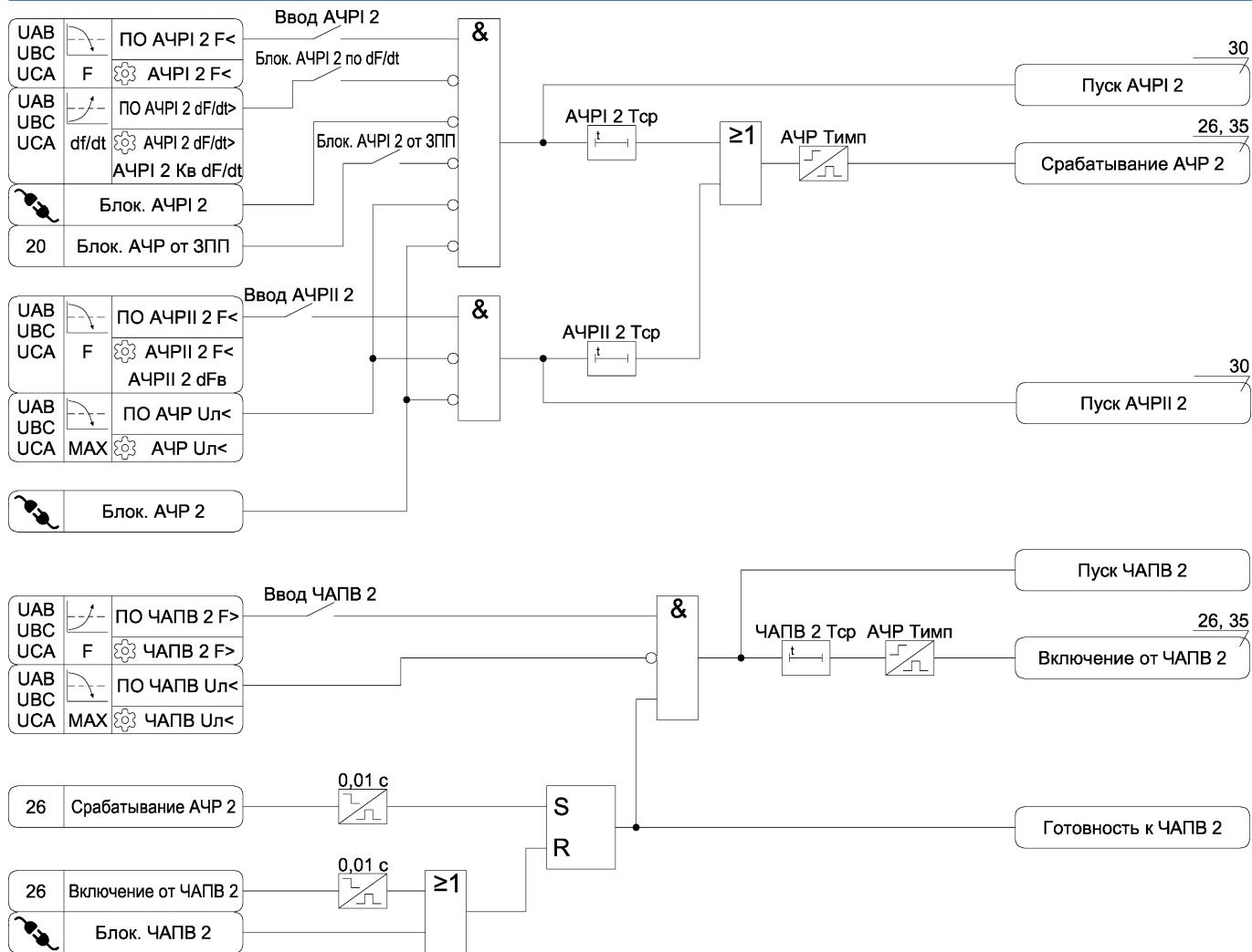
Рисунок А.26 б) – Функциональная схема алгоритма АЧР и ЧАПВ
