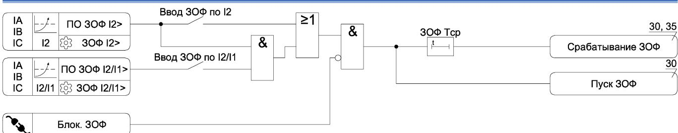
Рисунок А.15 – Функциональная схема алгоритма ЗОФ
