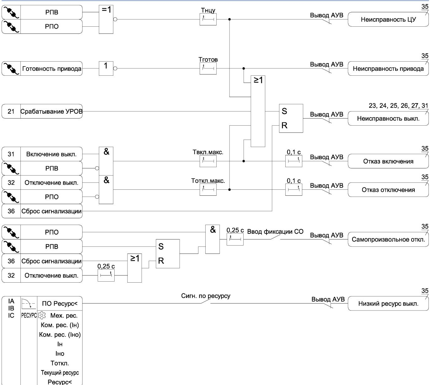
Рисунок А.33 – Функциональная схема алгоритма диагностики выключателя
