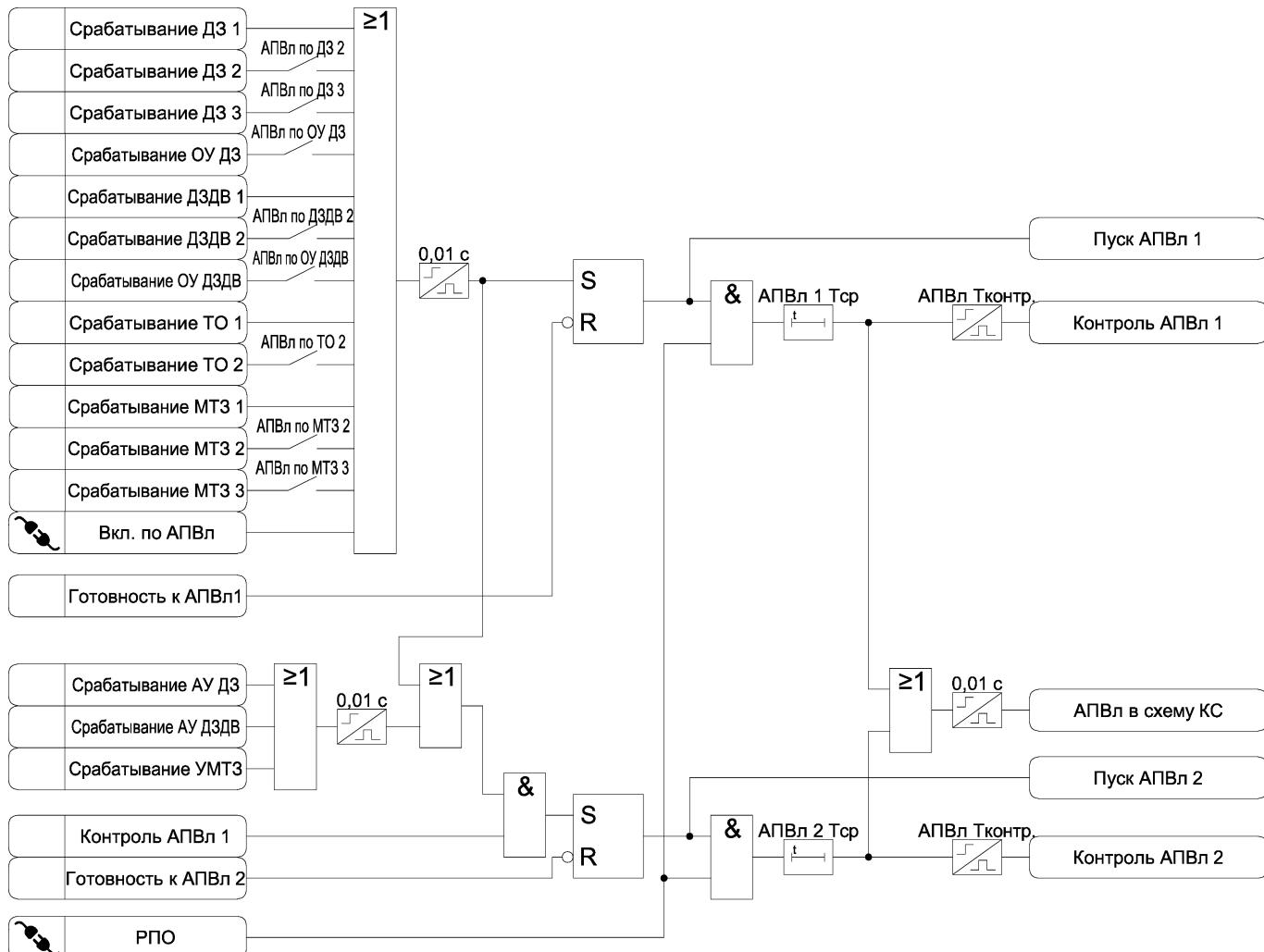
Рисунок 3.34 а) – Функциональная схема алгоритма АПВ
