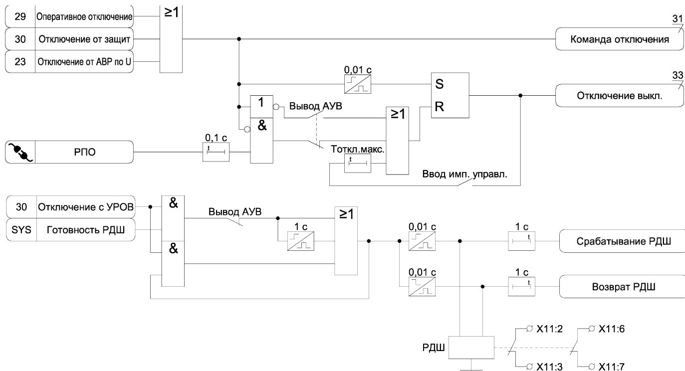
Рисунок А.32 – Функциональная схема алгоритма отключения выключателя
