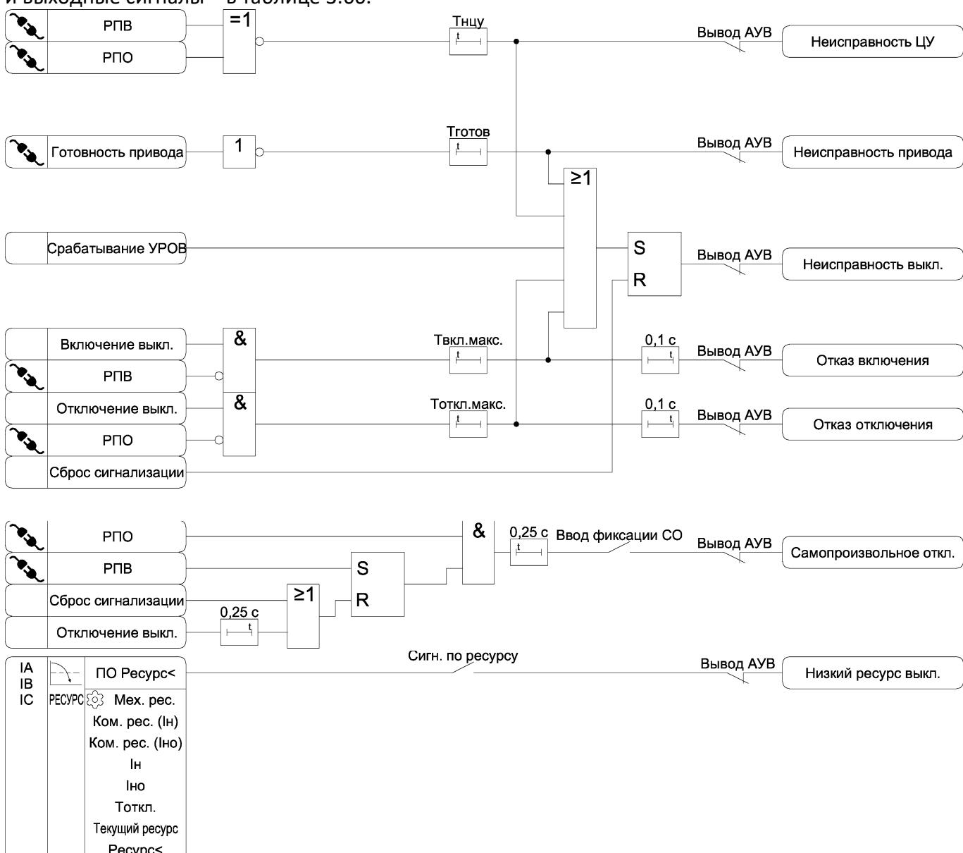
Рисунок 3.42 – Функциональная схема алгоритма диагностики выключателя
