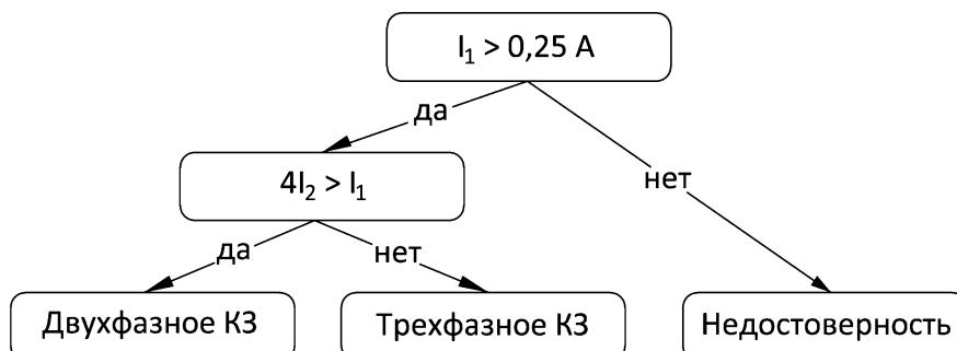
Рисунок 3.46 – Блок-схема определения вида короткого замыкания
