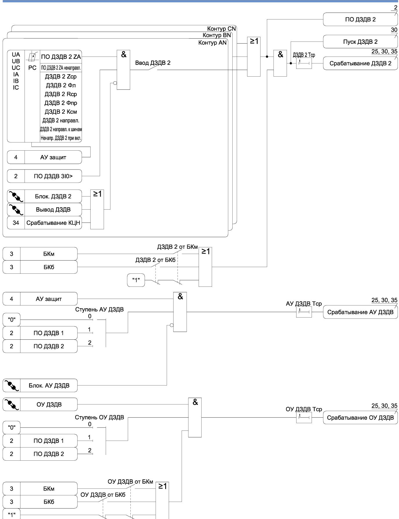
Рисунок А.2 б) – Функциональная схема алгоритма ДЗДВ
