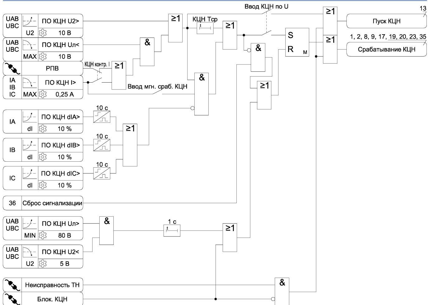
Рисунок А.34 – Функциональная схема алгоритма КЧН
