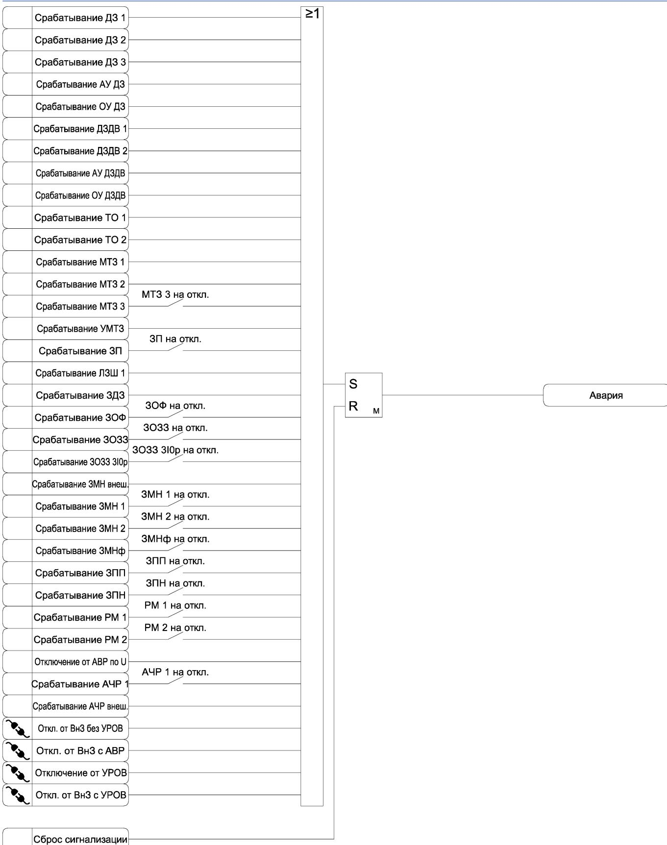
Рисунок 3.44 б) – Функциональная схема алгоритма сигнализации
