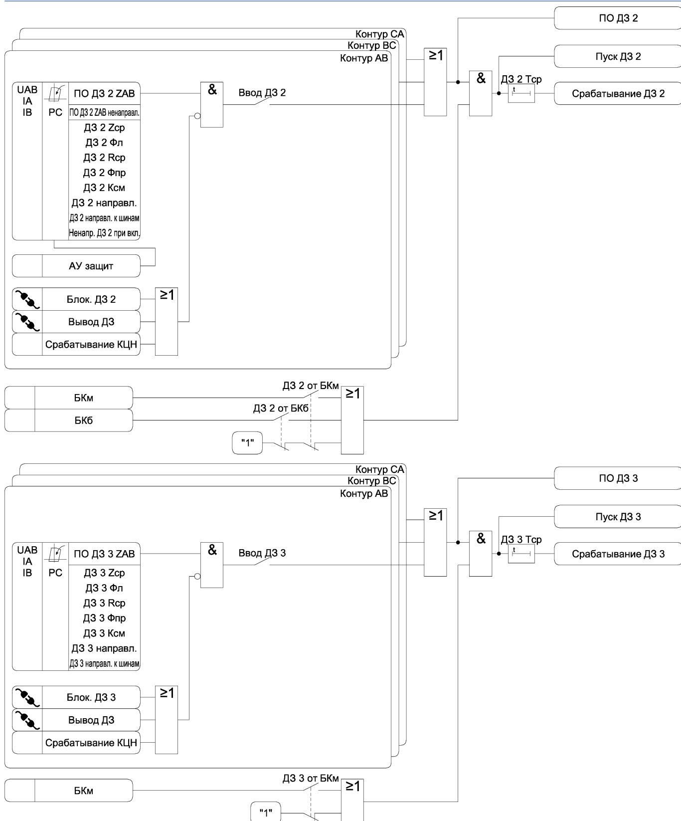
Рисунок 3.1 б) – Функциональная схема алгоритма ДЗ
