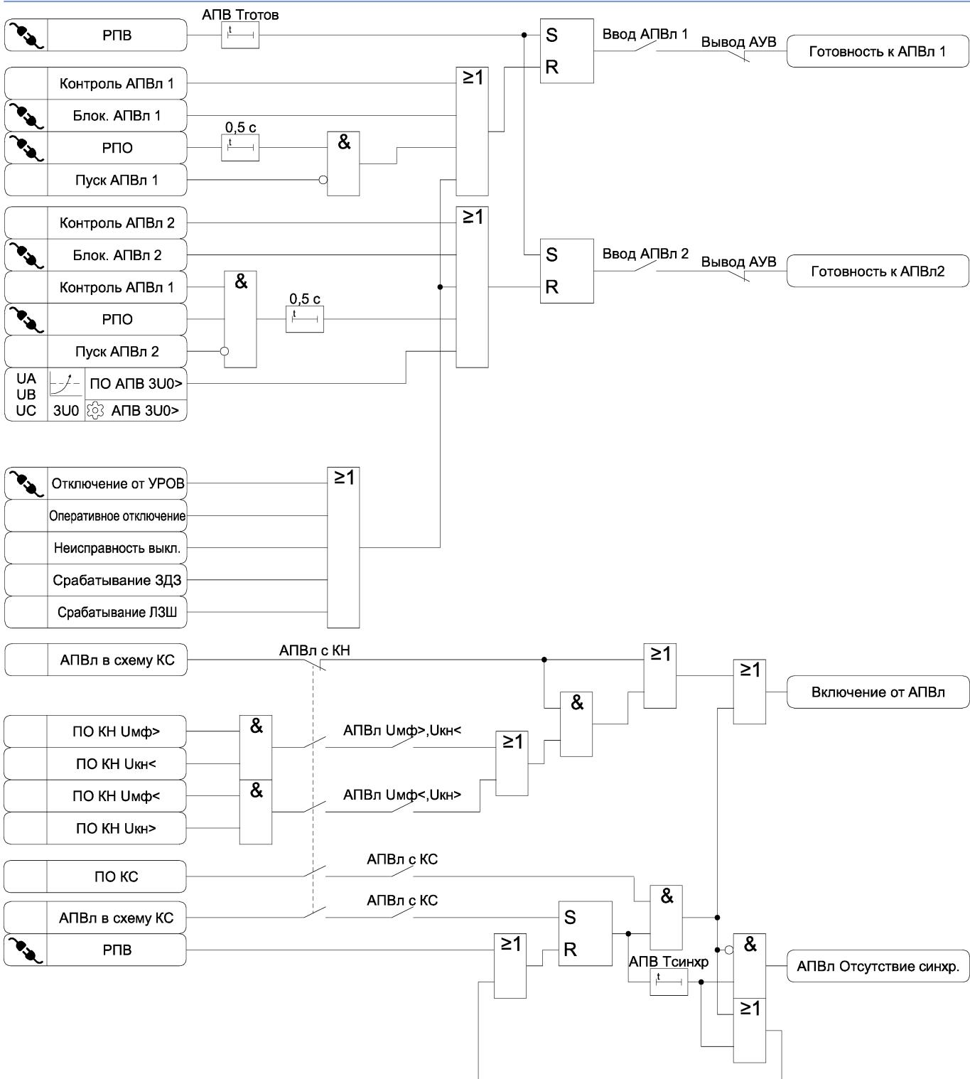
Рисунок 3.34 б) – Функциональная схема алгоритма АПВ
