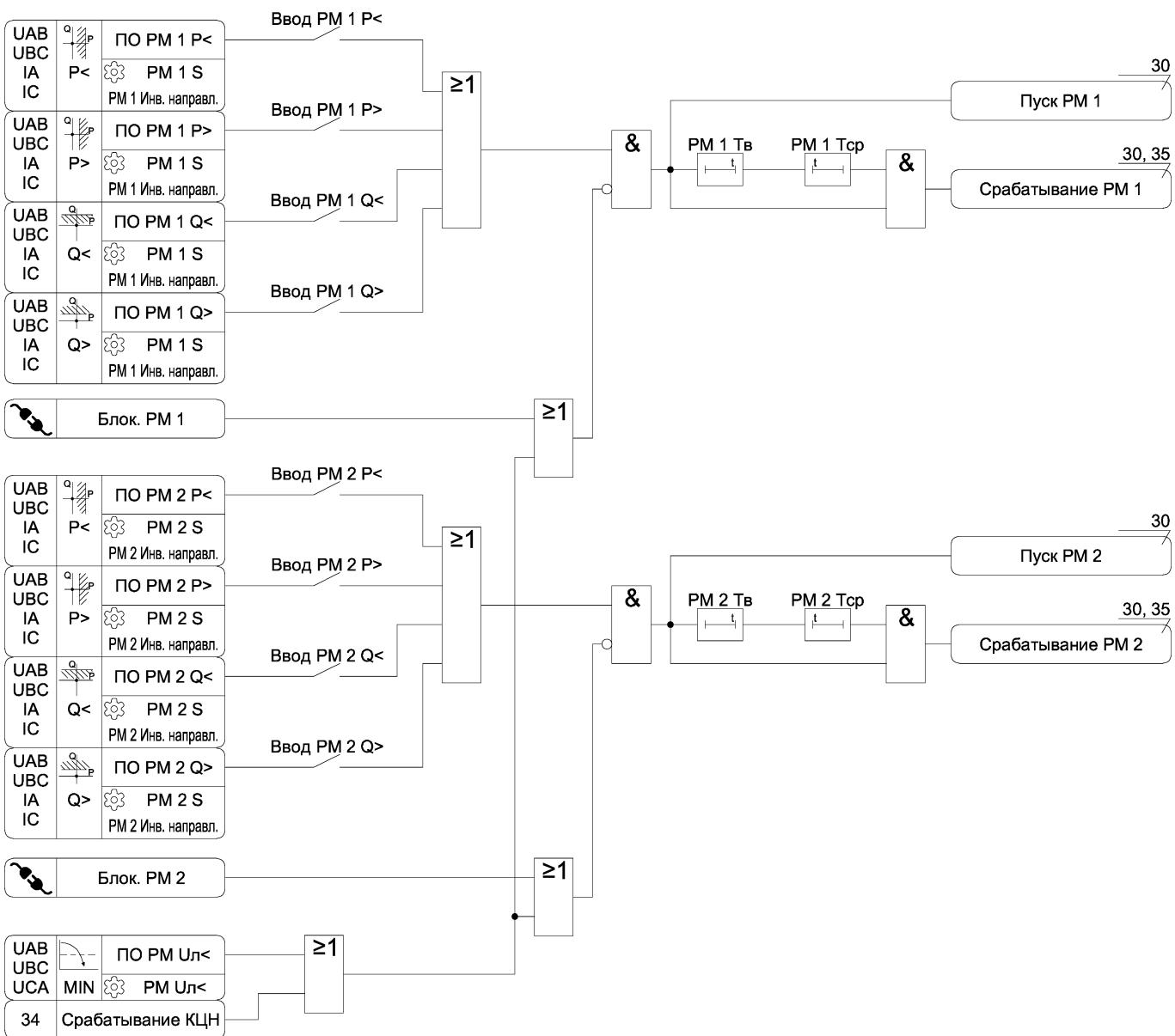
Рисунок А.17 – Функциональная схема алгоритма защиты по направлению мощности
