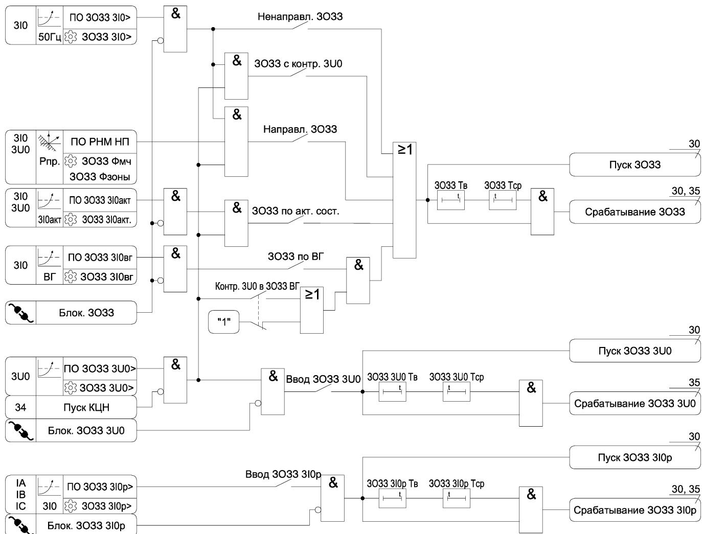
Рисунок А.13 – Функциональная схема алгоритма ЗО33
