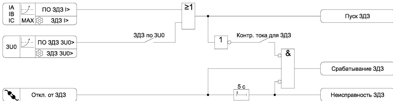
Рисунок 3.16 – Функциональная схема алгоритма ЗДЗ
