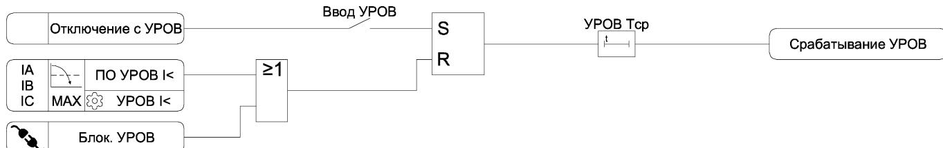
Рисунок 3.28 – Функциональная схема алгоритма УРОВ
