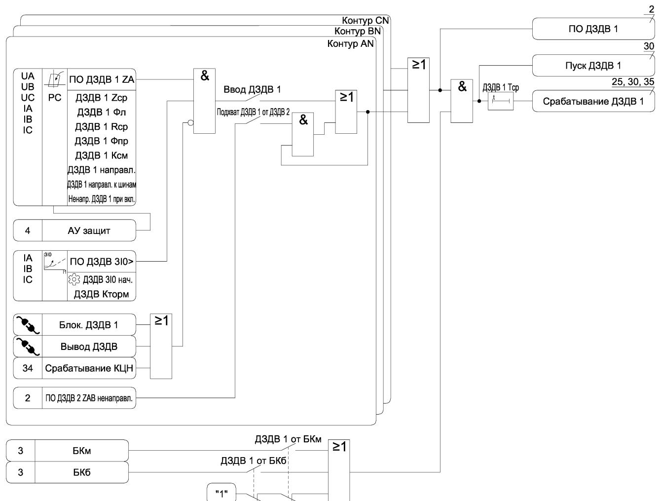
Рисунок А.2 а) – Функциональная схема алгоритма ДЗДВ
