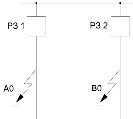
Рисунок 1.2 - Пример двойного замыкания на землю
