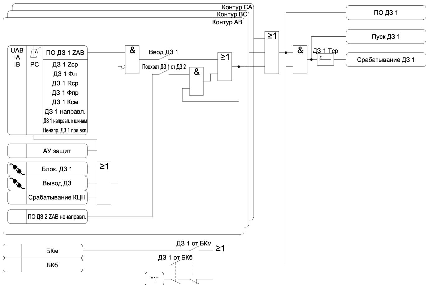
Рисунок 3.1 а) – Функциональная схема алгоритма ДЗ
