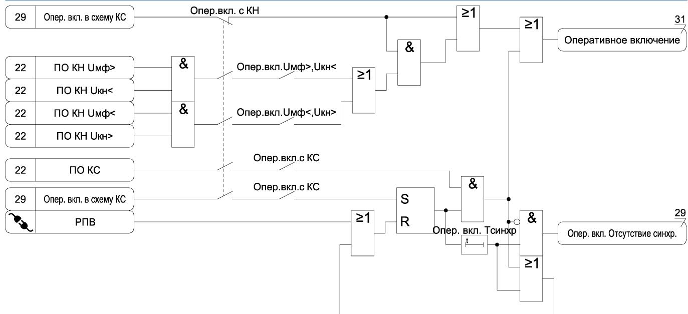
Рисунок А.29 б) – Функциональная схема алгоритма оперативного управления выключателем
