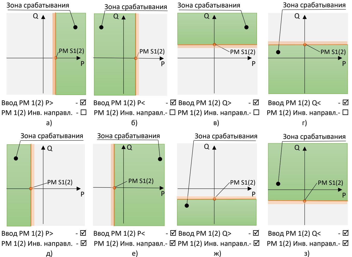
Рисунок 3.24 – Диаграмма срабатывания реле активного тока нулевой последовательности
