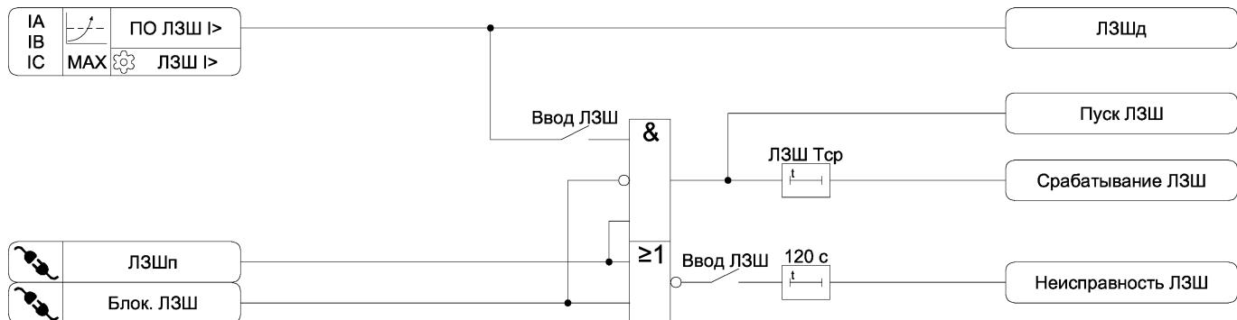
Рисунок 3.15 – Функциональная схема алгоритма ЛЗШ
