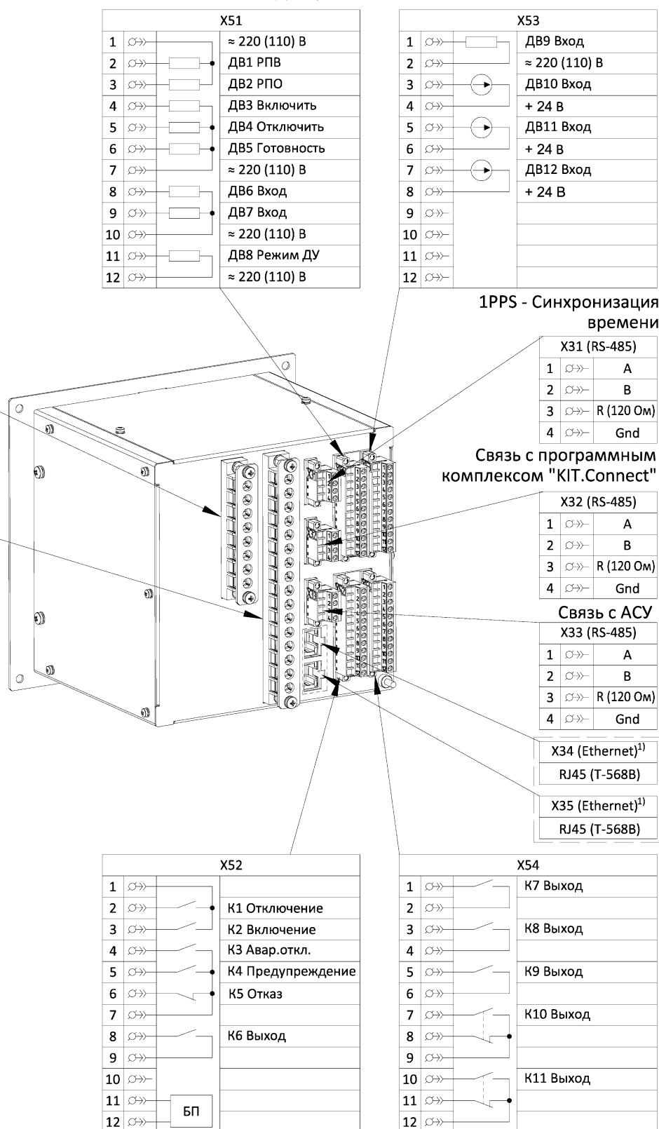
Рисунок 2.1 – Схема подключения устройства
