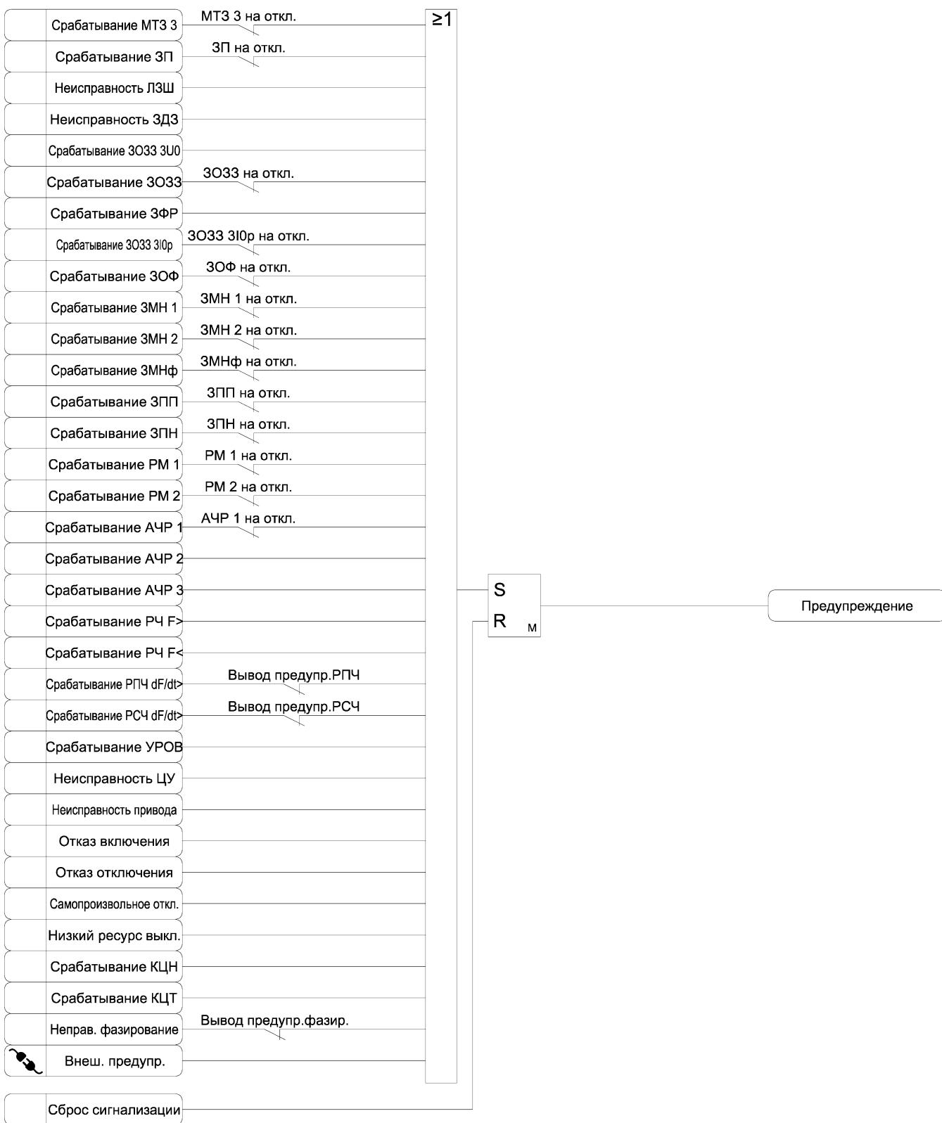
Рисунок 3.44 в) – Функциональная схема алгоритма сигнализации
