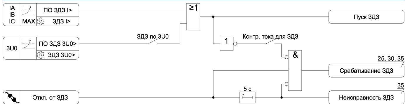
Рисунок А.12 – Функциональная схема алгоритма ЗДЗ
