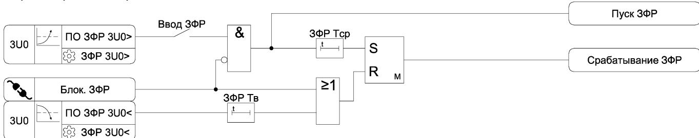
Рисунок 3.20 – Функциональная схема алгоритма ЗФР
