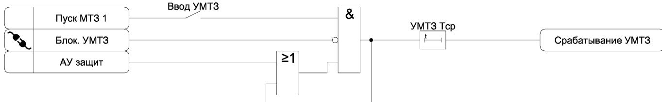
Рисунок 3.10 – Функциональная схема алгоритма УМТЗ
