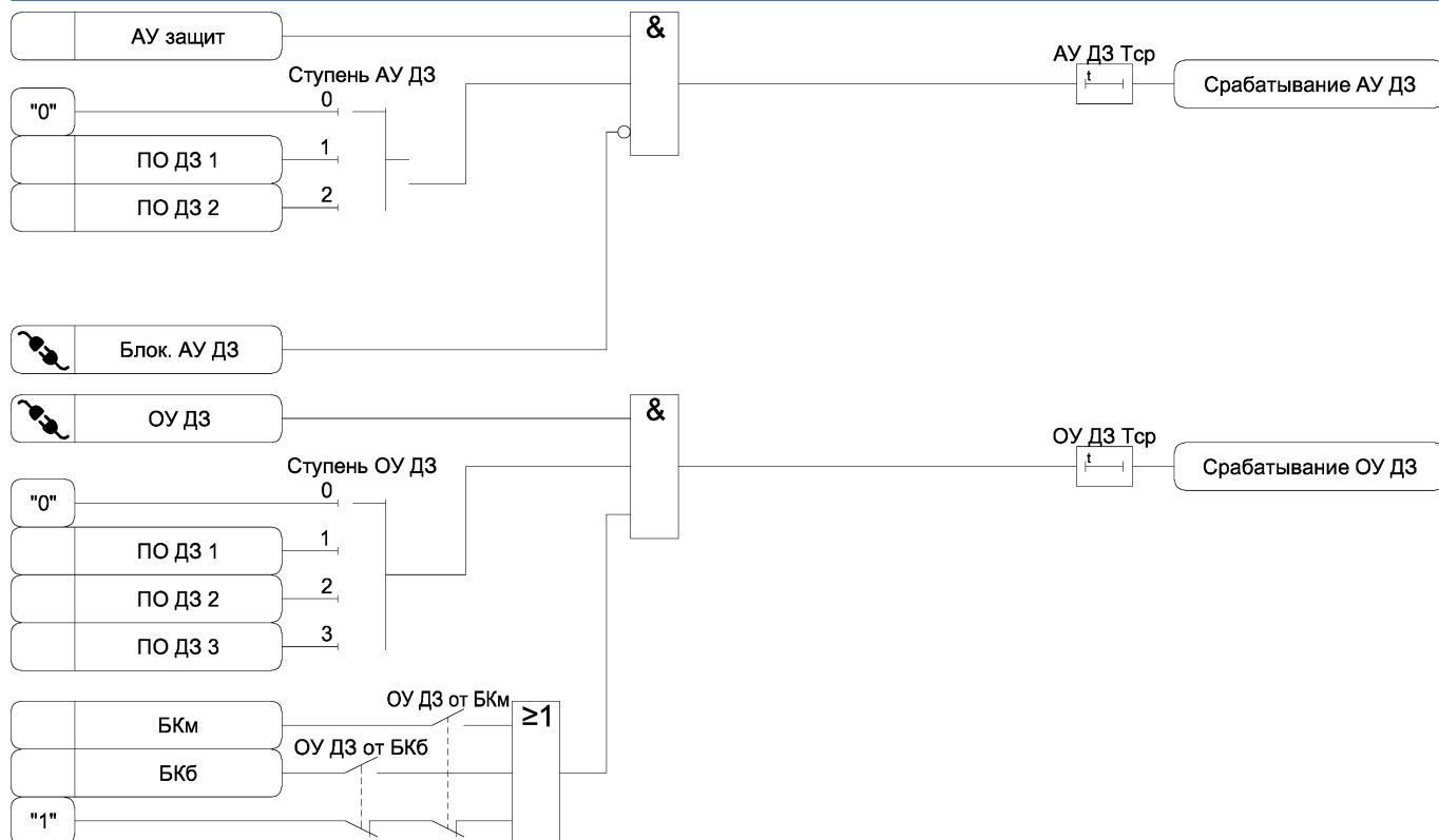
Рисунок 3.1 в) – Функциональная схема алгоритма ДЗ
