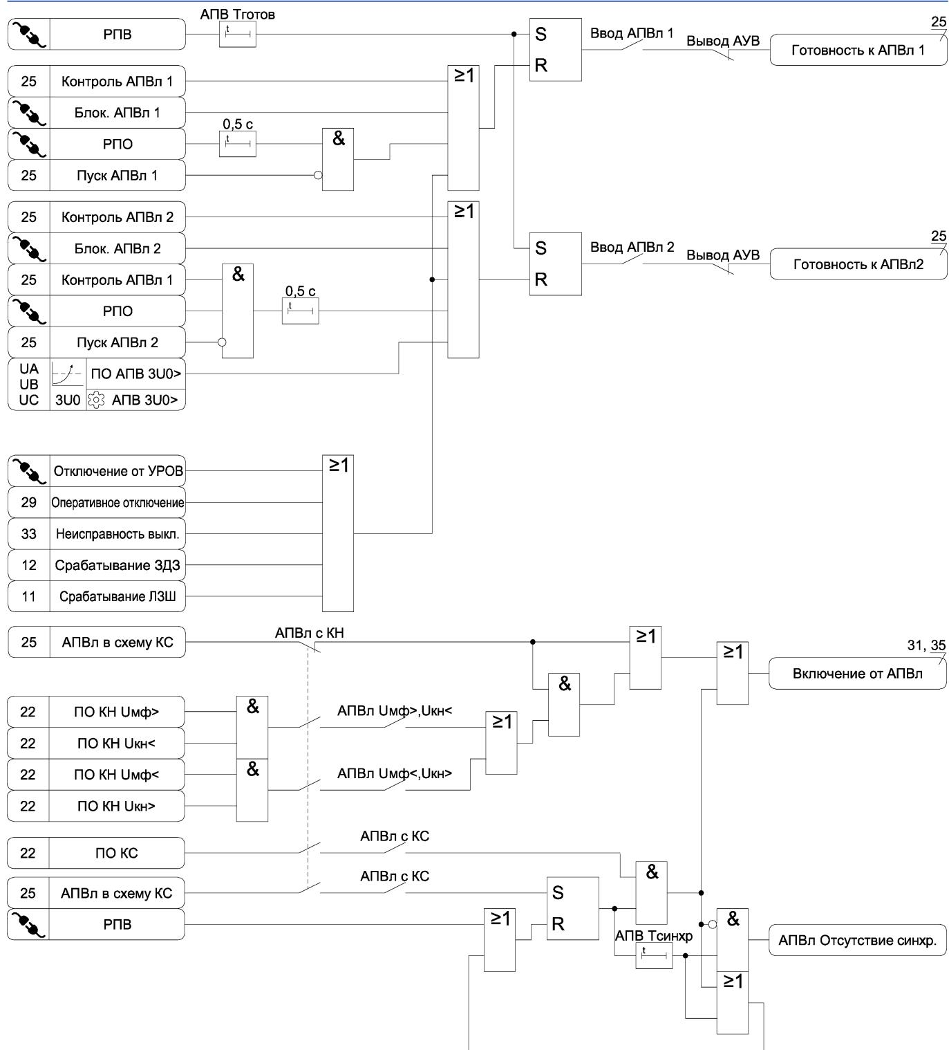
Рисунок А.25 б) – Функциональная схема алгоритма АПВ
