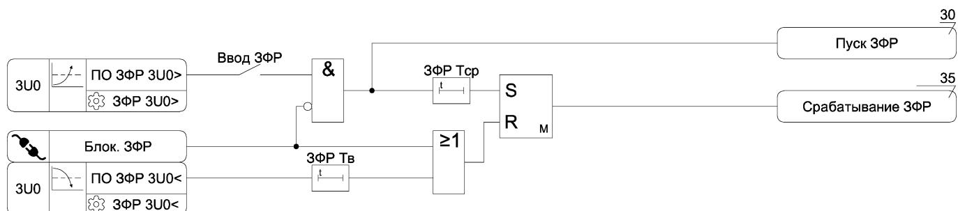
Рисунок А.14 – Функциональная схема алгоритма ЗФР
