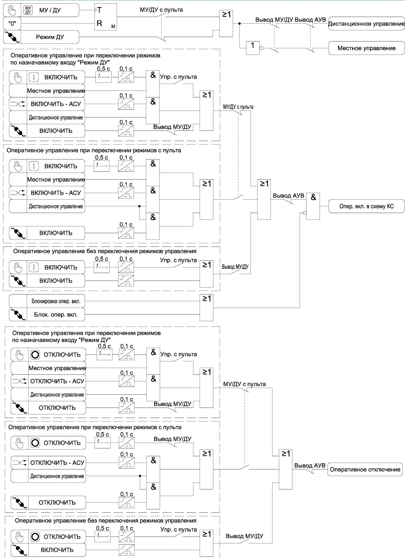
Рисунок 3.38 а) – Функциональная схема алгоритма оперативного управления выключателем
