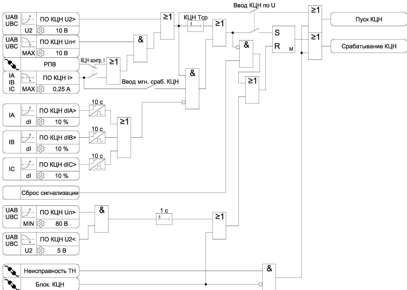
Рисунок 3.43 – Функциональная схема алгоритма КЦН
