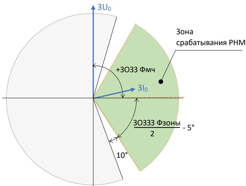
Рисунок 3.18 – Диаграмма срабатывания реле направления мощности нулевой последовательности
