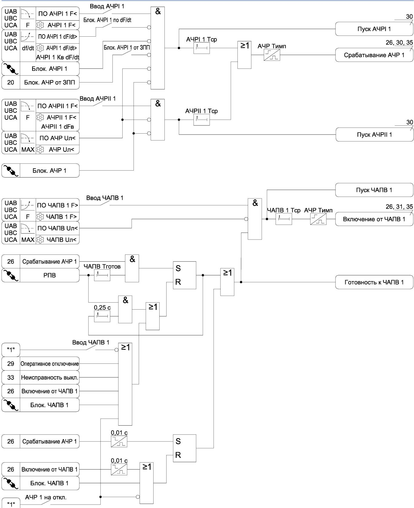
Рисунок А.26 а) – Функциональная схема алгоритма АЧР и ЧАПВ
