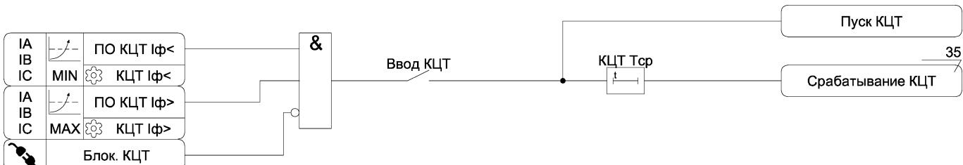
Рисунок А.16 – Функциональная схема алгоритма КЦТ
