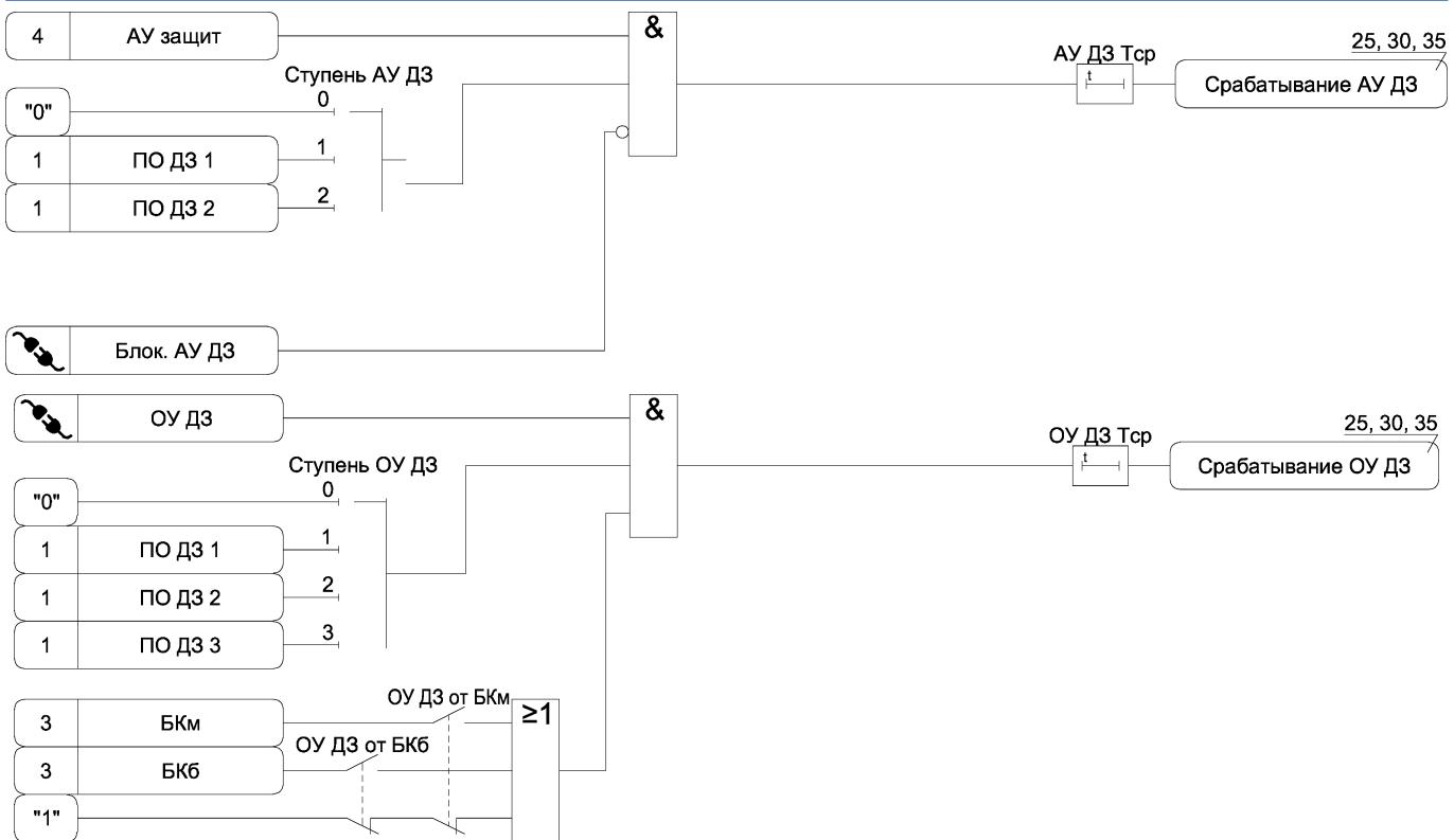
Рисунок А.1 в) – Функциональная схема алгоритма ДЗ
