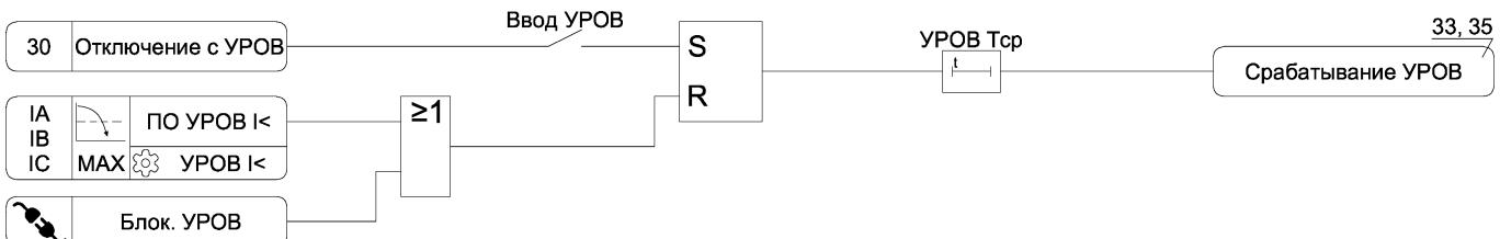
Рисунок А.21 – Функциональная схема алгоритма УРОВ
