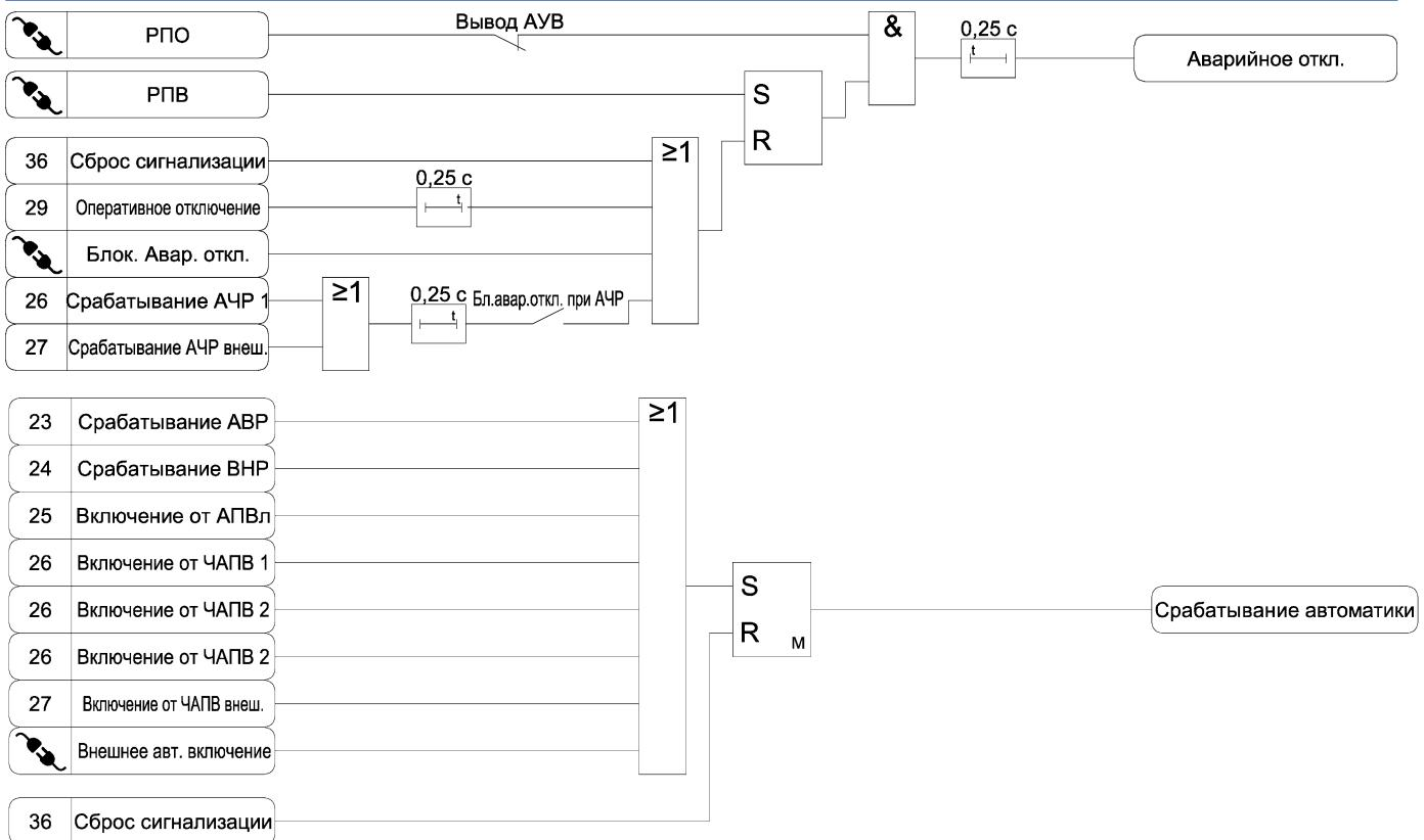
Рисунок А.35 а) – Функциональная схема алгоритма сигнализации
