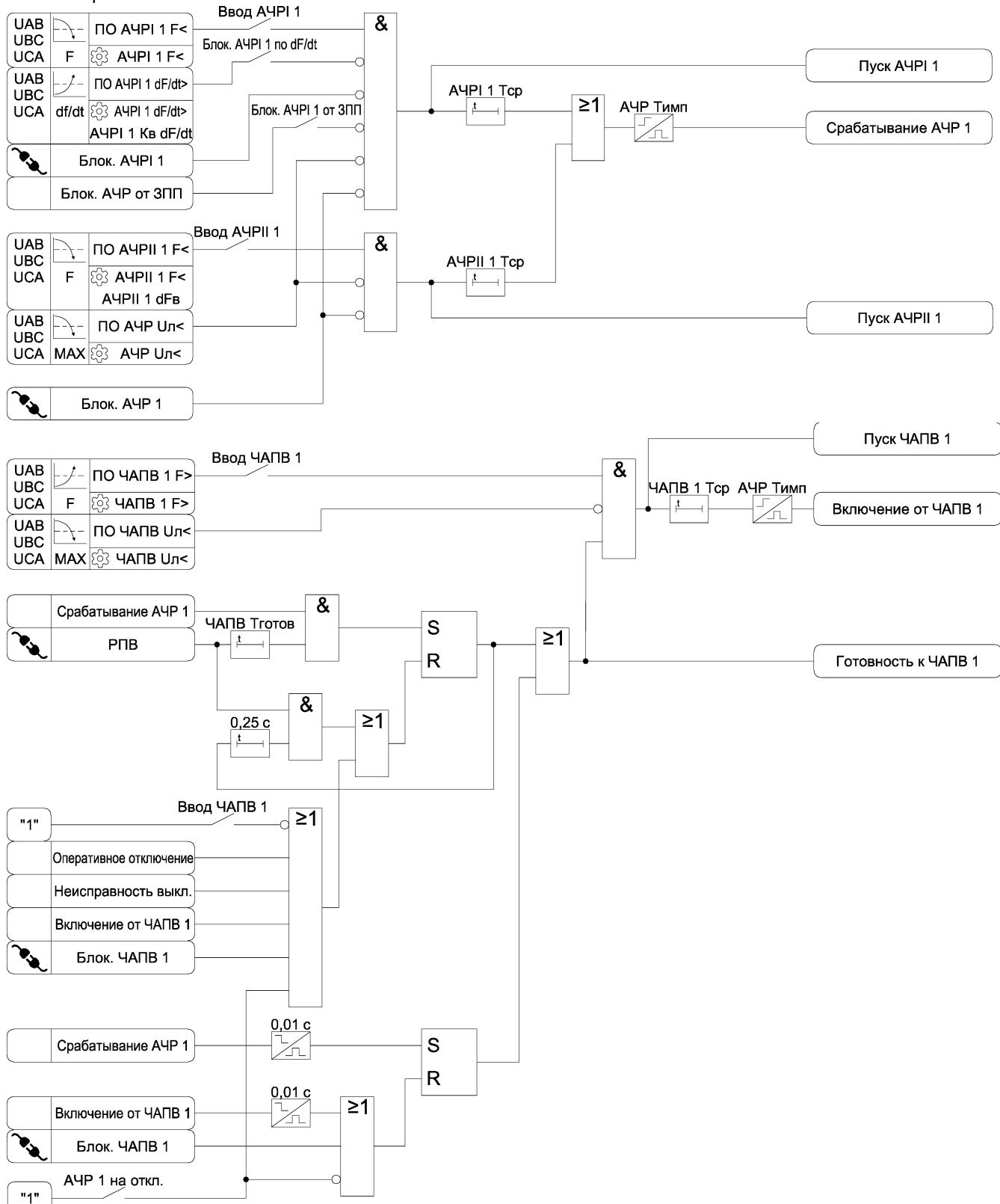
Рисунок 3.35 а) – Функциональные схемы алгоритмов АЧР и ЧАПВ
