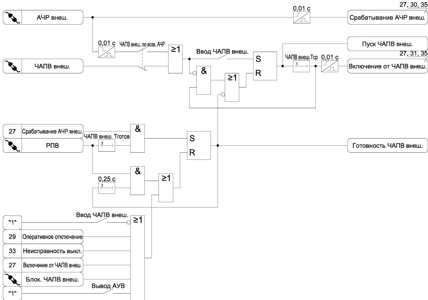
Рисунок А.27 – Функциональная схема алгоритма АЧР и ЧАПВ от внешнего устройства
