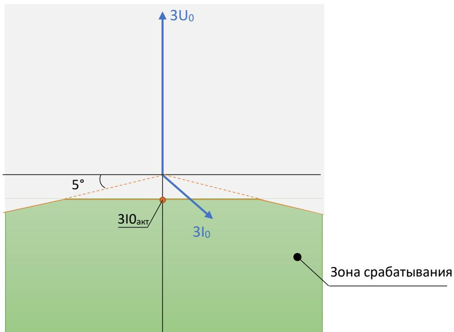
Рисунок 3.19 – Диаграмма срабатывания реле активного тока нулевой последовательности
