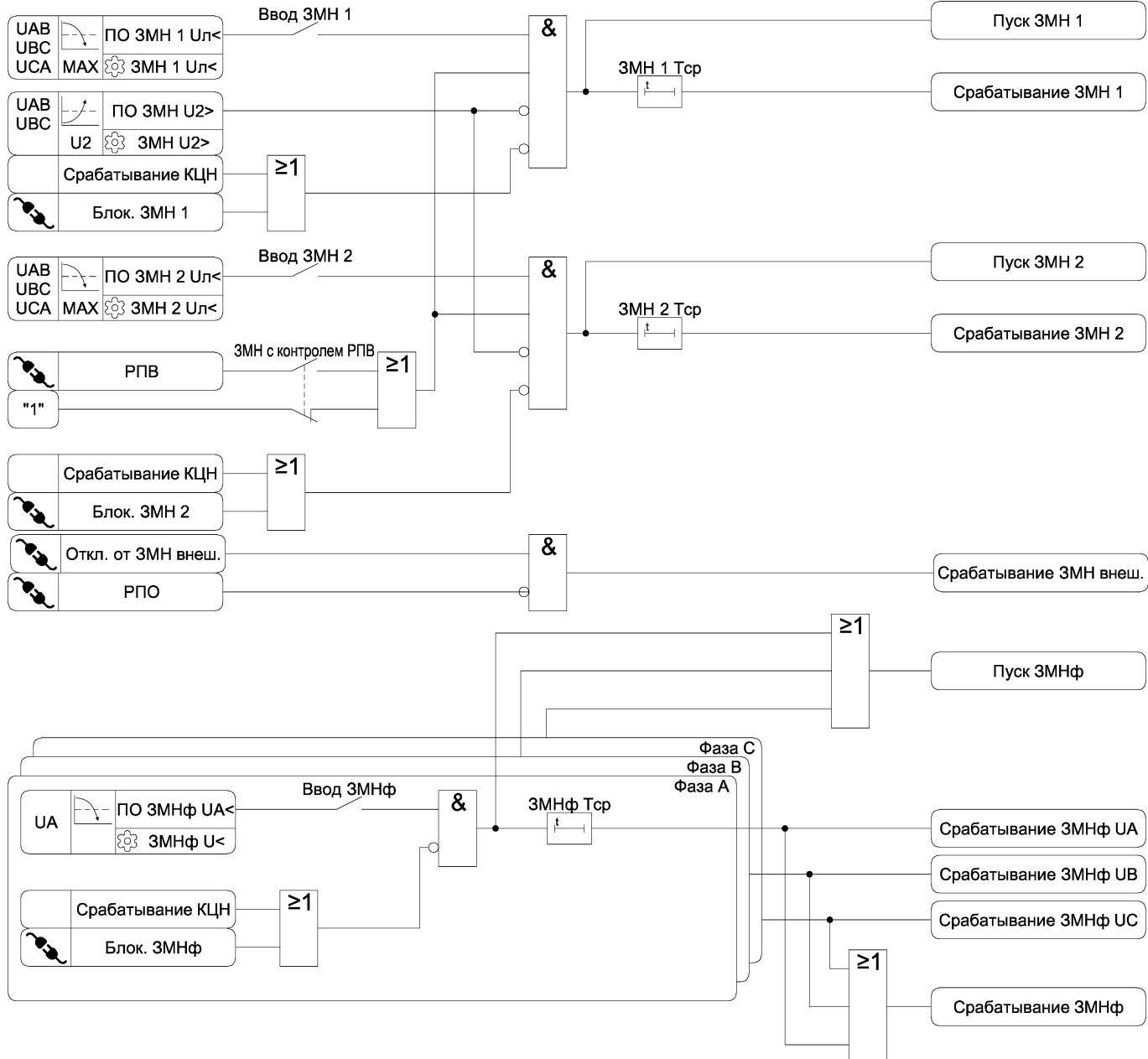
Рисунок 3.26 – Функциональная схема алгоритма ЗМН
