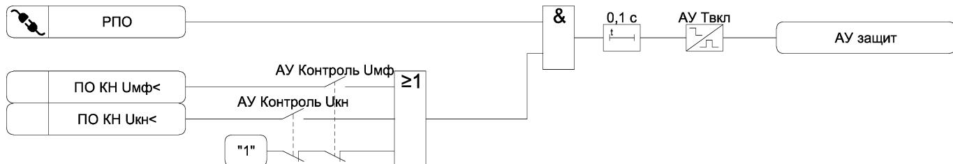
Рисунок 3.7 – Функциональная схема алгоритма автоматического ускорения защит
