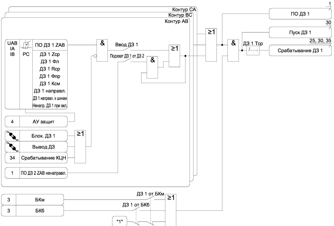
Рисунок А.1 а) – Функциональная схема алгоритма ДЗ
