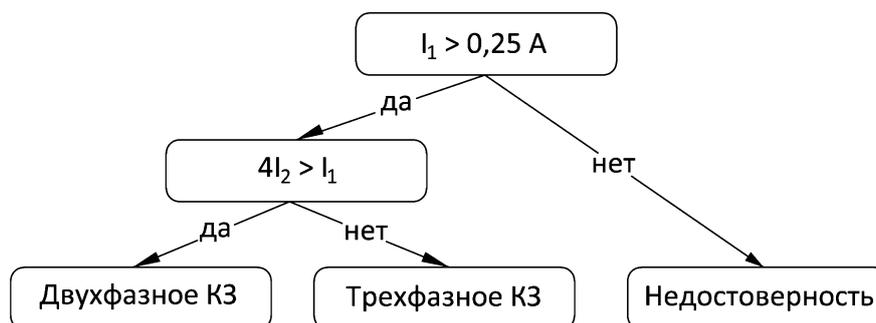
Рисунок 3.23 – Блок-схема определения вида короткого замыкания
