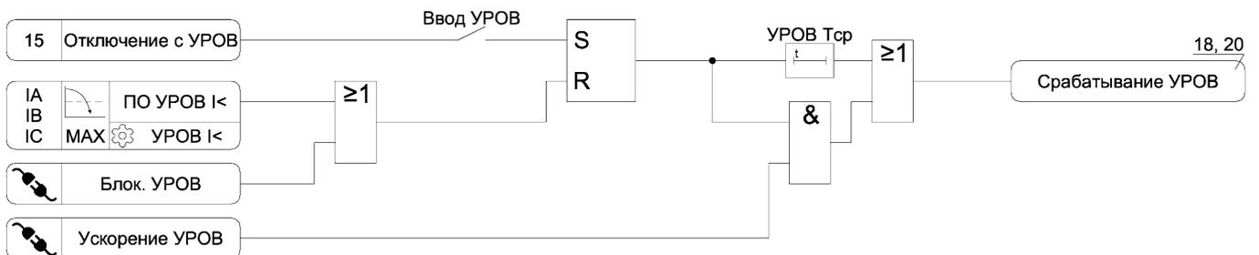
Рисунок А.11 – Функциональная схема алгоритма УРОВ
