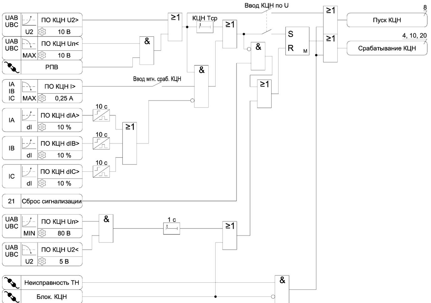
Рисунок А.19 – Функциональная схема алгоритма КЦН
