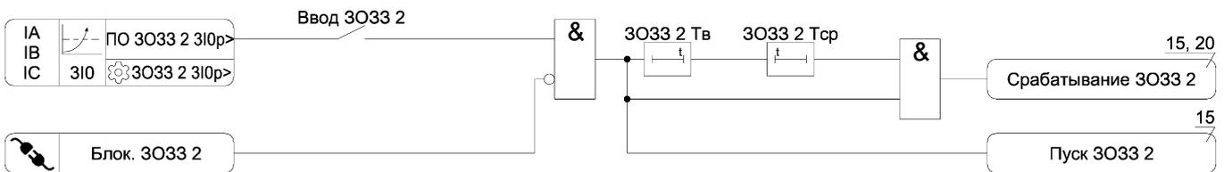
Рисунок А.8 – Функциональная схема алгоритма ЗОЗЗ
