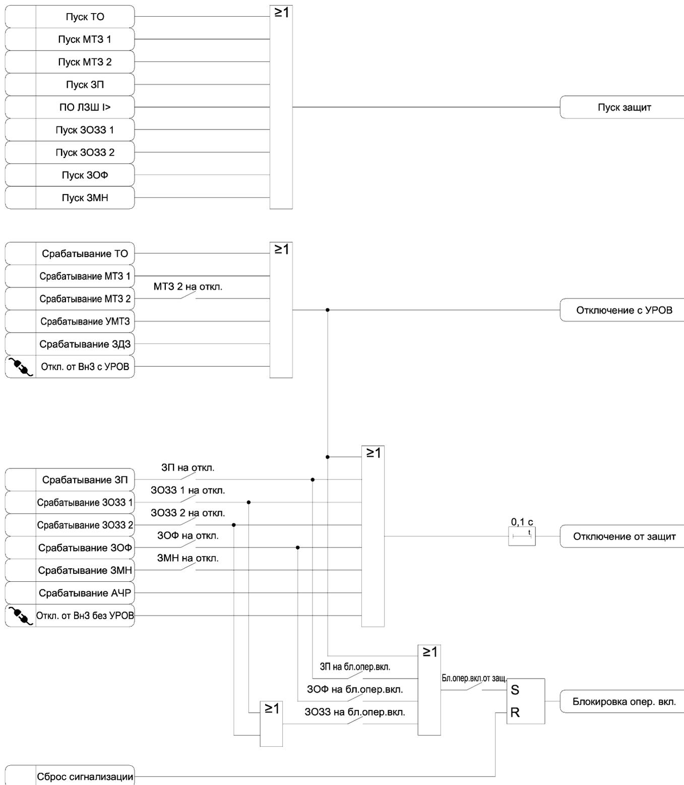
Рисунок 3.17 – Функциональная схема алгоритма формирования сигналов состояния защит
