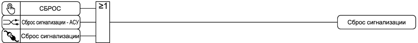
Рисунок 3.22 – Функциональная схема алгоритма сброса сигнализации
