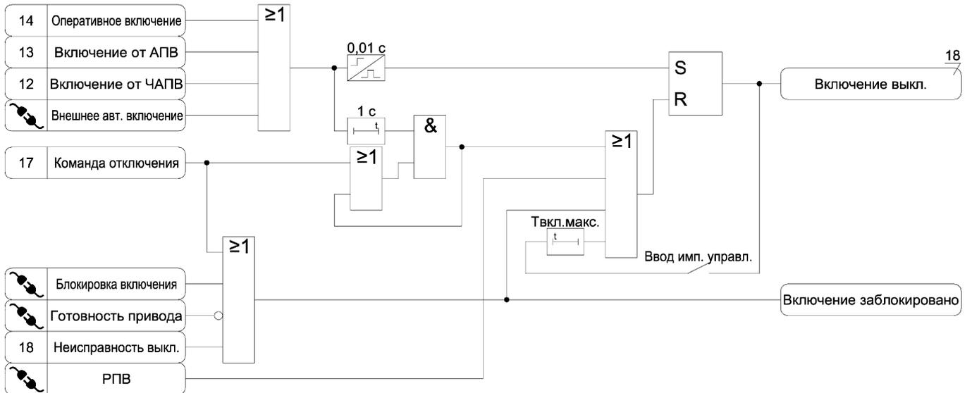
Рисунок А.16 – Функциональная схема алгоритма включения выключателя
