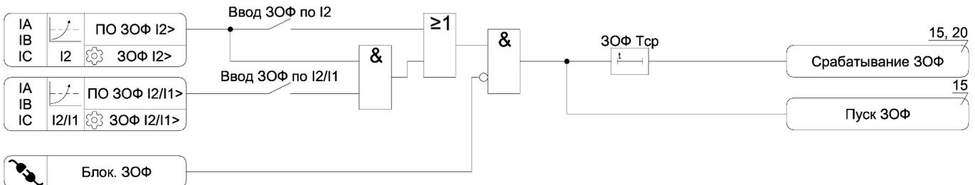
Рисунок А.9 – Функциональная схема алгоритма ЗОФ
