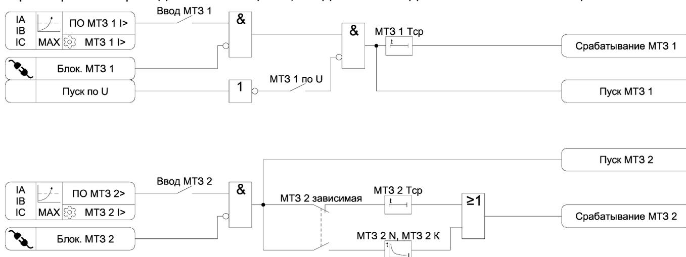
Рисунок 3.2 – Функциональная схема алгоритма МТЗ
