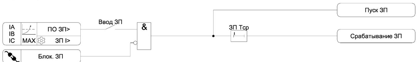
Рисунок 3.5 – Функциональная схема алгоритма ЗП
