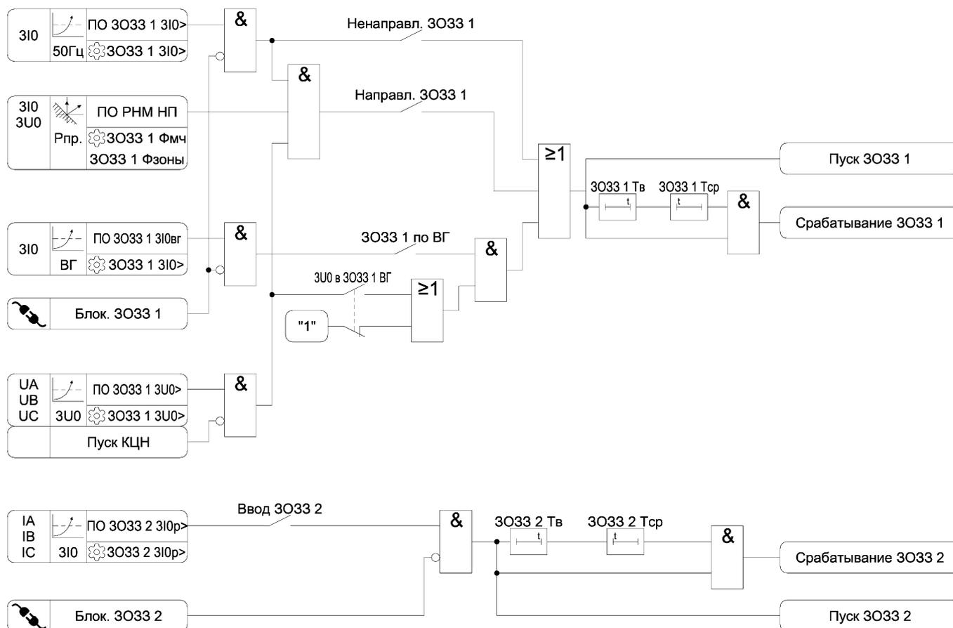
Рисунок 3.8 – Функциональная схема алгоритма ЗОЗЗ
