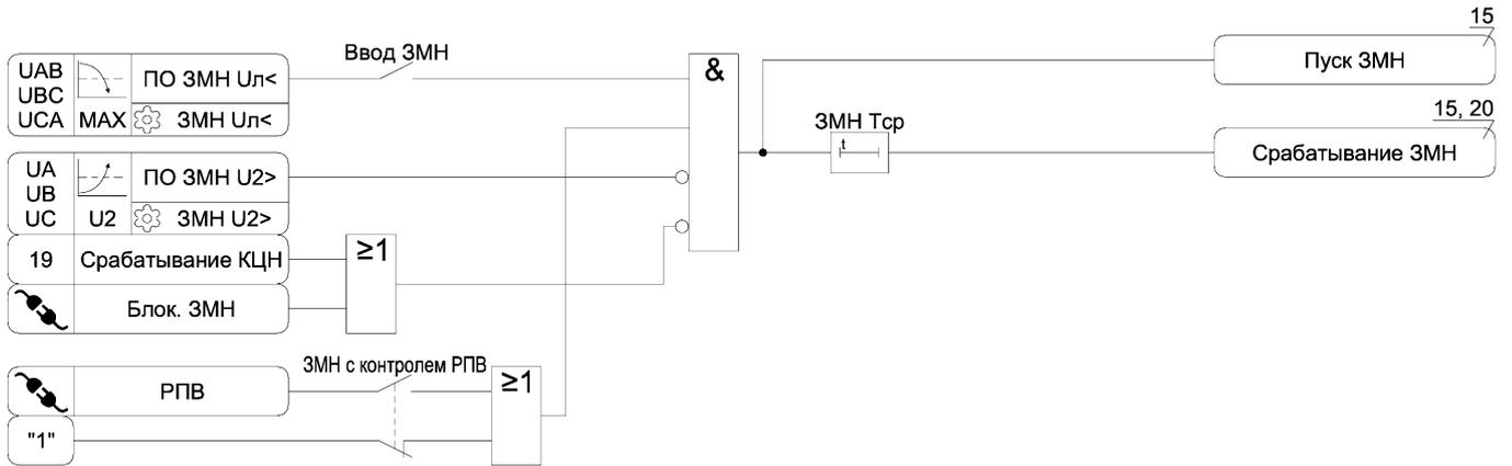
Рисунок А.10 – Функциональная схема алгоритма ЗМН
