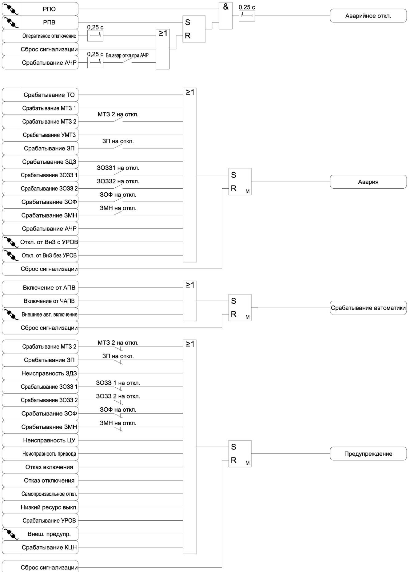
Рисунок 3.21 – Функциональная схема алгоритма сигнализации
