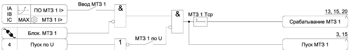
**Рисунок А.2 – Функциональная схема алгоритма МТЗ**
