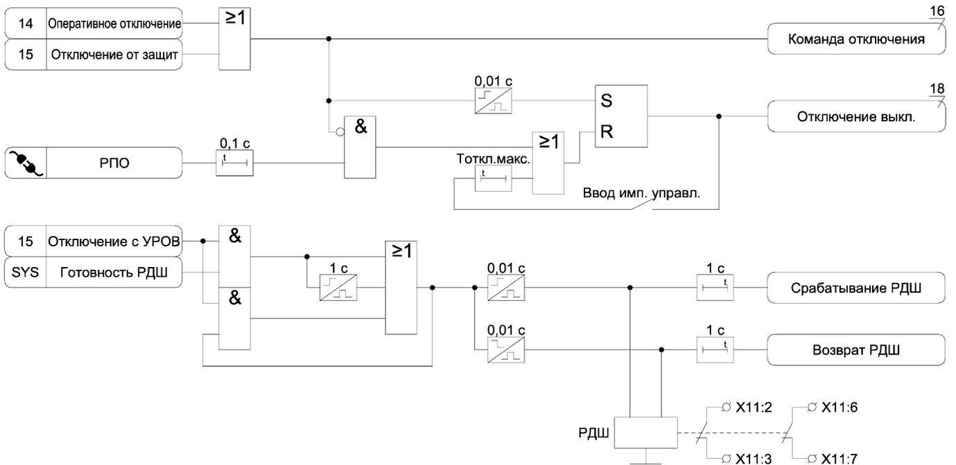
Рисунок А.17 – Функциональная схема алгоритма отключения выключателя
