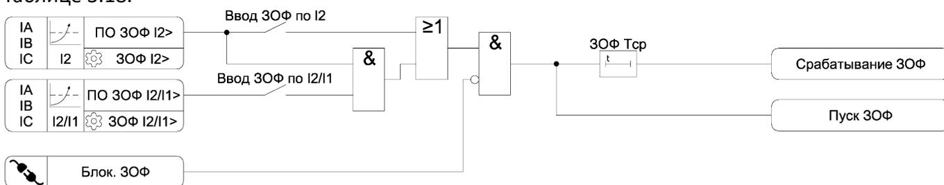
Рисунок 3.10 – Функциональная схема алгоритма 3ОФ
