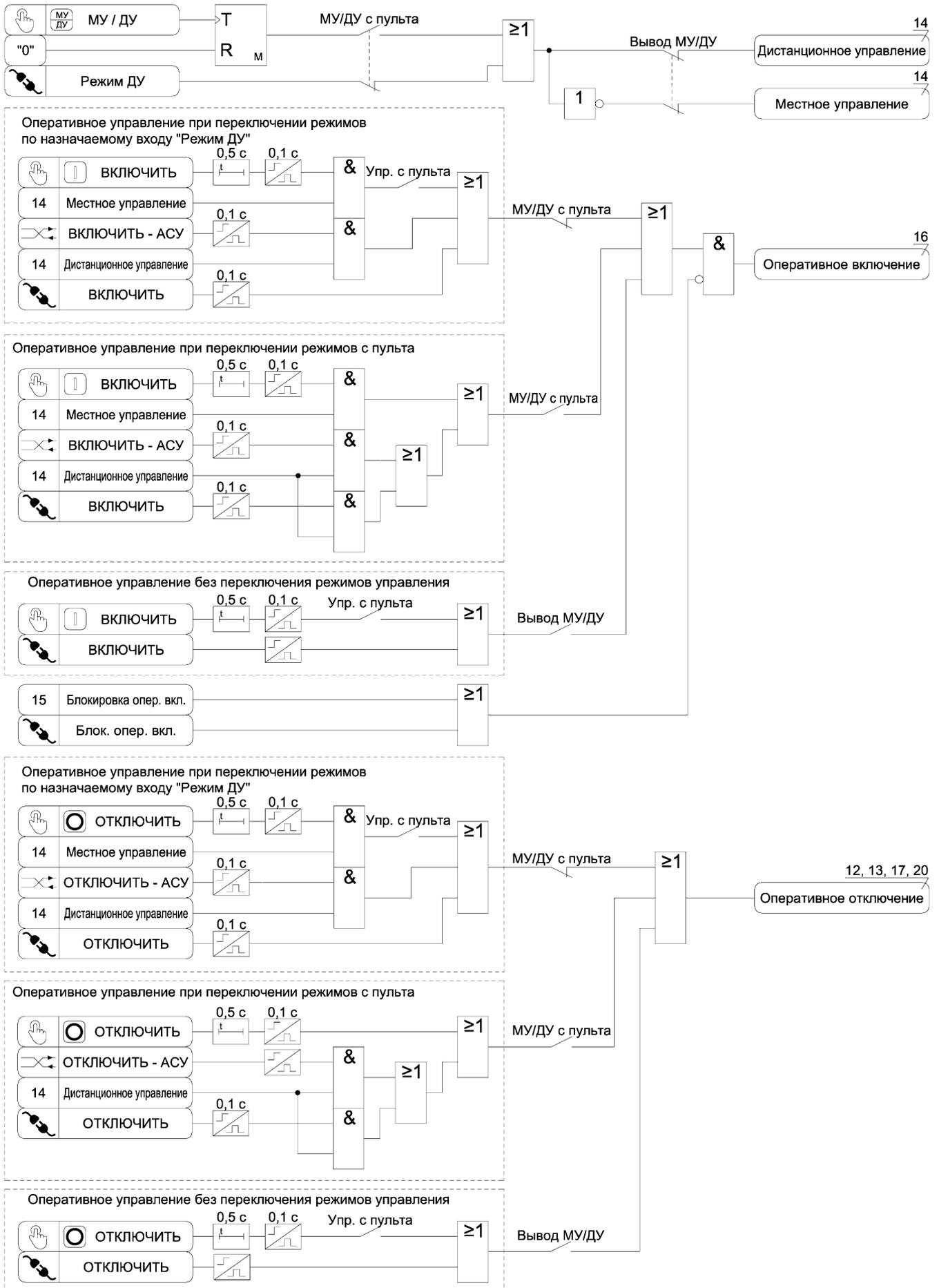
Рисунок А.14 – Функциональная схема алгоритма оперативного управления выключателем
