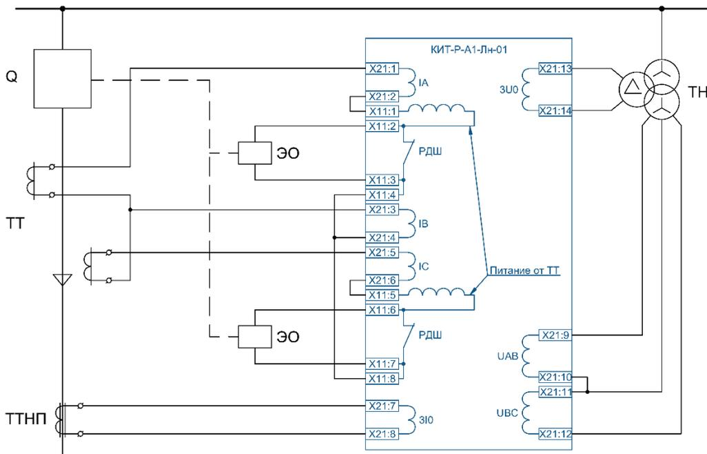
б) схема с двумя ТТ
