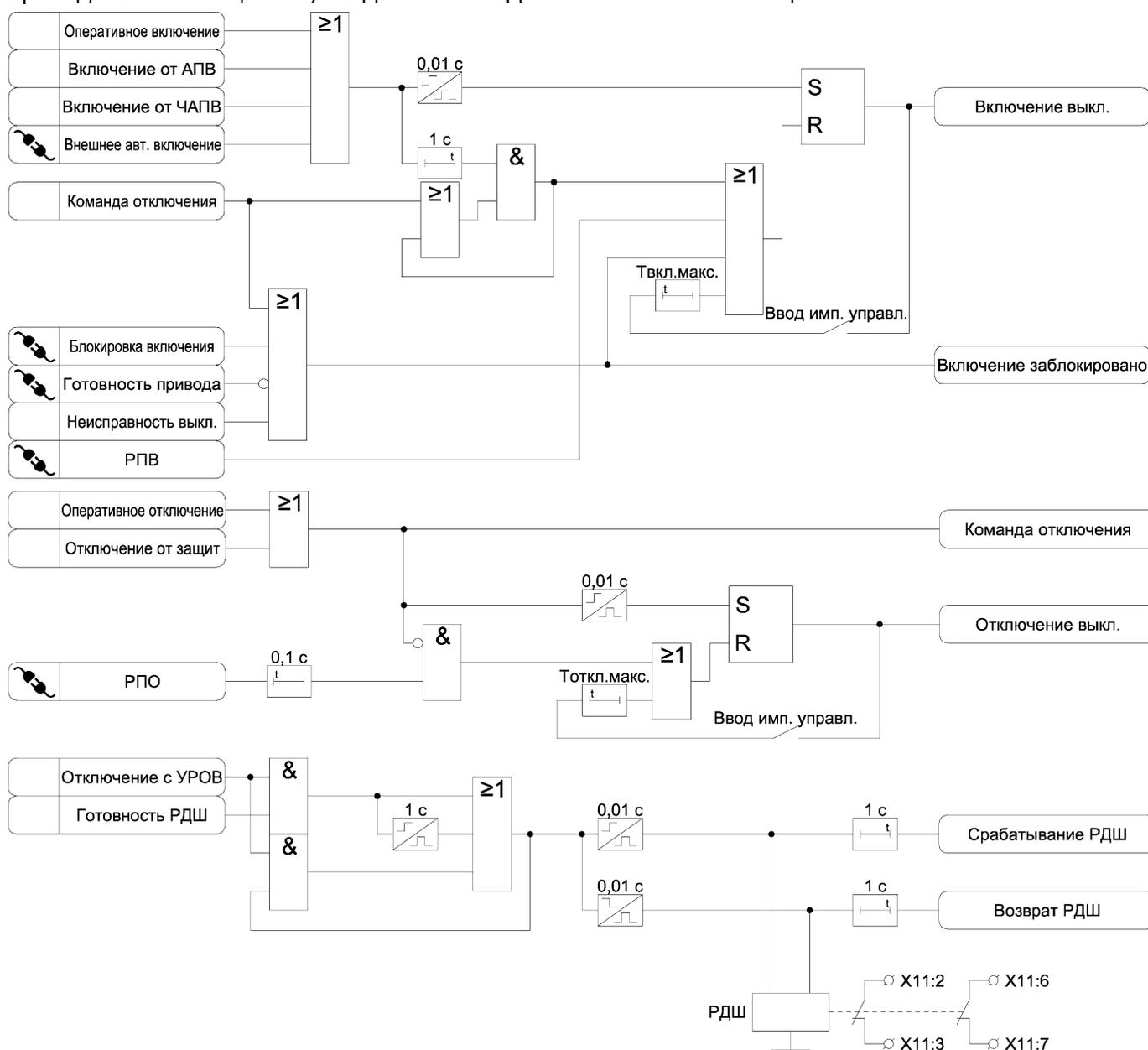
Рисунок 3.18 – Функциональная схема алгоритма управления выключателем
