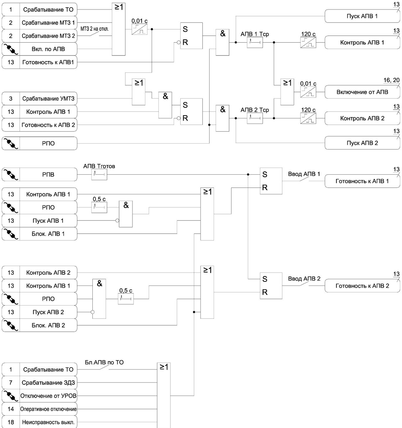
Рисунок А.13 – Функциональная схема алгоритма АПВ
