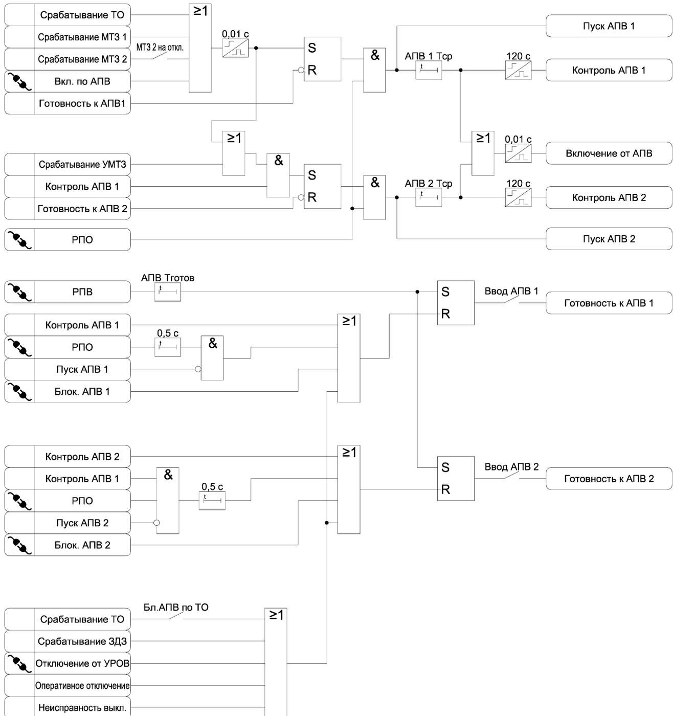
Рисунок 3.14 – Функциональная схема алгоритма АПВ
