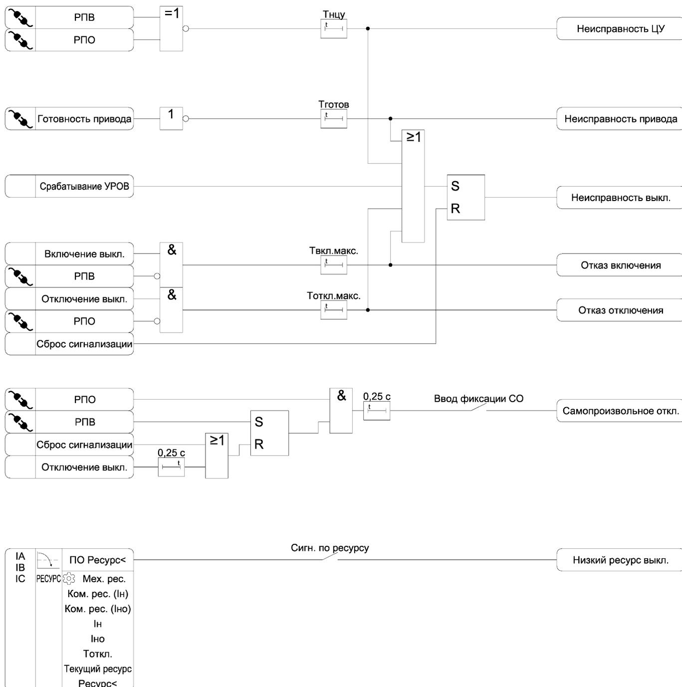
Рисунок 3.19 – Функциональная схема алгоритма диагностики выключателя
