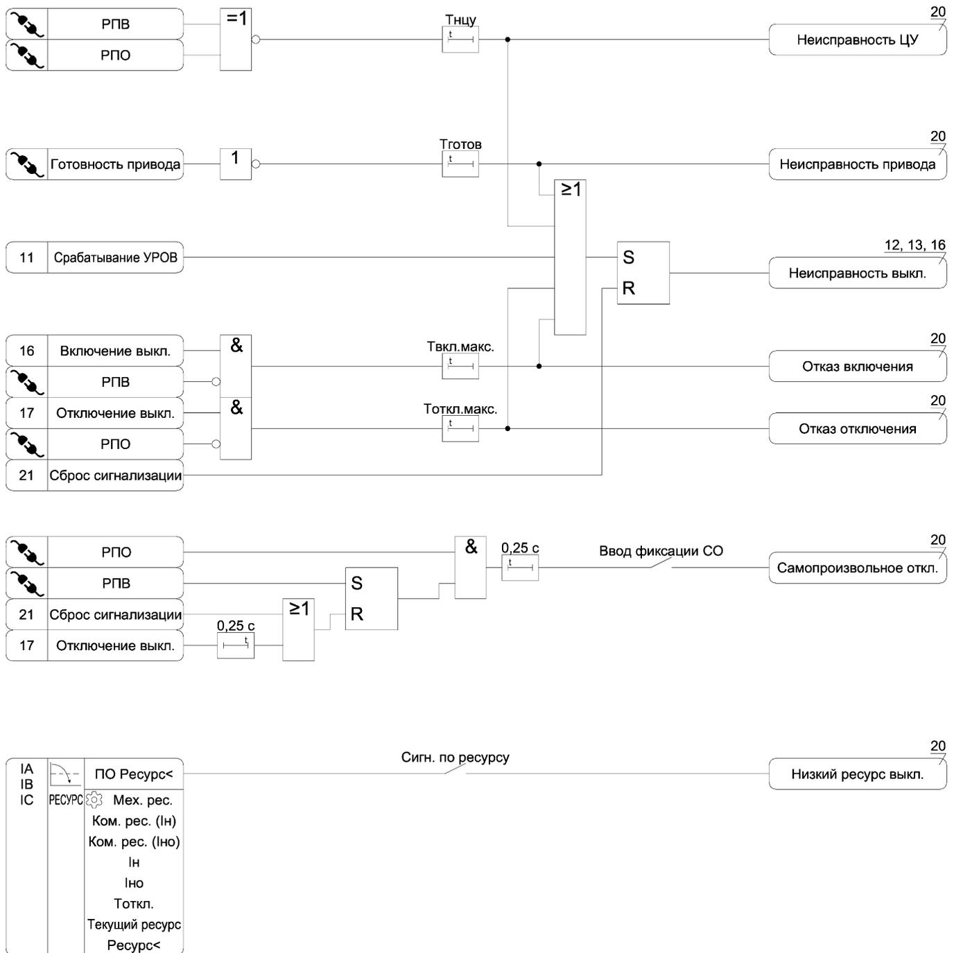
Рисунок А.18 – Функциональная схема алгоритма диагностики выключателя
