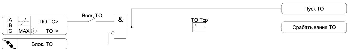
Рисунок 3.1 – Функциональная схема алгоритма ТО
