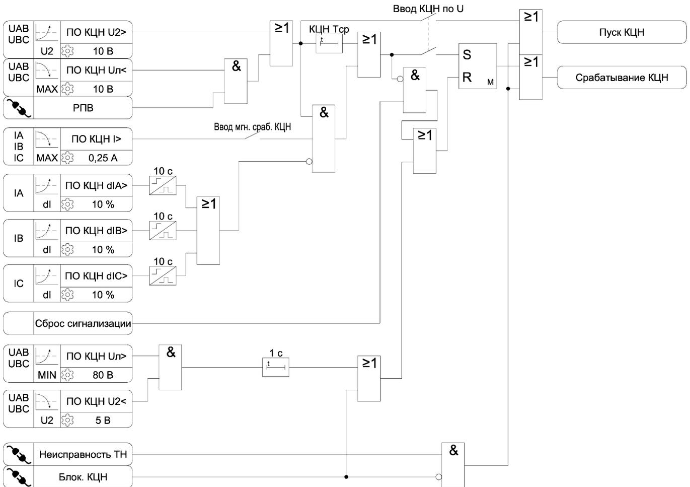
Рисунок 3.20 – Функциональная схема алгоритма КЦН
