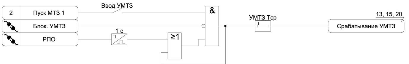
**Рисунок А.4 – Функциональная схема алгоритма пуска по напряжению МТЗ**
