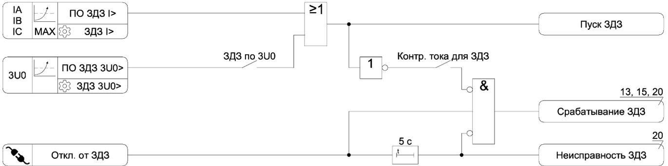
Рисунок А.7 – Функциональная схема алгоритма ЗДЗ
