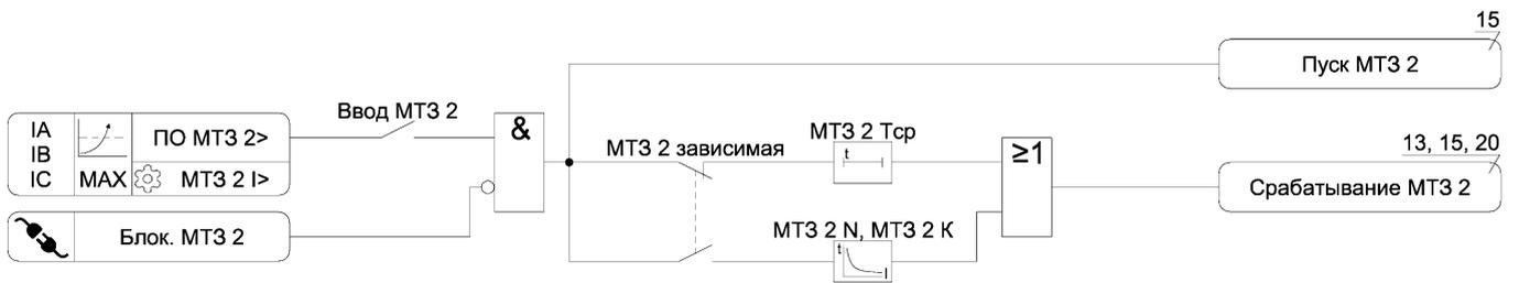
**Рисунок А.3 – Функциональная схема алгоритма УМТЗ**
