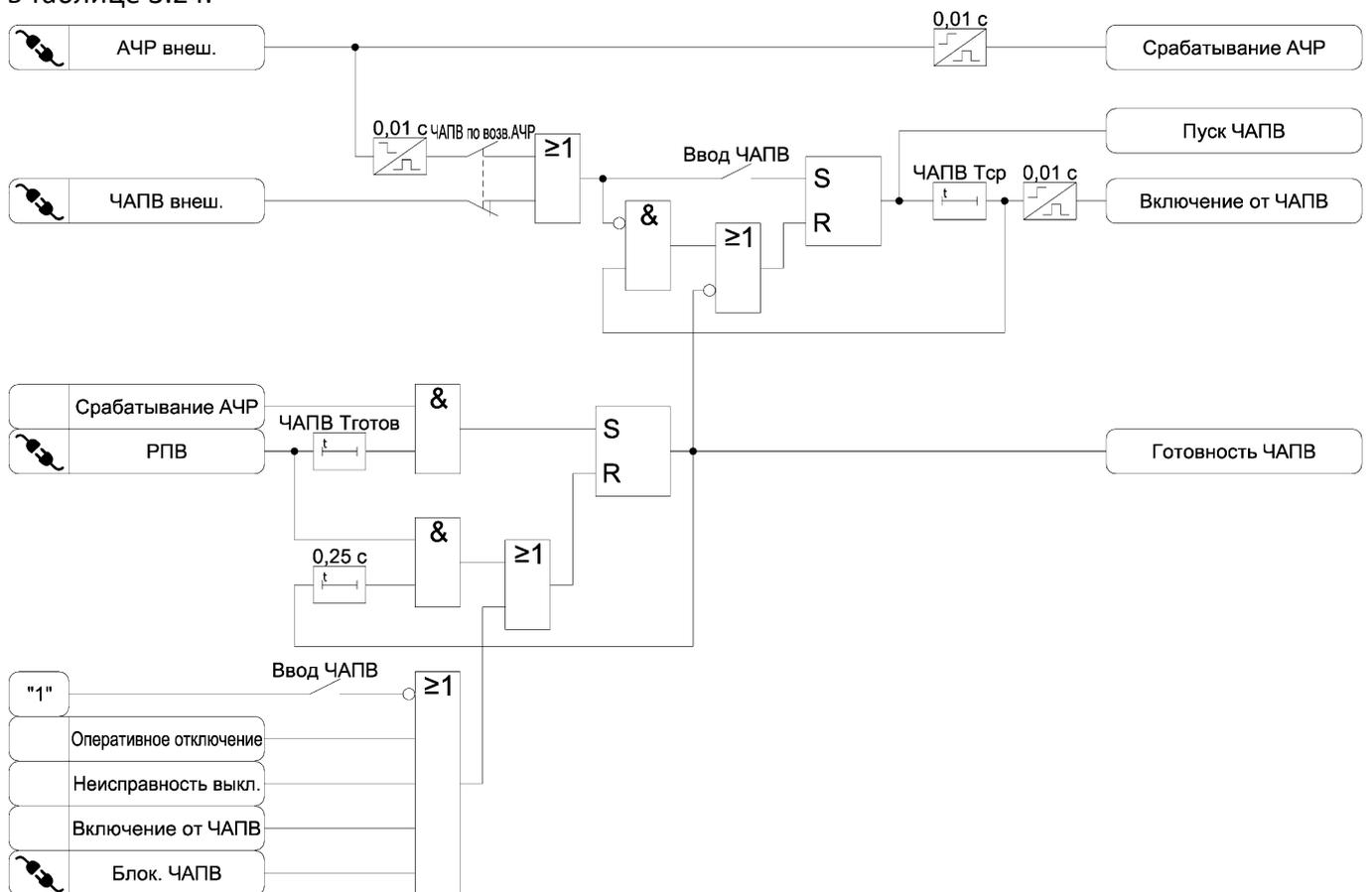
Рисунок 3.13 – Функциональные схемы алгоритмов АЧР и ЧАПВ
