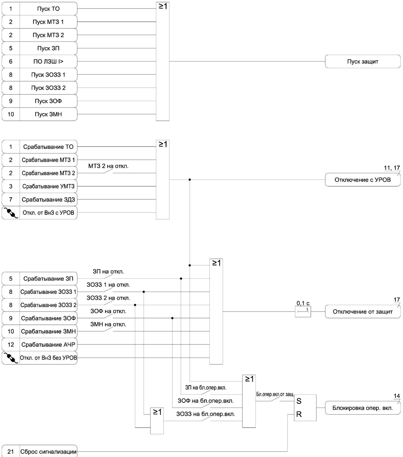
Рисунок А.15 – Функциональная схема алгоритма состояния защит
