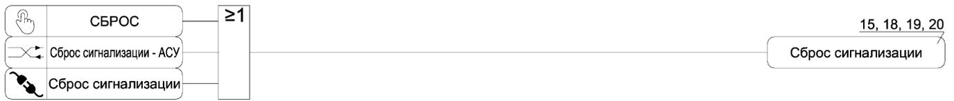
Рисунок А.21 – Функциональная схема алгоритма сброса сигнализации
