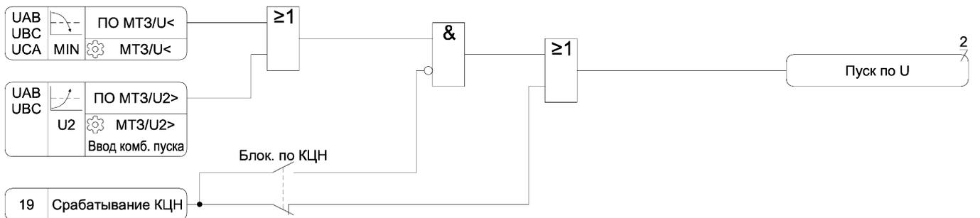
**Рисунок А.5 – Функциональная схема алгоритма ЗП**
