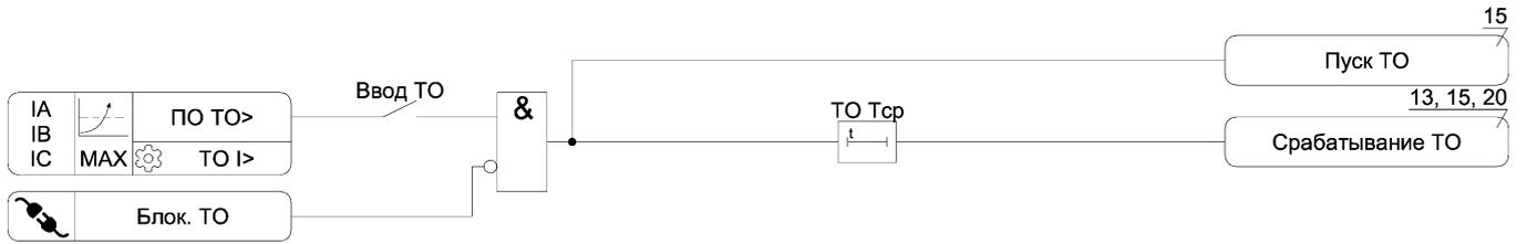
**Рисунок А.1 – Функциональная схема алгоритма ТО**
