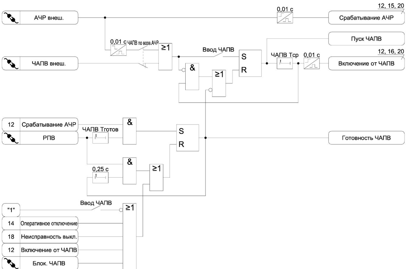
Рисунок А.12 – Функциональные схемы алгоритмов АЧР и ЧАПВ
