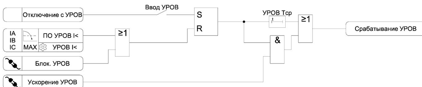
Рисунок 3.12 – Функциональная схема алгоритма УРОВ
