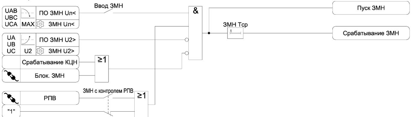
Рисунок 3.11 – Функциональная схема алгоритма ЗМН
