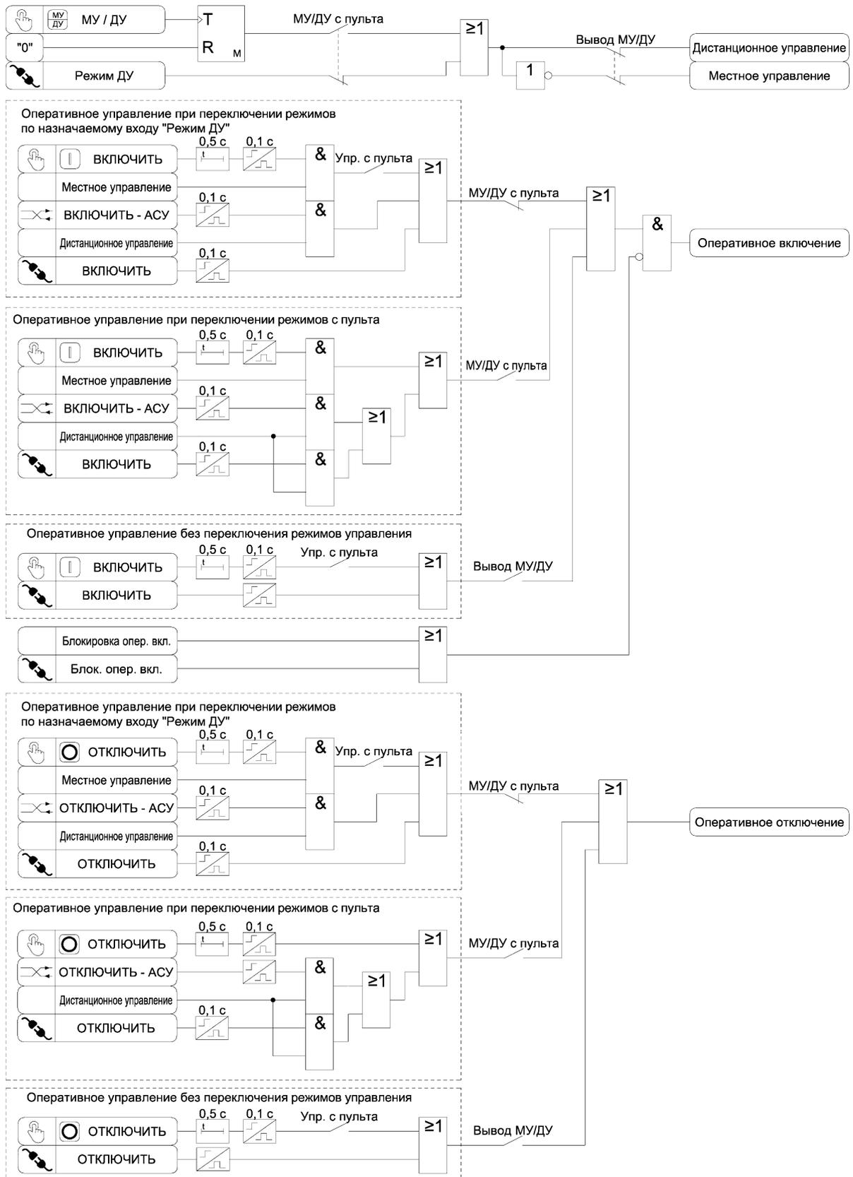
Рисунок 3.15 – Функциональная схема алгоритма оперативного управления выключателем
