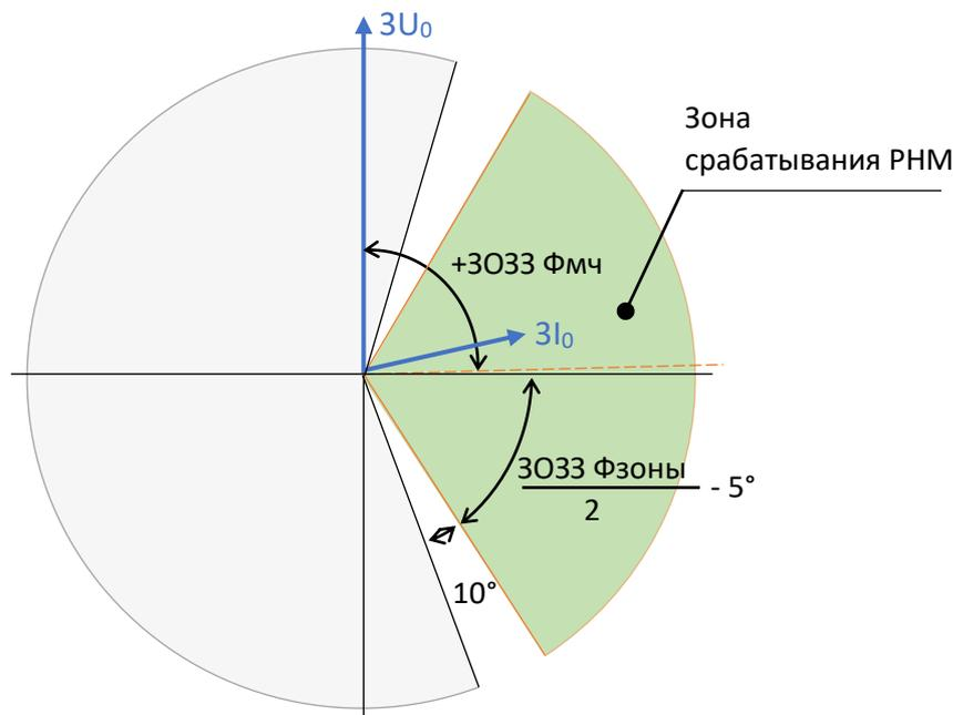
Рисунок 3.9 – Диаграмма срабатывания реле направления мощности нулевой последовательности
