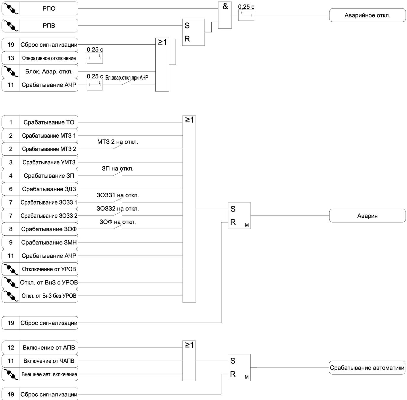
Рисунок А.18 а) – Функциональная схема алгоритма сигнализации
