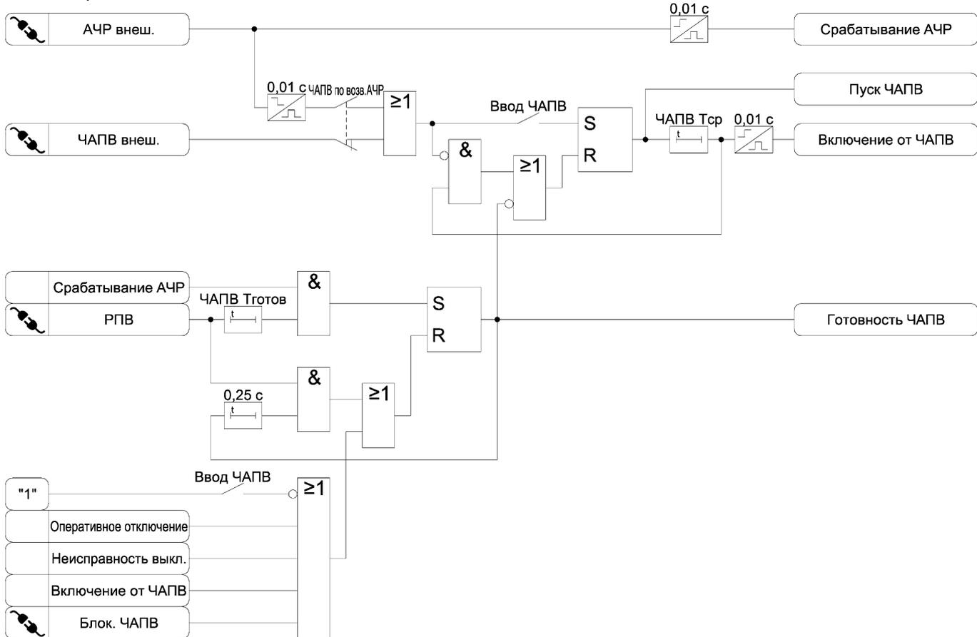
Рисунок 3.11 – Функциональные схемы алгоритмов АЧР и ЧАПВ
