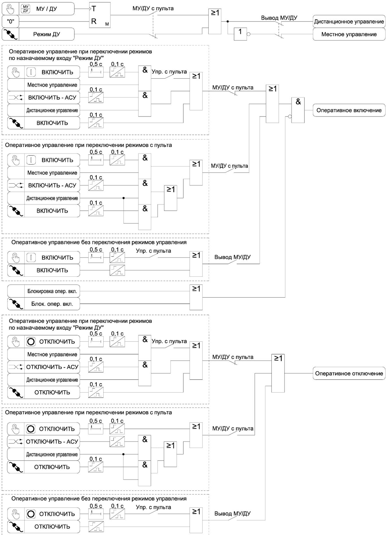
Рисунок 3.13 – Функциональная схема алгоритма оперативного управления выключателем
