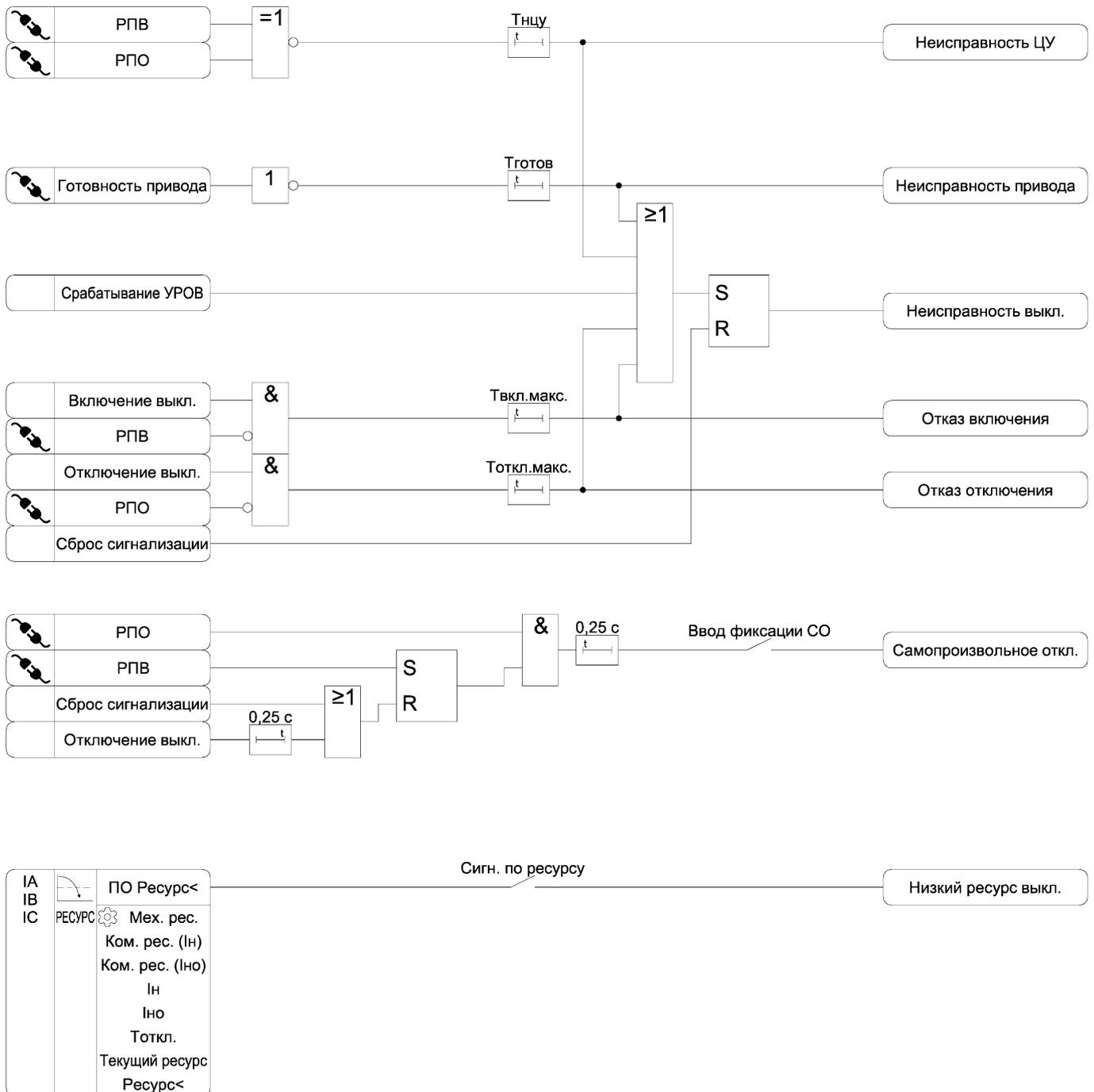
Рисунок 3.17 – Функциональная схема алгоритма диагностики выключателя
