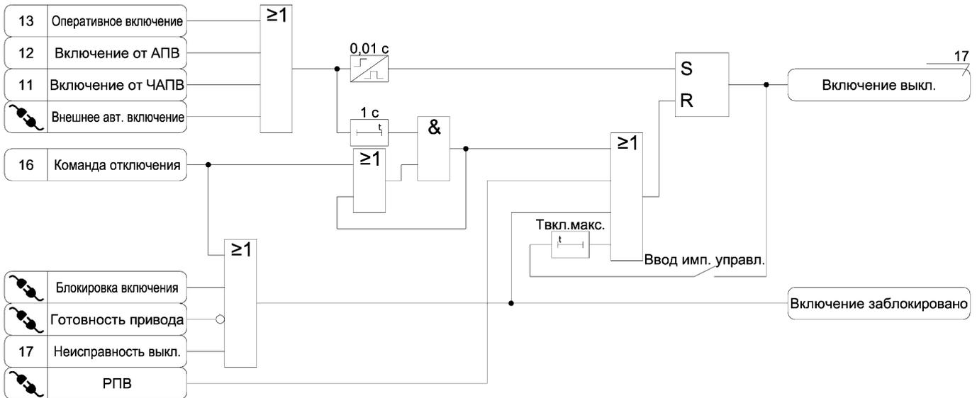
Рисунок А.15 – Функциональная схема алгоритма включения выключателя
