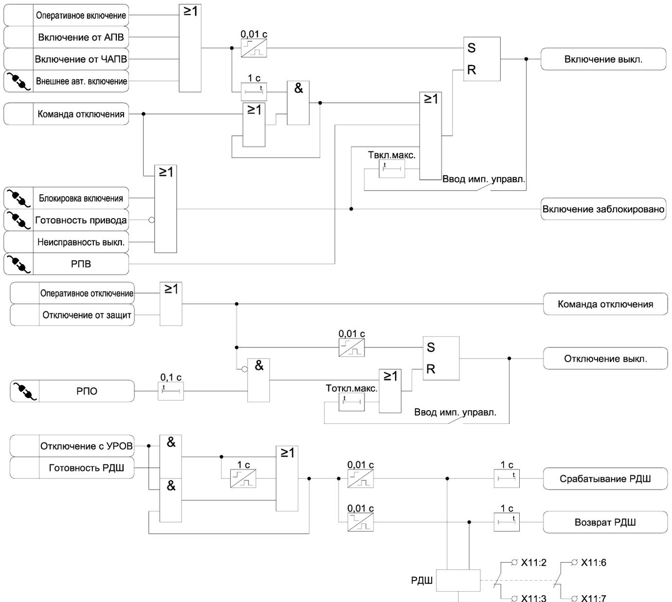
Рисунок 3.16 – Функциональная схема алгоритма управления выключателем
