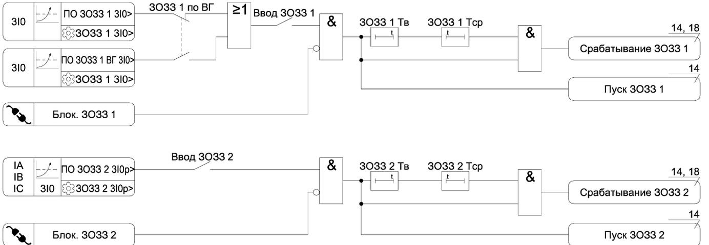
Рисунок А.7 – Функциональная схема алгоритма ZO33
