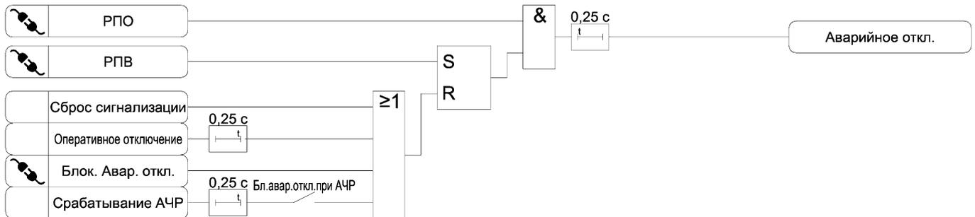
Рисунок 3.18 а) – Функциональная схема алгоритма сигнализации
