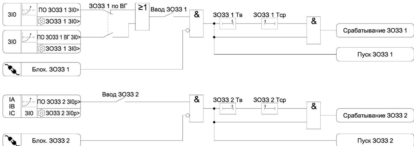
Рисунок 3.7 – Функциональная схема алгоритма ЗОЗЗ
