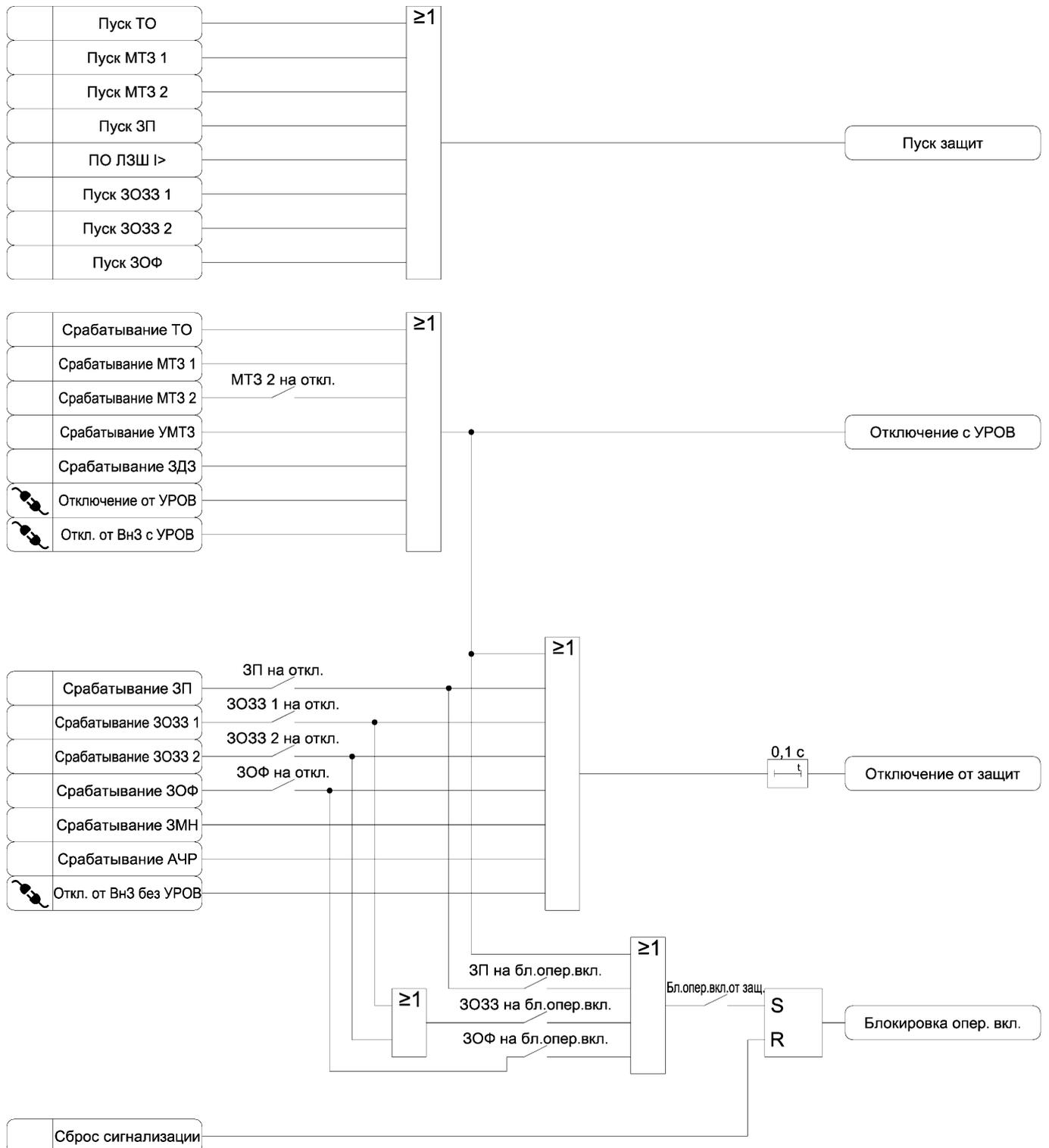
Рисунок 3.15 – Функциональная схема алгоритма формирования сигналов состояния защит
