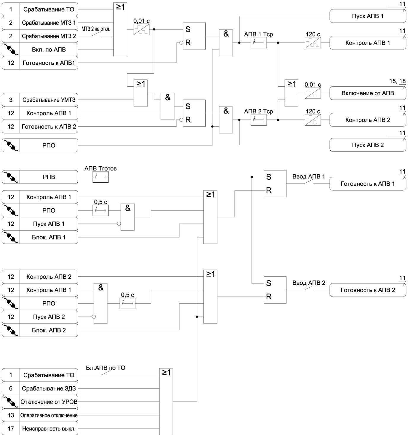
Рисунок А.12 – Функциональная схема алгоритма АПВ
