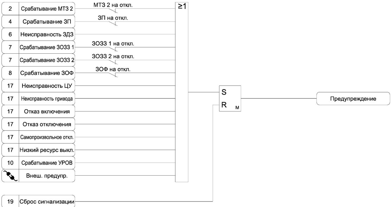
Рисунок А.18 б) – Функциональная схема алгоритма сигнализации
