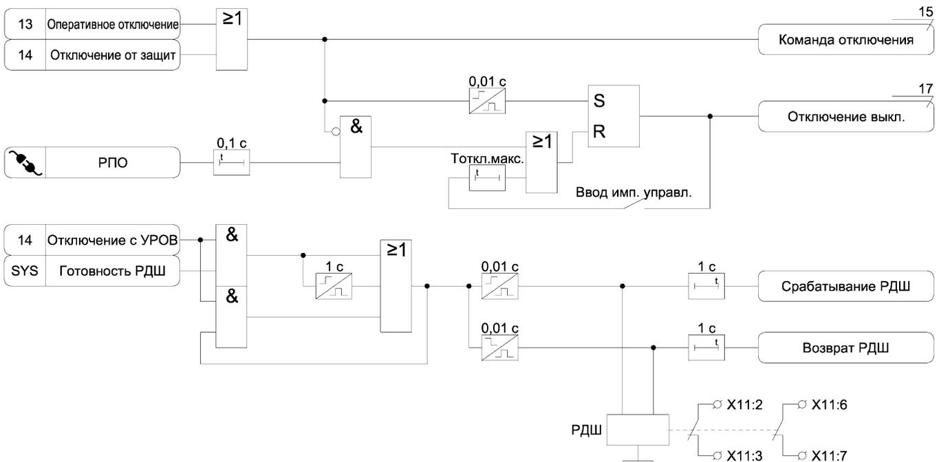
Рисунок А.16 – Функциональная схема алгоритма отключения выключателя
