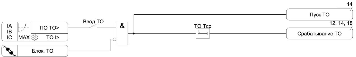
Рисунок А.1 – Функциональная схема алгоритма ТО
