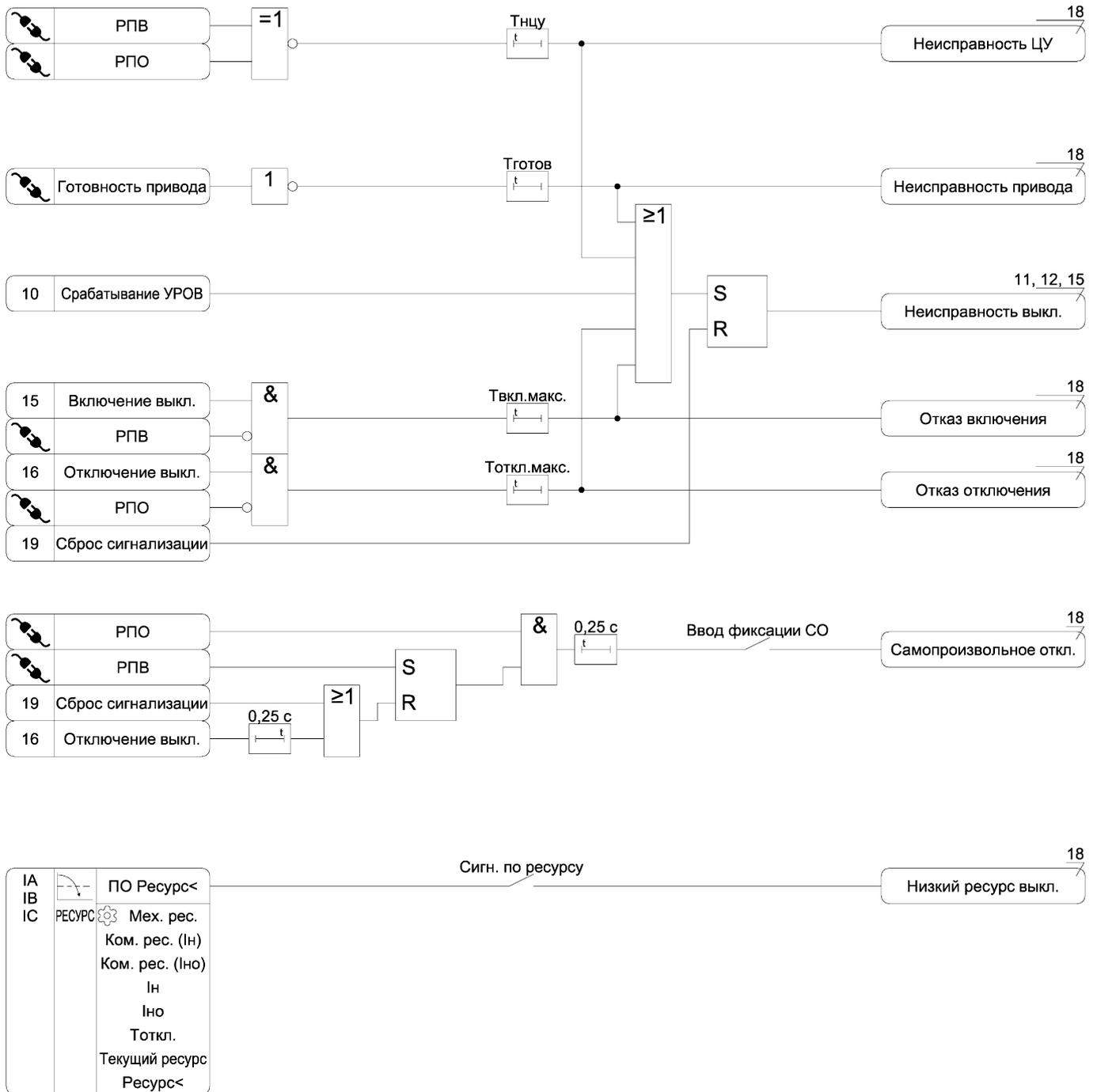
Рисунок А.17 – Функциональная схема алгоритма диагностики выключателя
