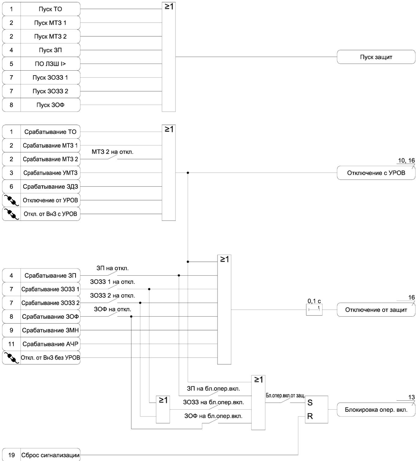
Рисунок А.14 – Функциональная схема алгоритма состояния защит
