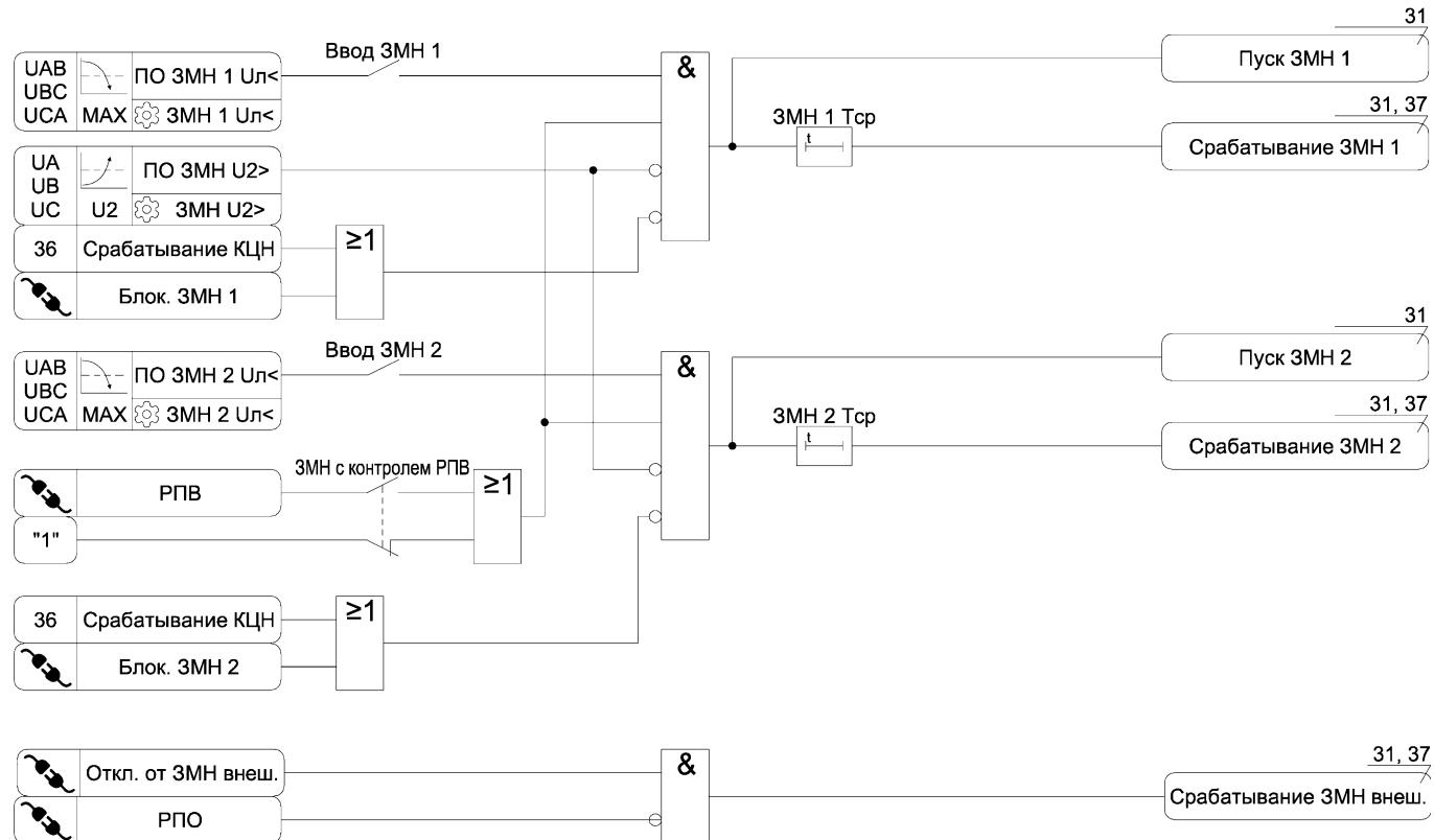
Рисунок А.19 – Функциональная схема алгоритма ЗМН
