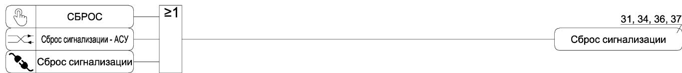
Рисунок А.38 – Функциональная схема алгоритма сброса сигнализации
