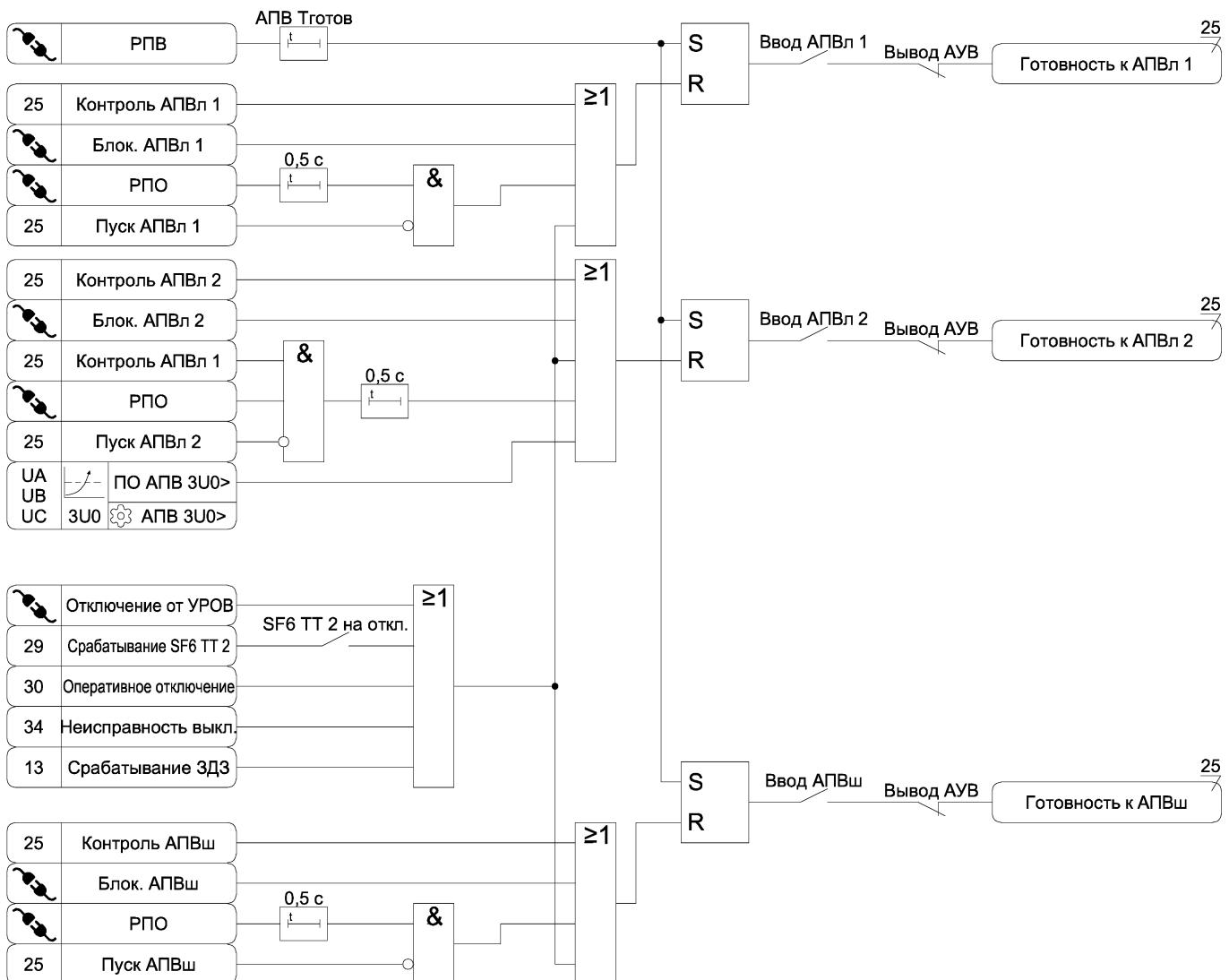
Рисунок А.25 б) – Функциональная схема алгоритма АПВ
