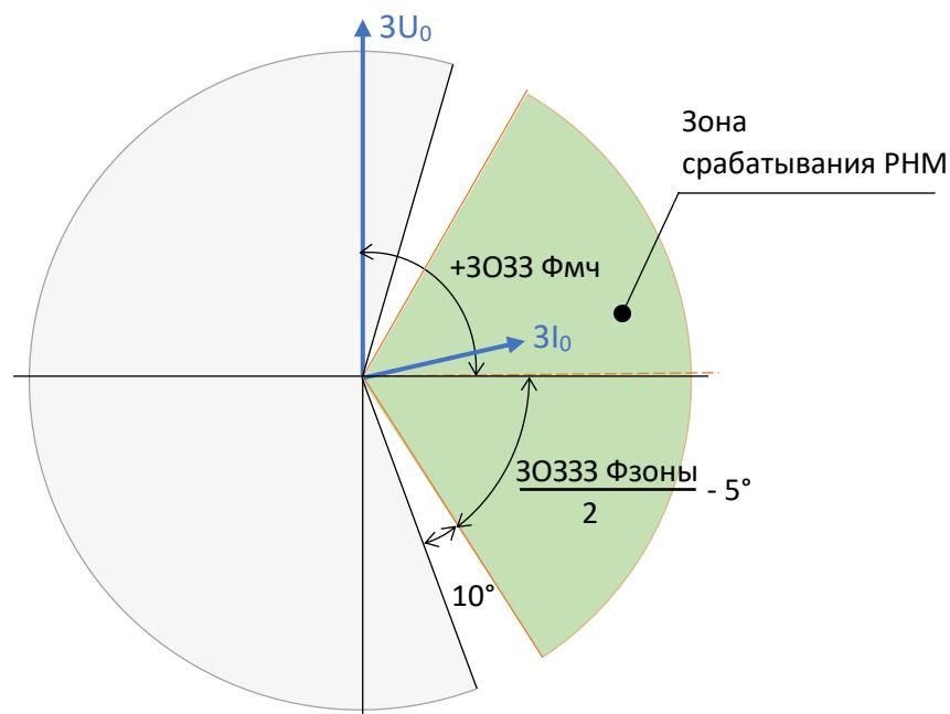
Рисунок 3.19 – Диаграмма срабатывания реле направления мощности нулевой последовательности
