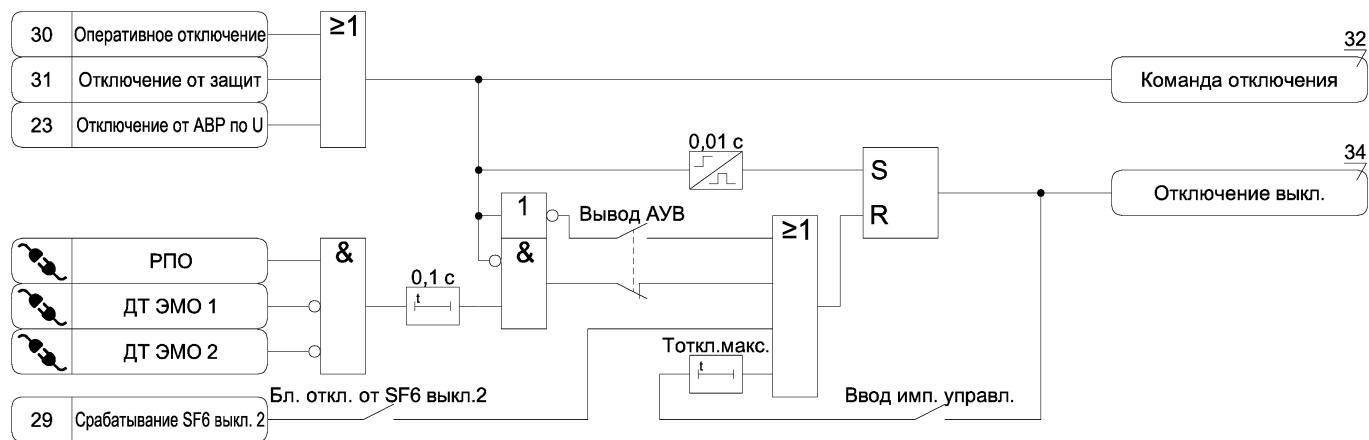
Рисунок А.33 – Функциональная схема алгоритма отключения выключателя
