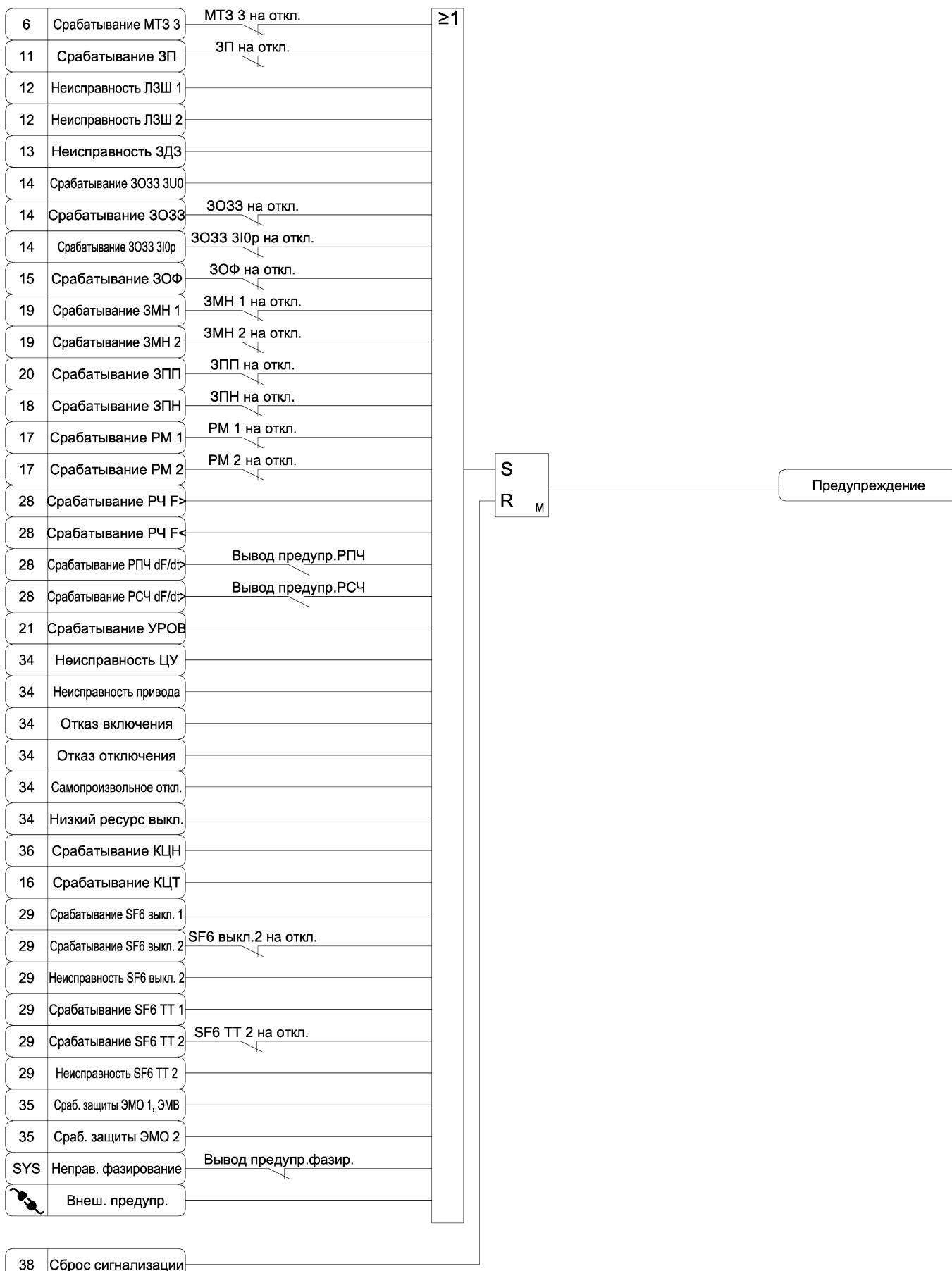
Рисунок А.37 в) – Функциональная схема алгоритма сигнализации
