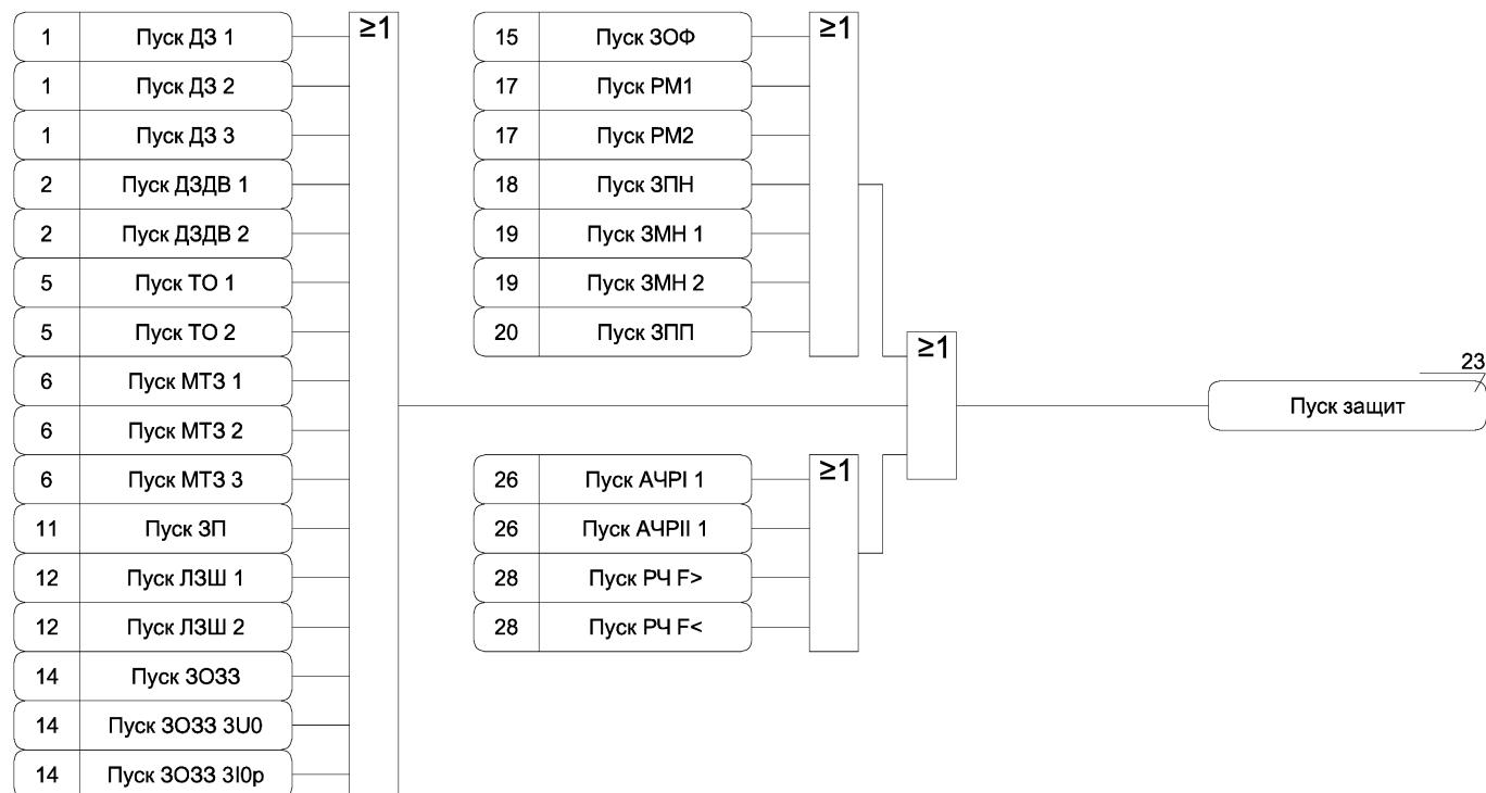
Рисунок А.31 а) – Функциональная схема алгоритма состояния защит
