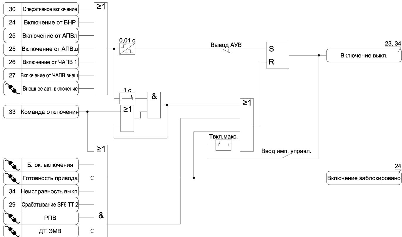
Рисунок А.32 – Функциональная схема алгоритма включения выключателя
