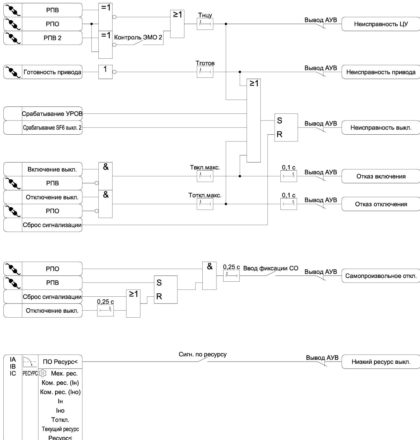
Рисунок 3.43 – Функциональная схема алгоритма диагностики выключателя
