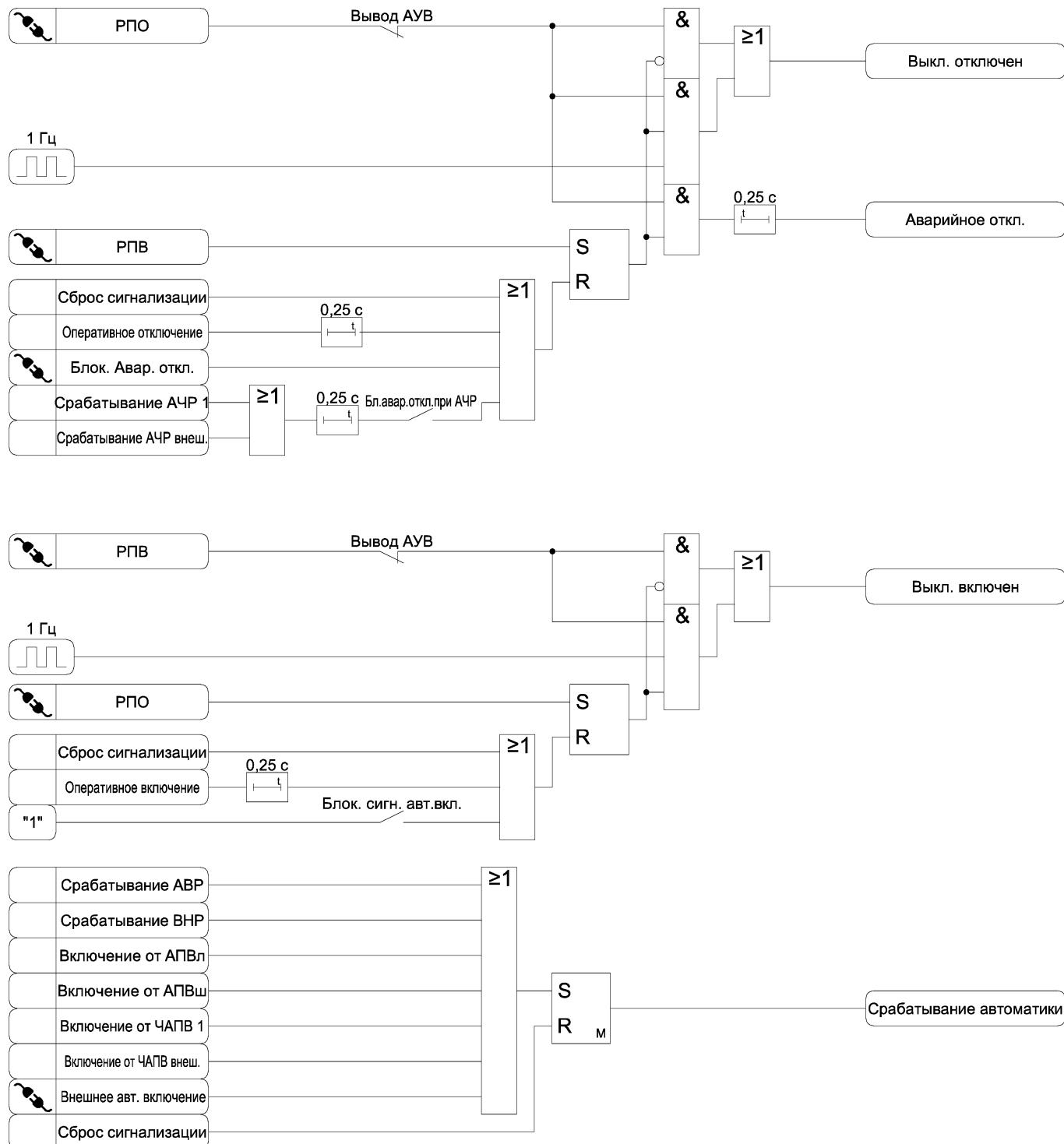
Рисунок 3.46 а) – Функциональная схема алгоритма сигнализации
