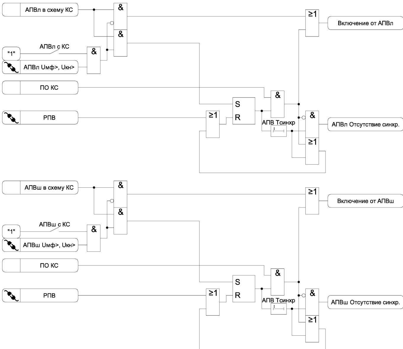
Рисунок 3.34 г) – Функциональная схема алгоритма АПВ
