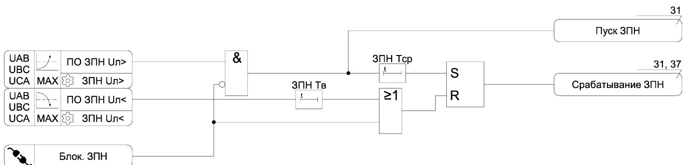
Рисунок А.18 – Функциональная схема алгоритма ЗПН
