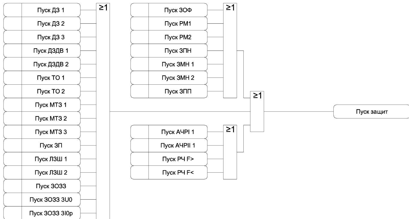
Рисунок 3.41 а) – Функциональная схема алгоритма формирования сигналов состояния защит
