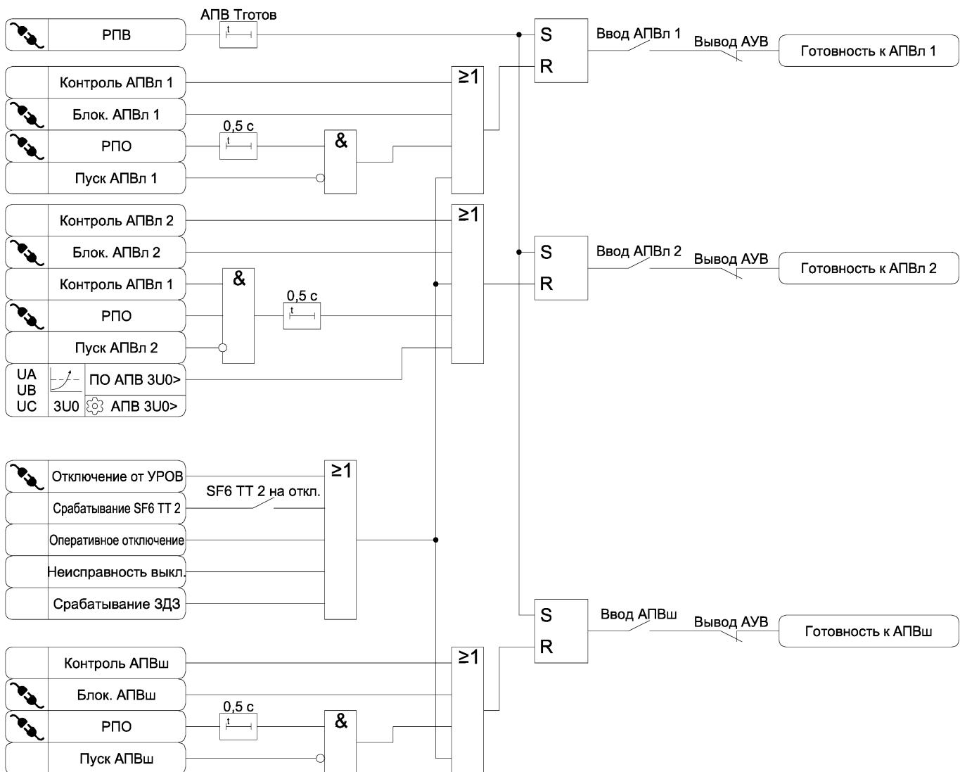
Рисунок 3.34 б) – Функциональная схема алгоритма АПВ
