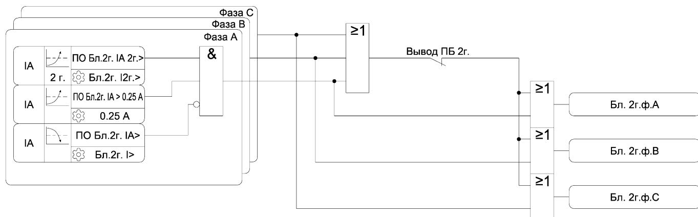
Рисунок 3.14 – Функциональная схема алгоритма блокировки по второй гармонике
