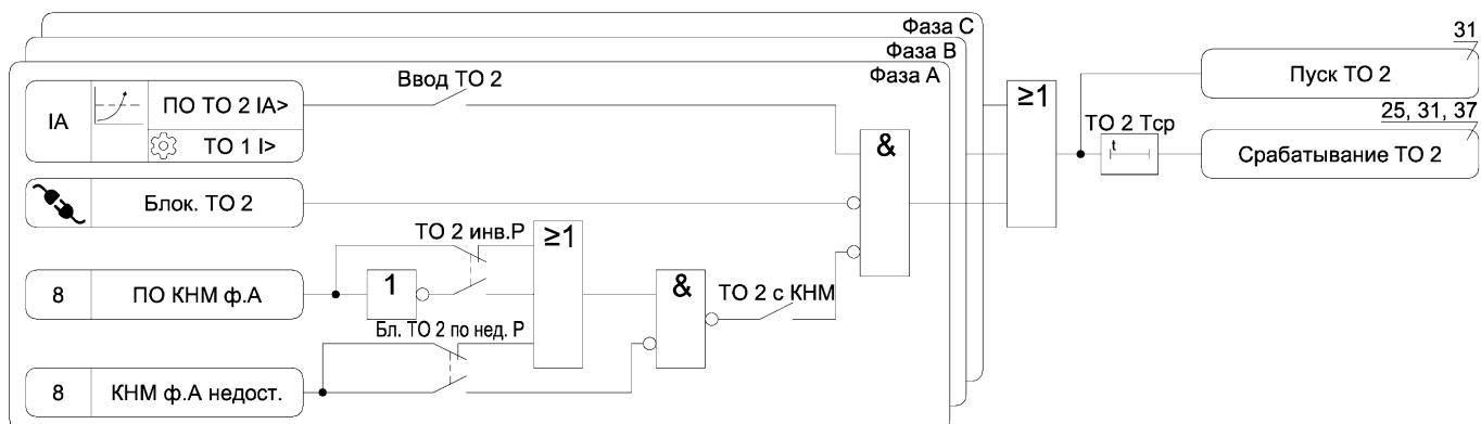
Рисунок А.5 – Функциональная схема алгоритма ТО
