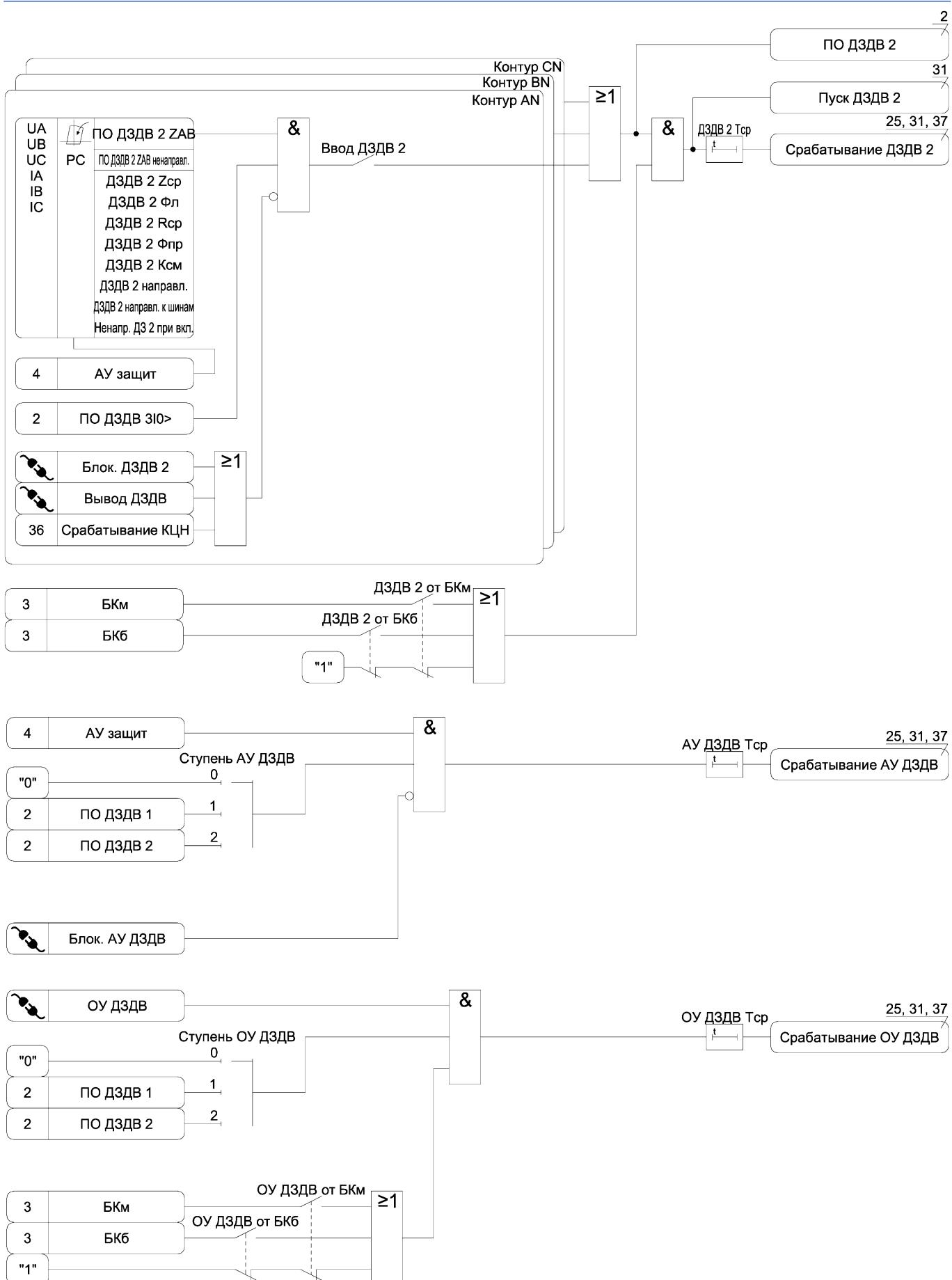
Рисунок А.2 б) – Функциональная схема алгоритма ДЗДВ
