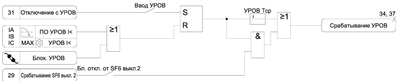
Рисунок А.21 – Функциональная схема алгоритма УРОВ
