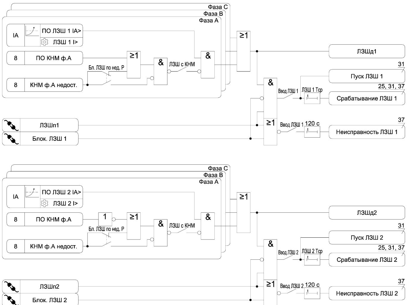
Рисунок А.12 – Функциональная схема алгоритма ЛЗШ
