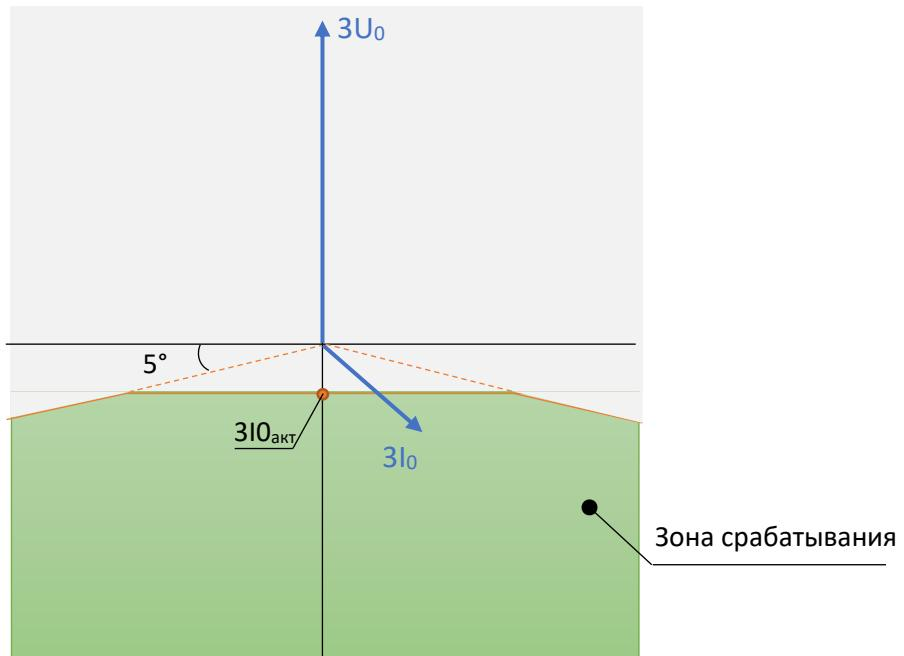
Рисунок 3.20 – Диаграмма срабатывания реле активного тока нулевой последовательности
