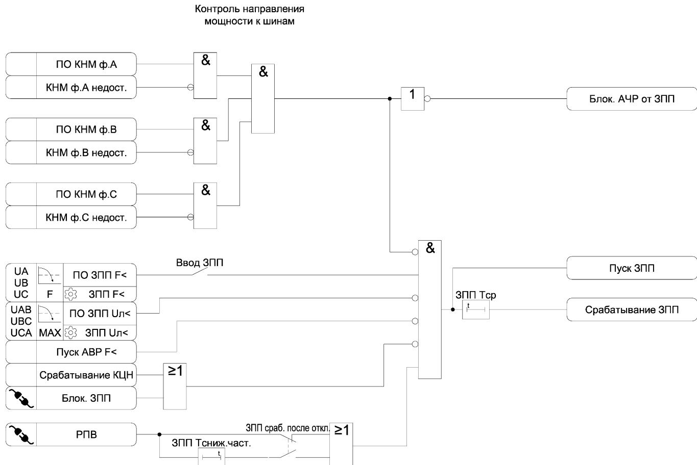
Рисунок 3.27 – Функциональная схема алгоритма ЗПП
