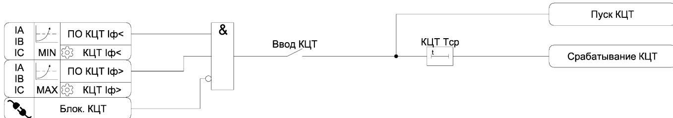
Рисунок 3.22 – Функциональная схема алгоритма КЦТ
