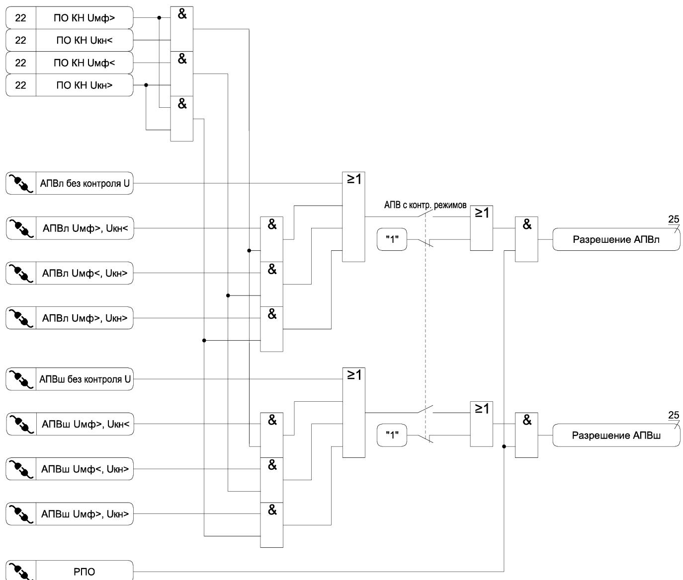
Рисунок А.25 а) – Функциональная схема алгоритма АПВ
