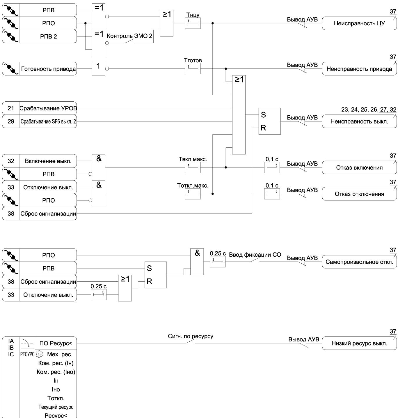
Рисунок А.34 – Функциональная схема алгоритма диагностики выключателя
