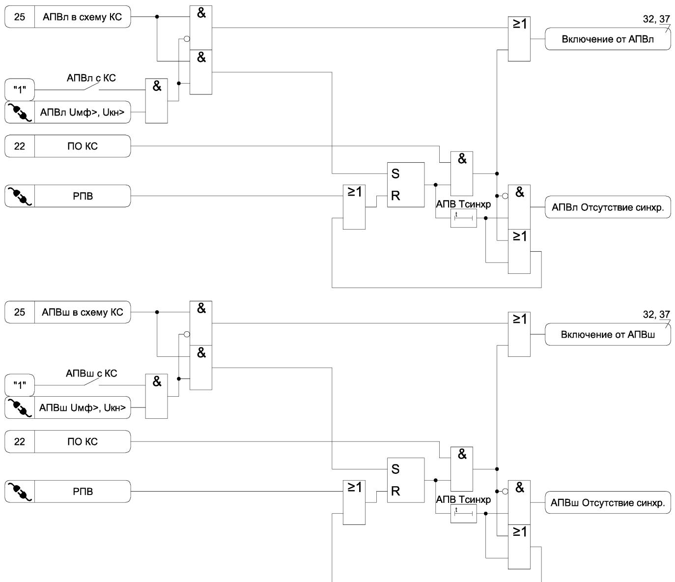
Рисунок А.25 г) – Функциональная схема алгоритма АПВ
