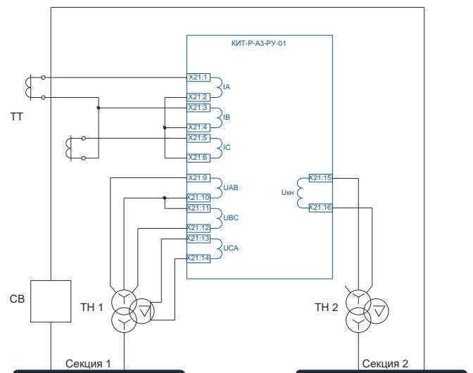
г) схема на СВ с двумя ТТ
