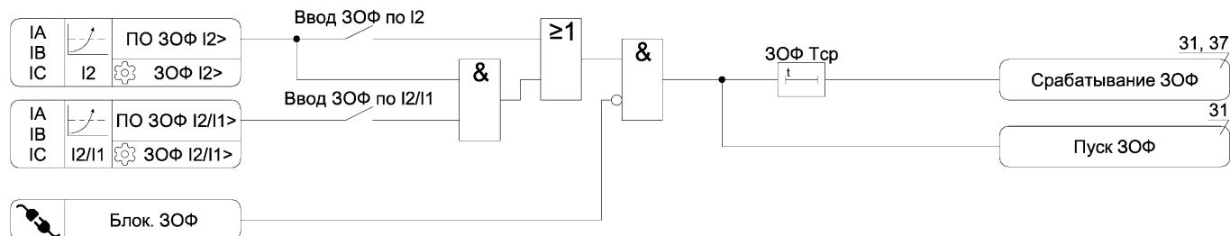
Рисунок А.15 – Функциональная схема алгоритма 3OФ
