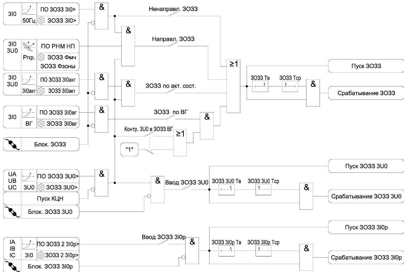
Рисунок 3.18 – Функциональная схема алгоритма ЗО33
