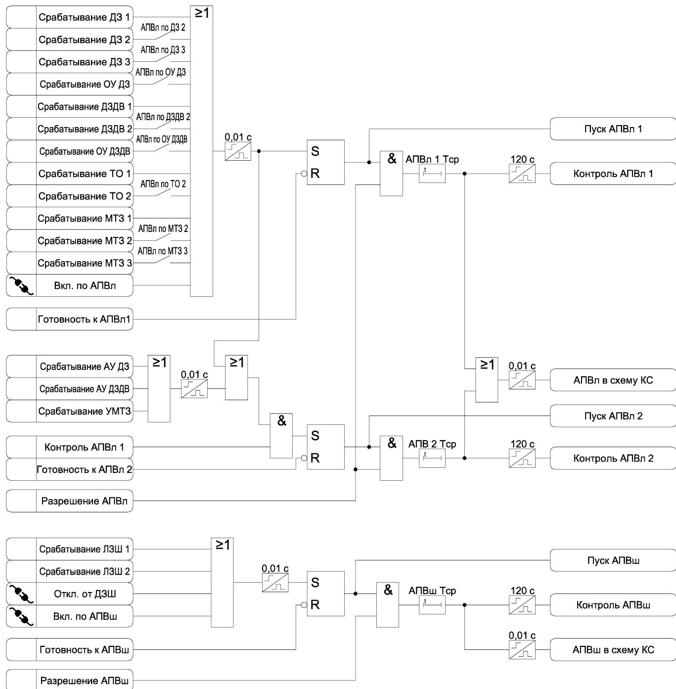
Рисунок 3.34 в) – Функциональная схема алгоритма АПВ
