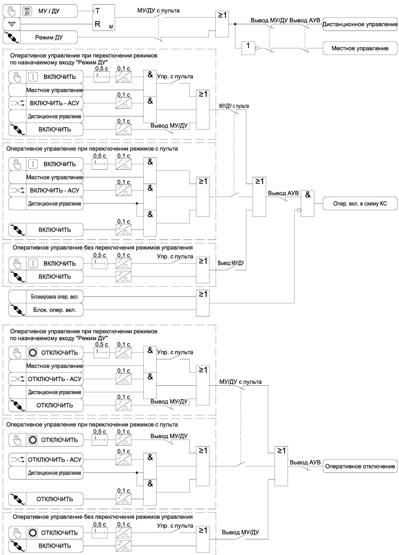
Рисунок 3.39 а) – Функциональная схема алгоритма оперативного управления выключателем
