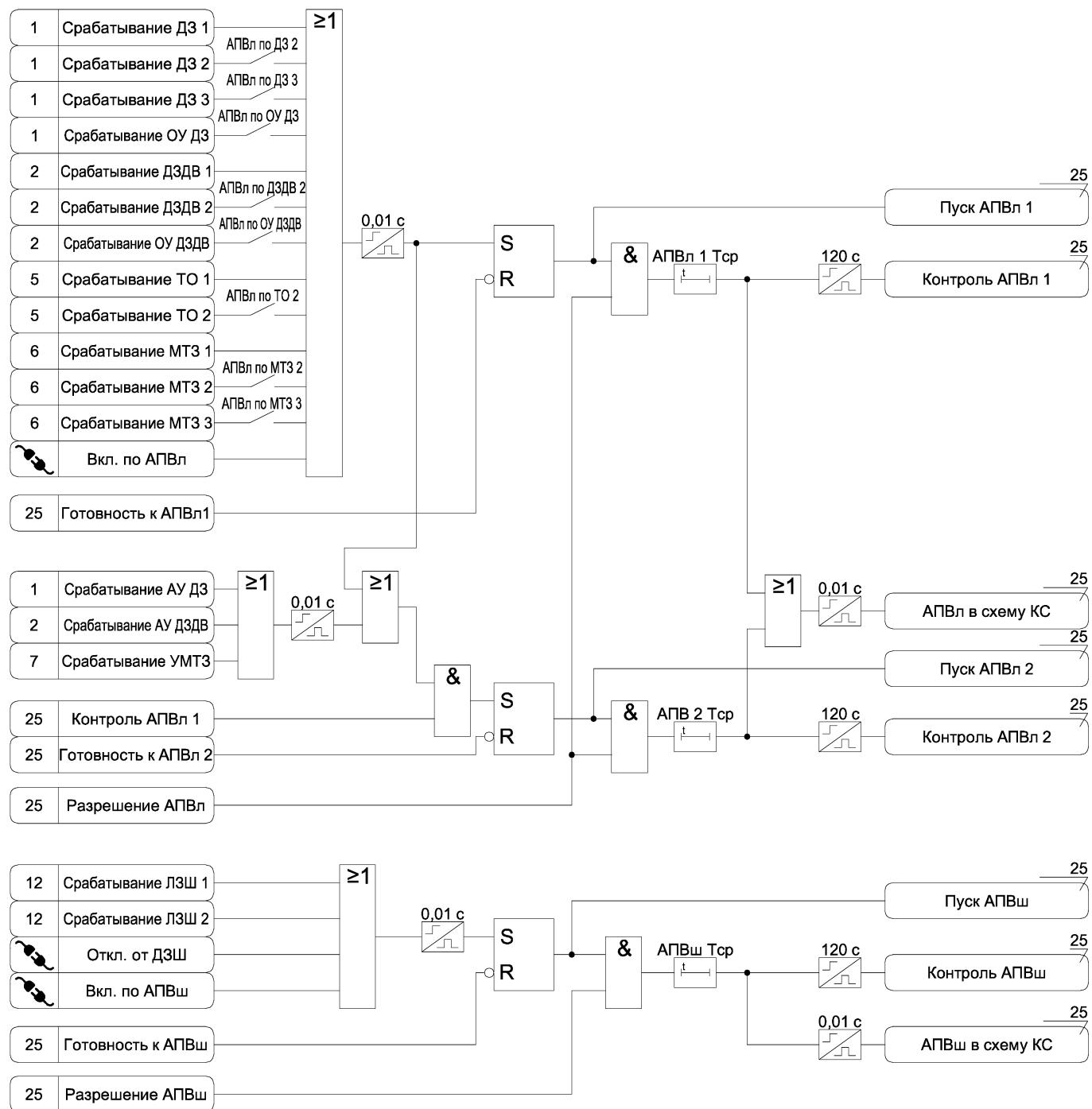
Рисунок А.25 в) – Функциональная схема алгоритма АПВ
