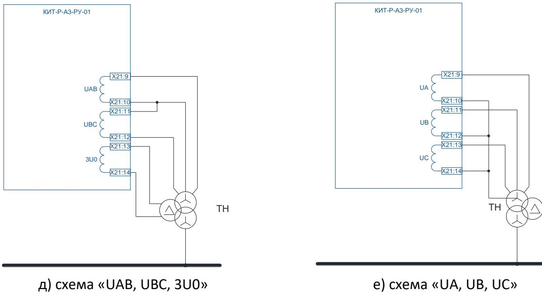
Рисунок 1.3 – Варианты подключения цепей напряжения
