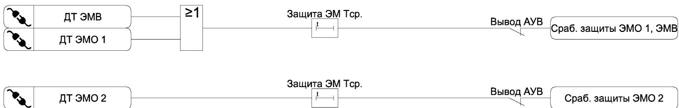
Рисунок 3.44 – Функциональная схема алгоритма защиты электромагнитов управления
