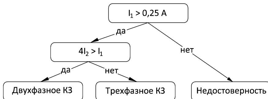
Рисунок 3.48 – Блок-схема определения вида короткого замыкания
