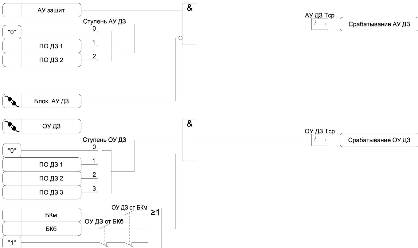
Рисунок 3.1 в) – Функциональная схема алгоритма ДЗ
