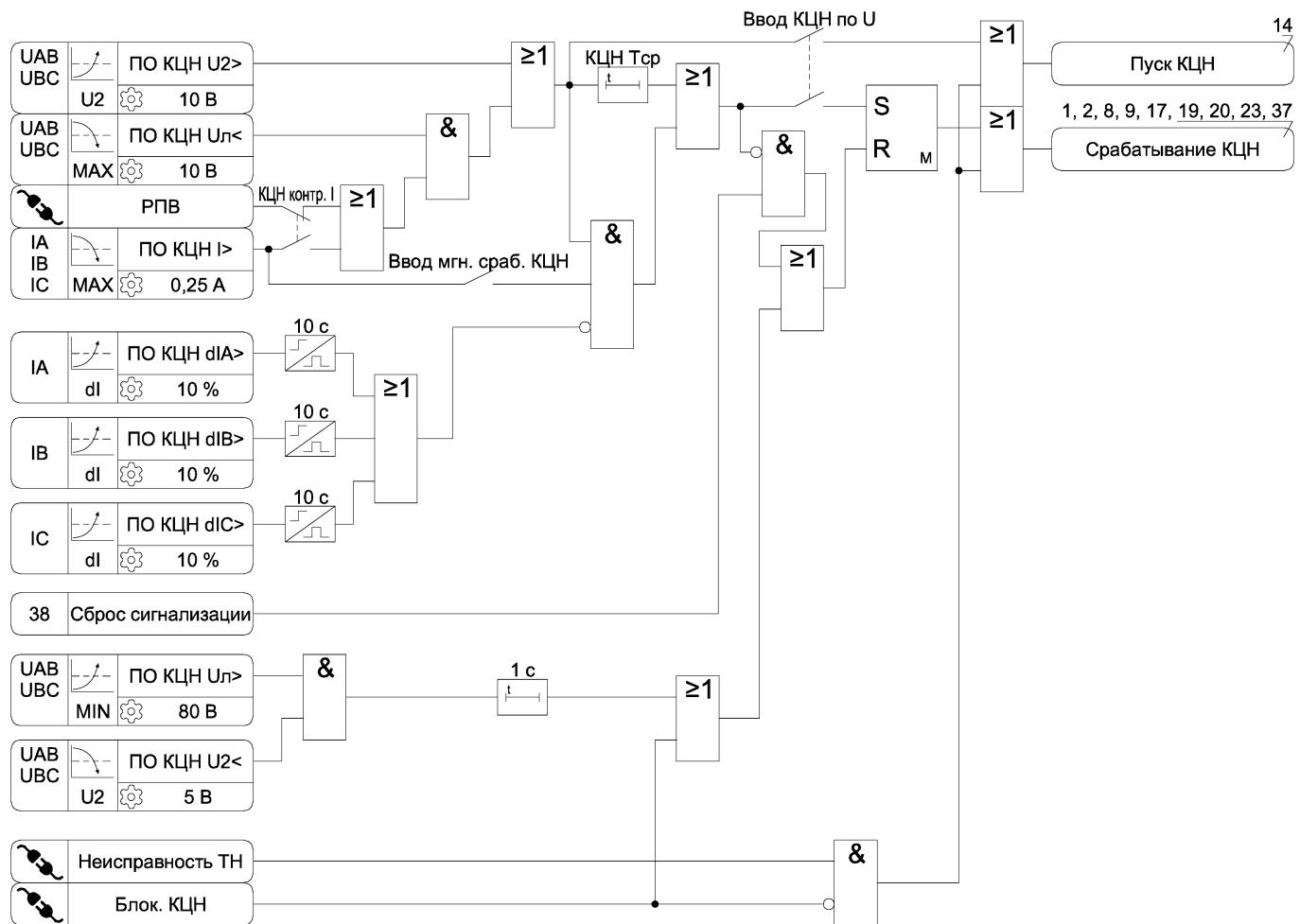
Рисунок А.36 – Функциональная схема алгоритма КЗН
