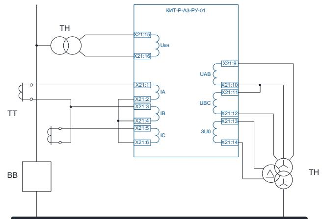
б) схема на ВВ с двумя ТТ
