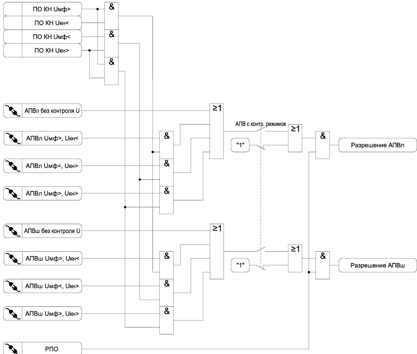
Рисунок 3.34 а) – Функциональная схема алгоритма АПВ
