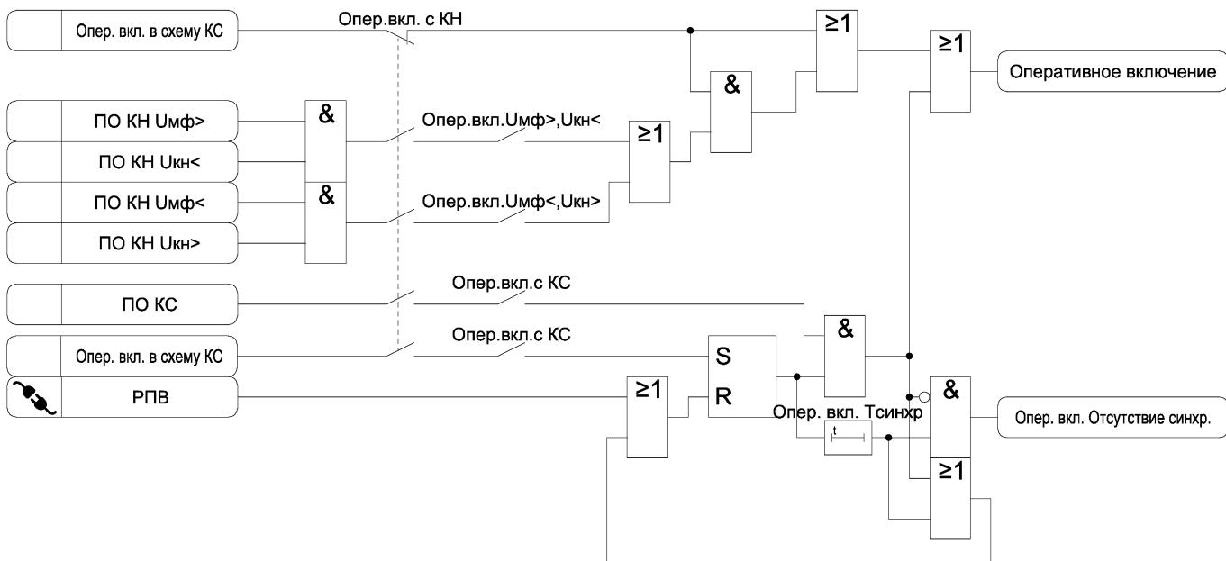
Рисунок 3.39 б) – Функциональная схема алгоритма оперативного управления выключателем
