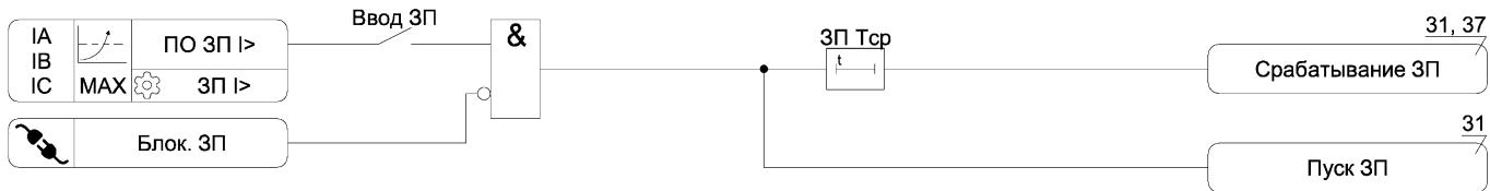
Рисунок А.11 – Функциональная схема алгоритма ЗП
