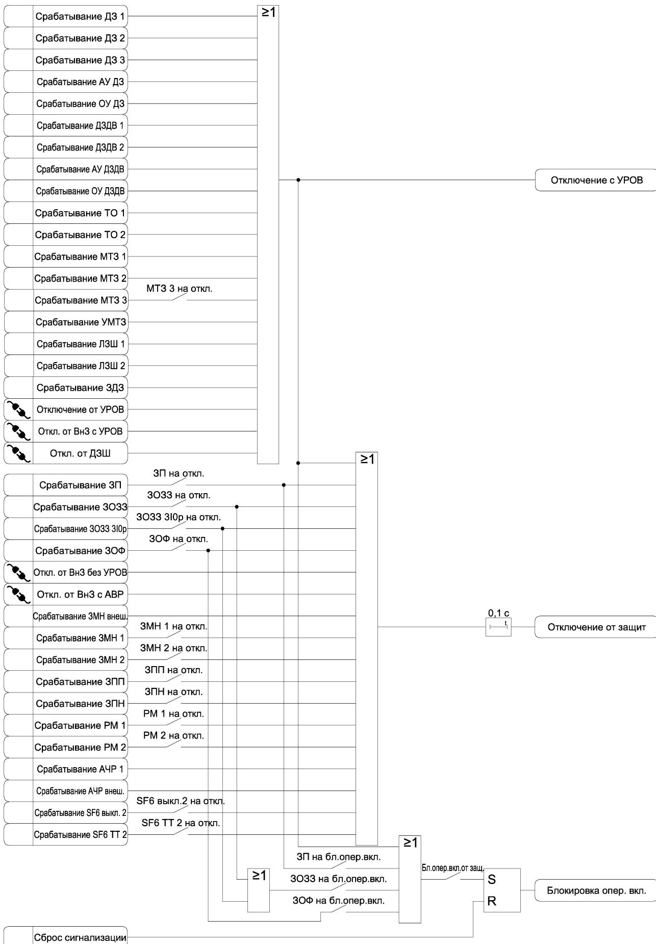
Рисунок 3.41 б) – Функциональная схема алгоритма формирования сигналов состояния защиты
