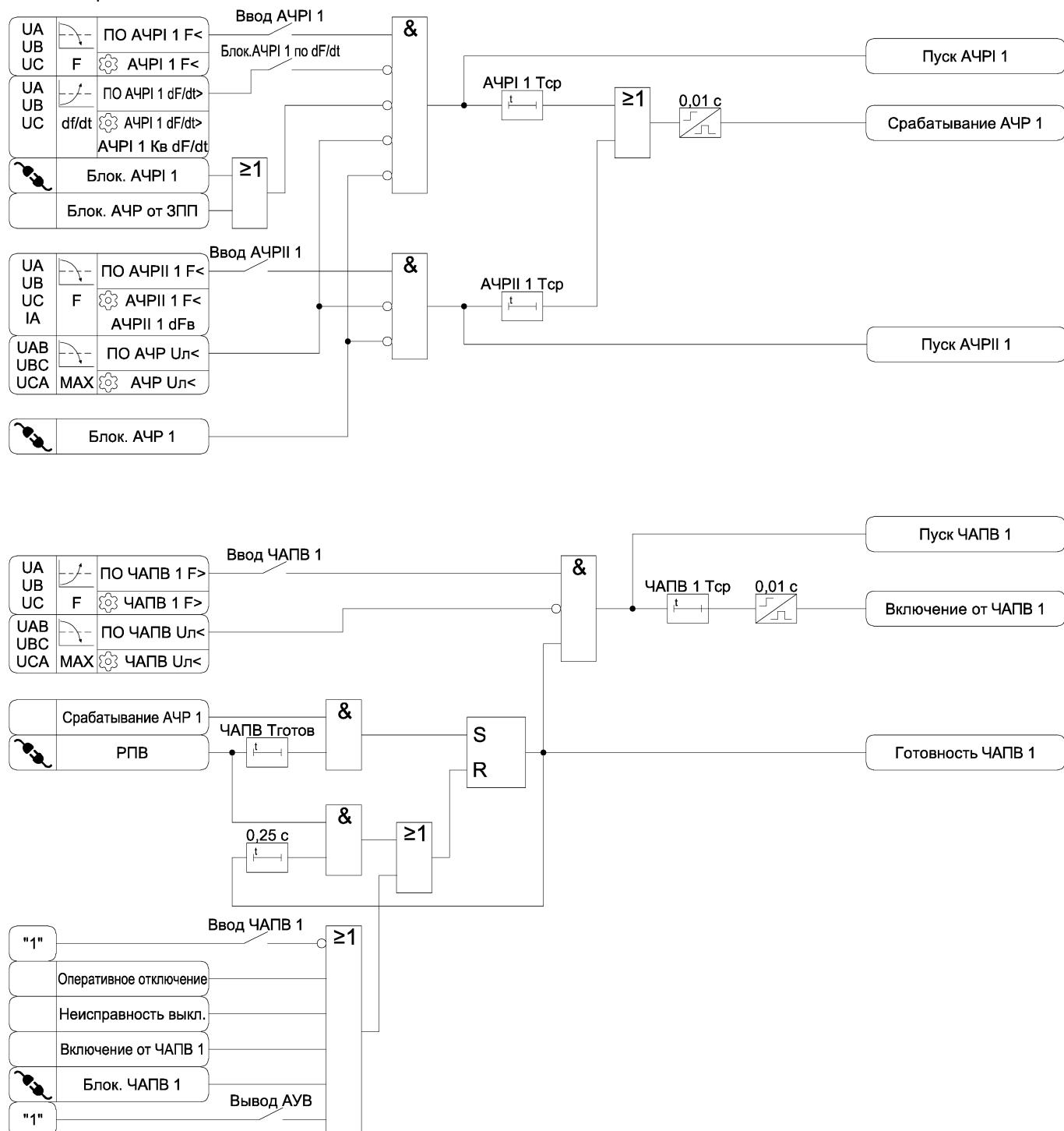
Рисунок 3.35 – Функциональные схемы алгоритмов АЧР и ЧАПВ
