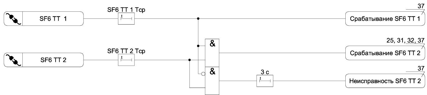
Рисунок А.29 – Функциональная схема алгоритма защиты от снижения давления элегаза
