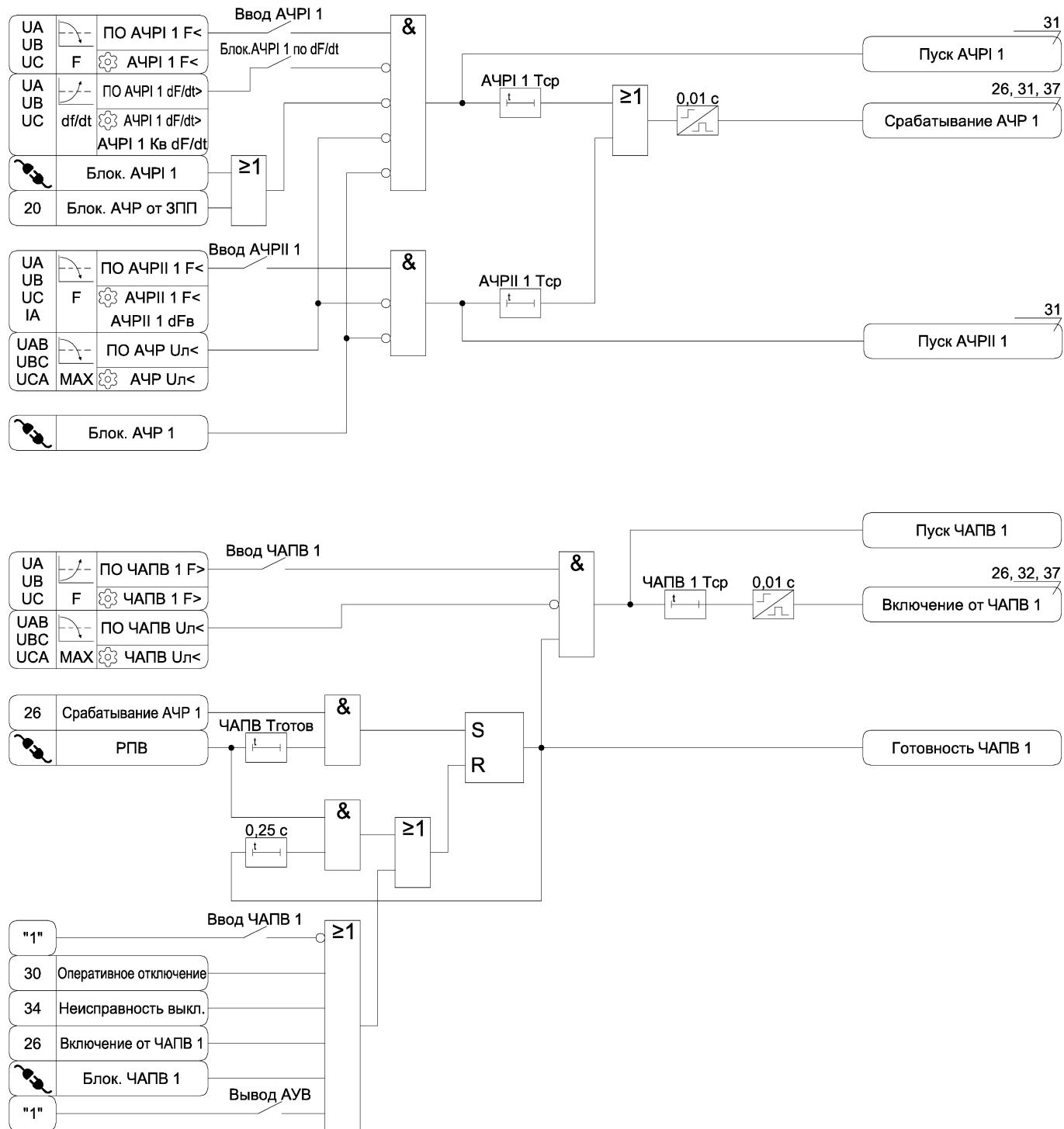
Рисунок А.26 – Функциональная схема алгоритма АЧР и ЧАПВ
