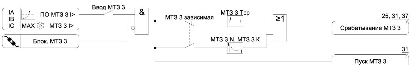
Рисунок А.6 – Функциональная схема алгоритма МТЗ
