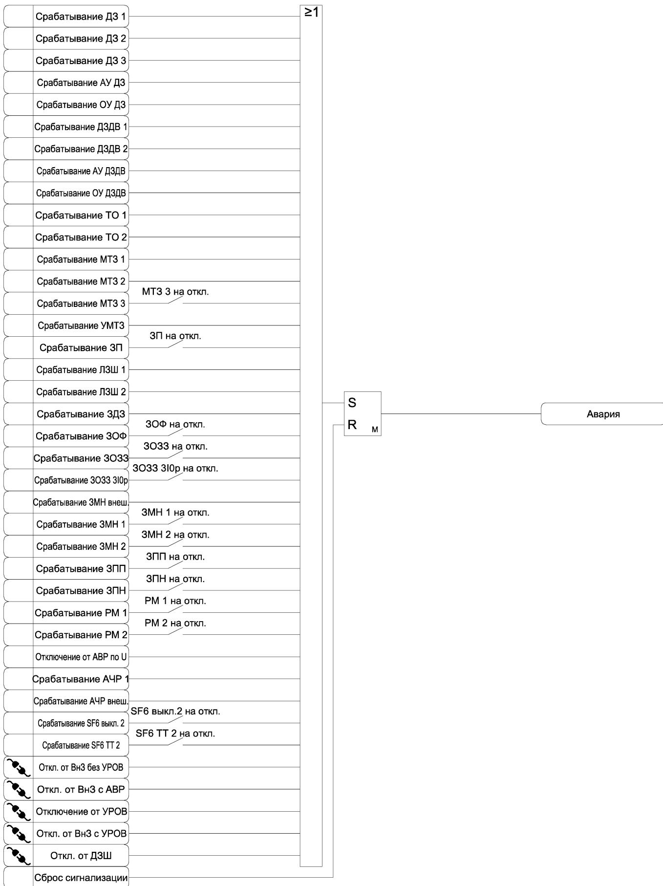
Рисунок 3.46 б) – Функциональная схема алгоритма сигнализации
