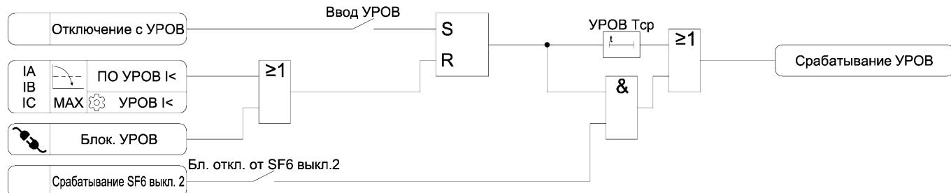
Рисунок 3.28 – Функциональная схема алгоритма УРОВ
