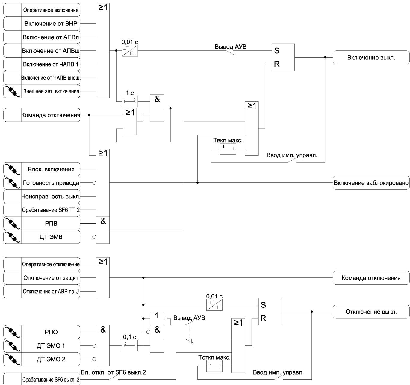
Рисунок 3.42 – Функциональная схема алгоритма управления выключателем
