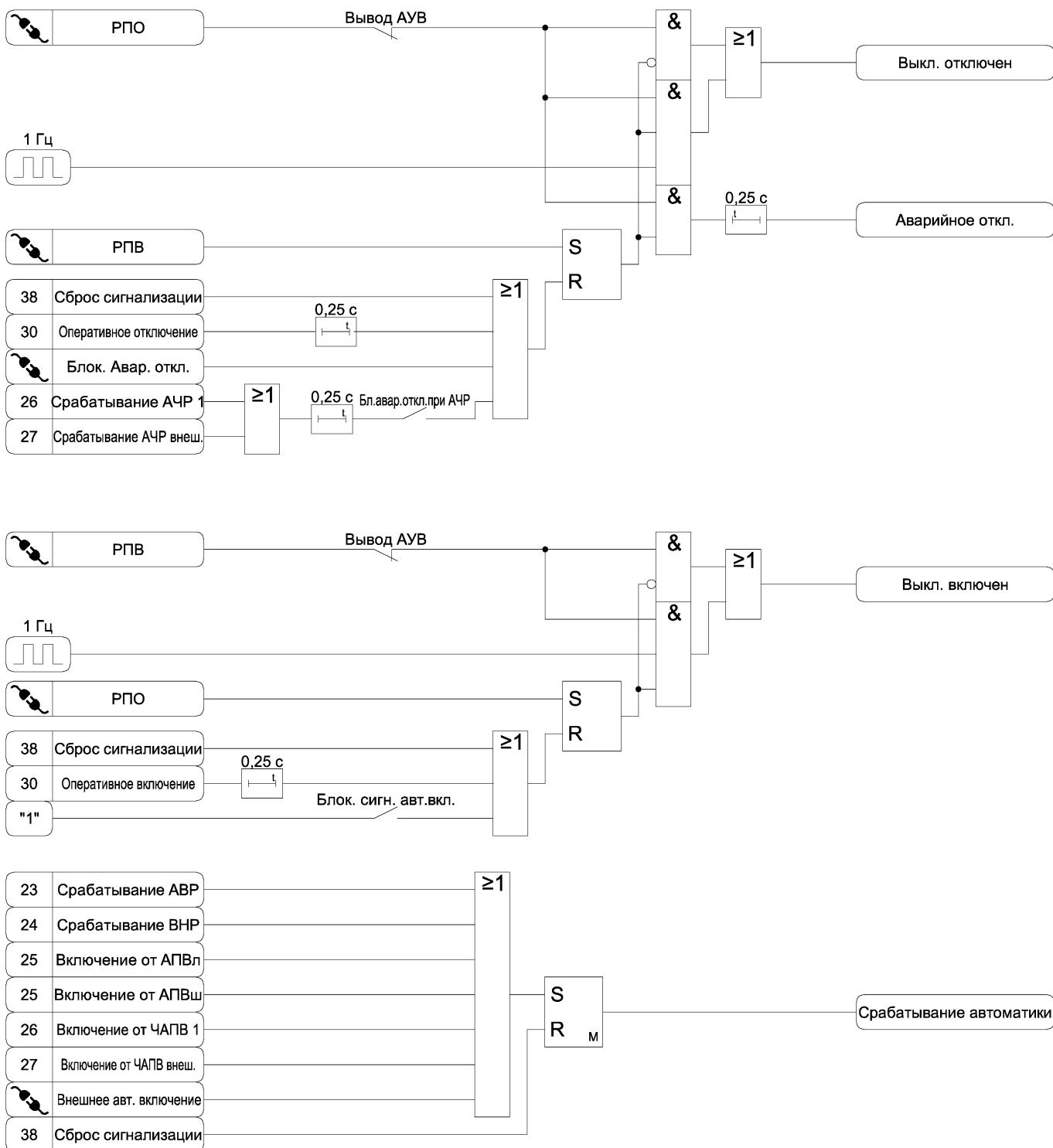
Рисунок А.37 а) – Функциональная схема алгоритма сигнализации
