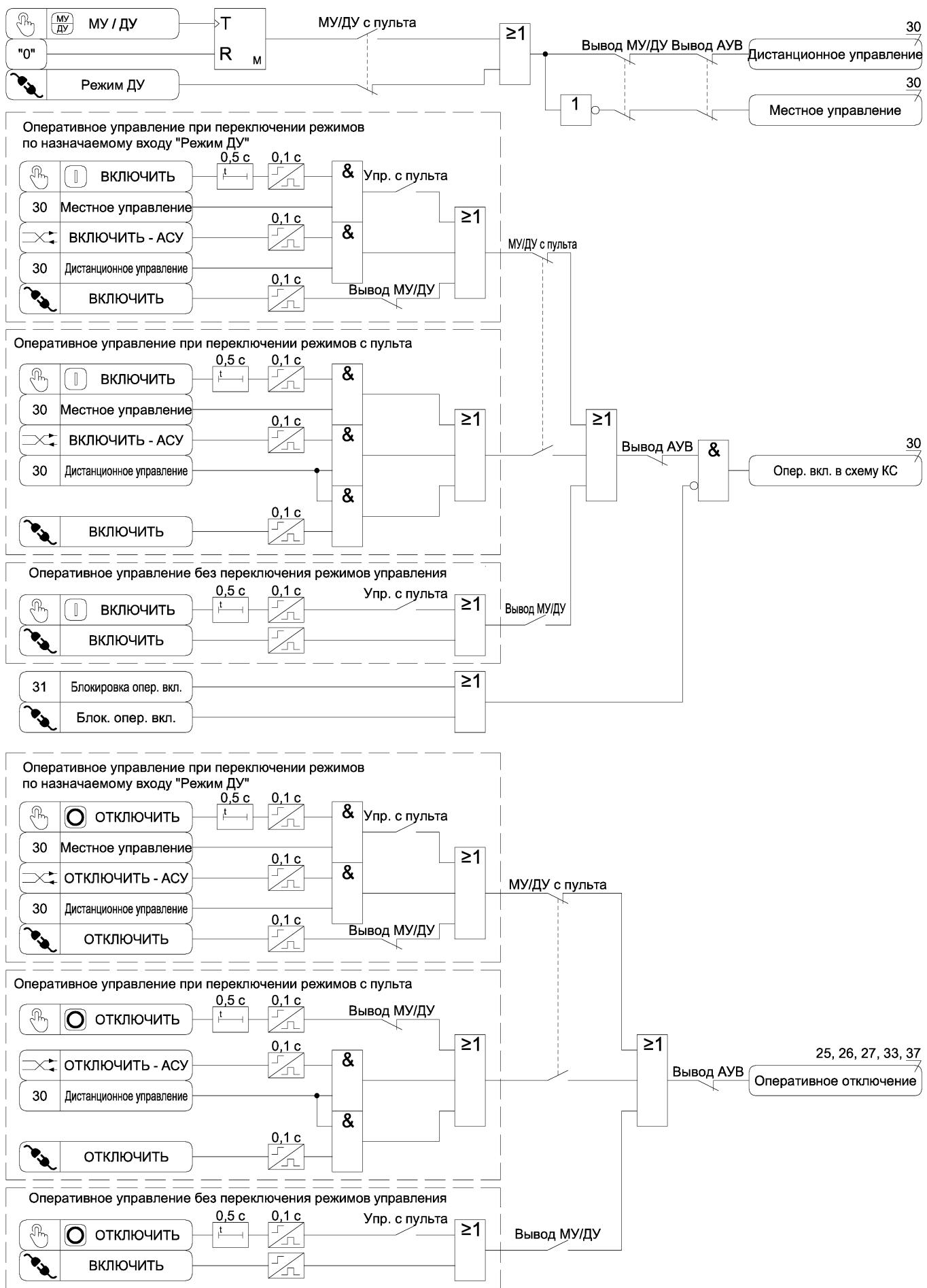
Рисунок А.30 а) – Функциональная схема алгоритма оперативного управления выключателем
