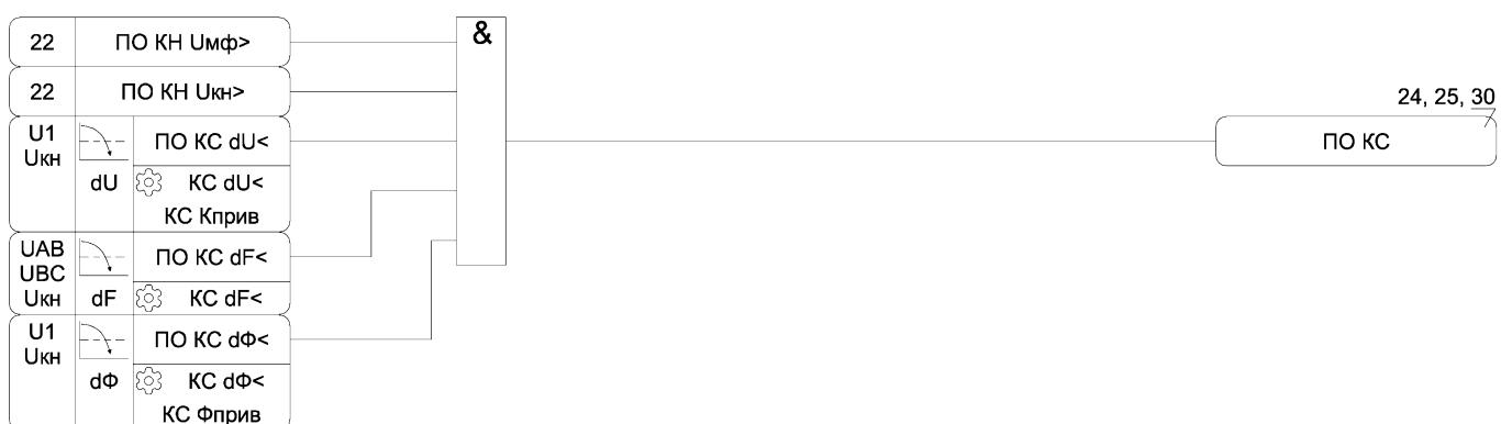
Рисунок А.22 – Функциональная схема алгоритма КН и КС
