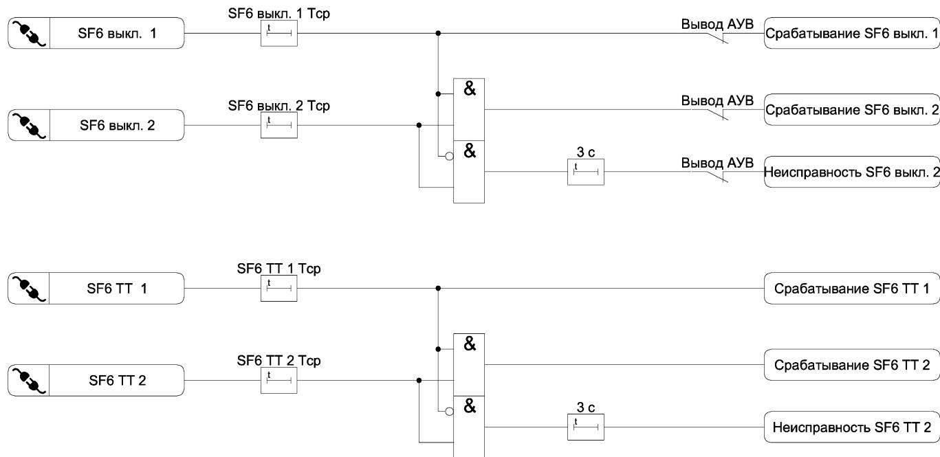
Рисунок 3.38 – Функциональная схема алгоритма защиты от снижения давления элегаза
