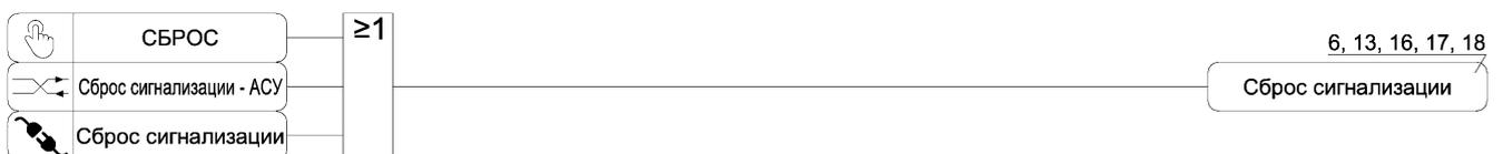
Рисунок А.19 – Функциональная схема алгоритма сброса сигнализации
