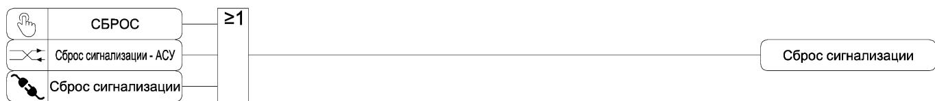
Рисунок 3.36 – Функциональная схема алгоритма сброса сигнализации
