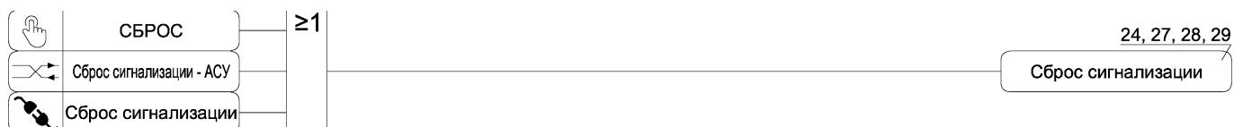
Рисунок А.30 – Функциональная схема алгоритма сброса сигнализации
